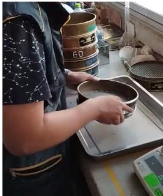
Fig. 5. Tamices para el ensayo granulométrico
