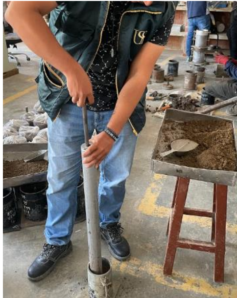
Fig. 7. Ensayo de Proctor modificado
