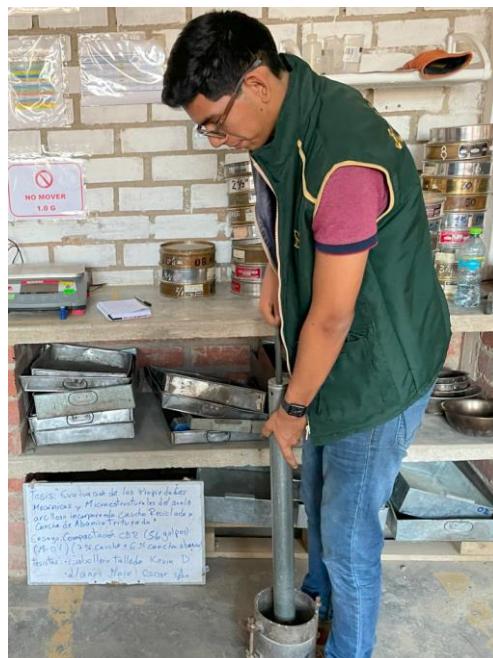
Fig. 8. Ensayo de CBR
