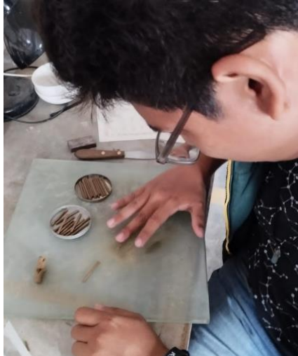
Fig. 6. Ensayo de limite plástico y limite líquido
