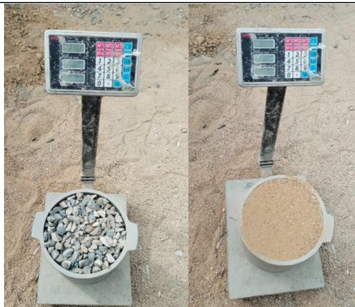
Fig. 20. Ensayo de peso unitario suelto y compactado de los agregados pétreos.
