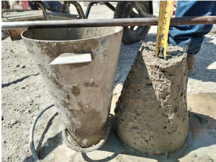
Fig. 28. Medición del asentamiento con el cono de Abrams
