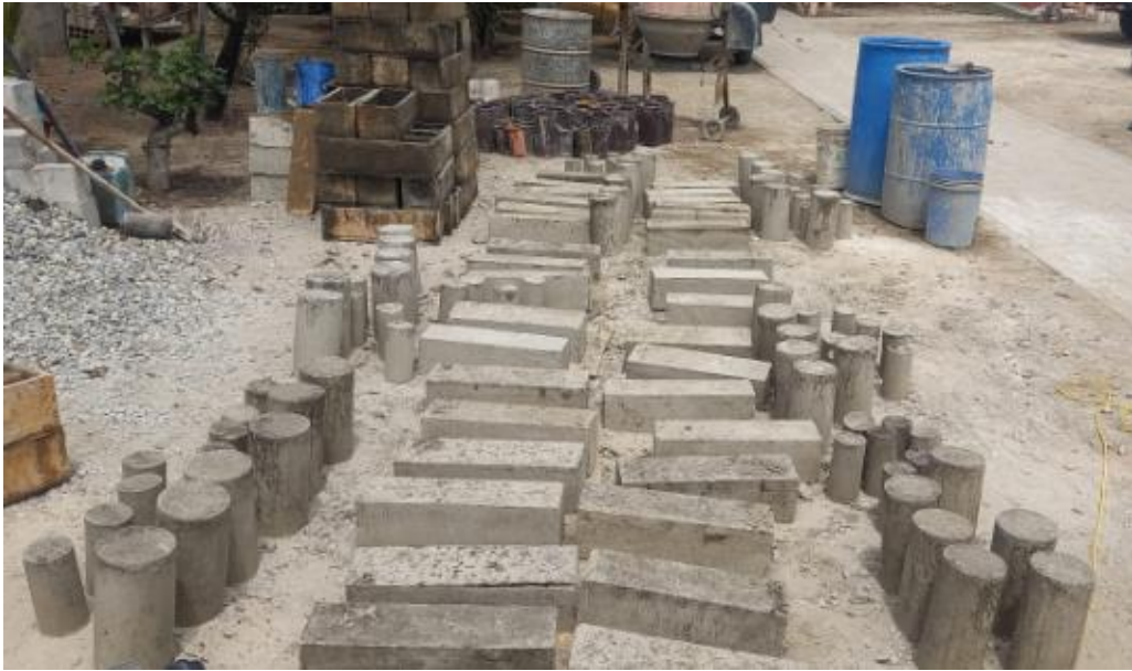
Fig. 34. Desencofrado de muestras.
