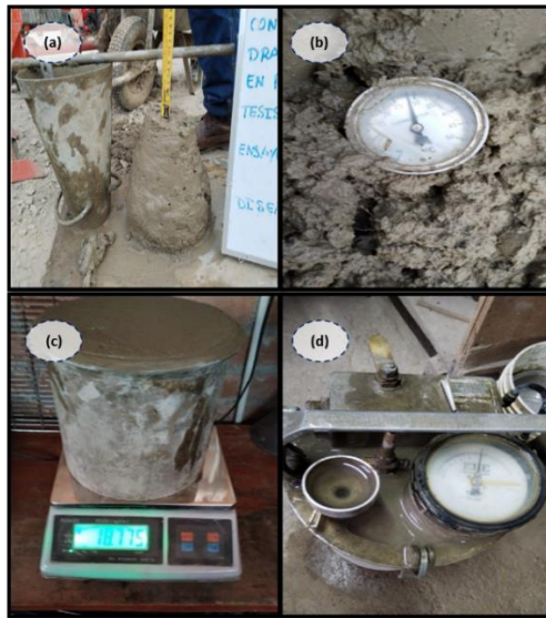
Fig. 26. Propiedades físicas del concreto, (a) trabajabilidad, (b) temperatura, (c) peso unitario y (d) contenido de aire
