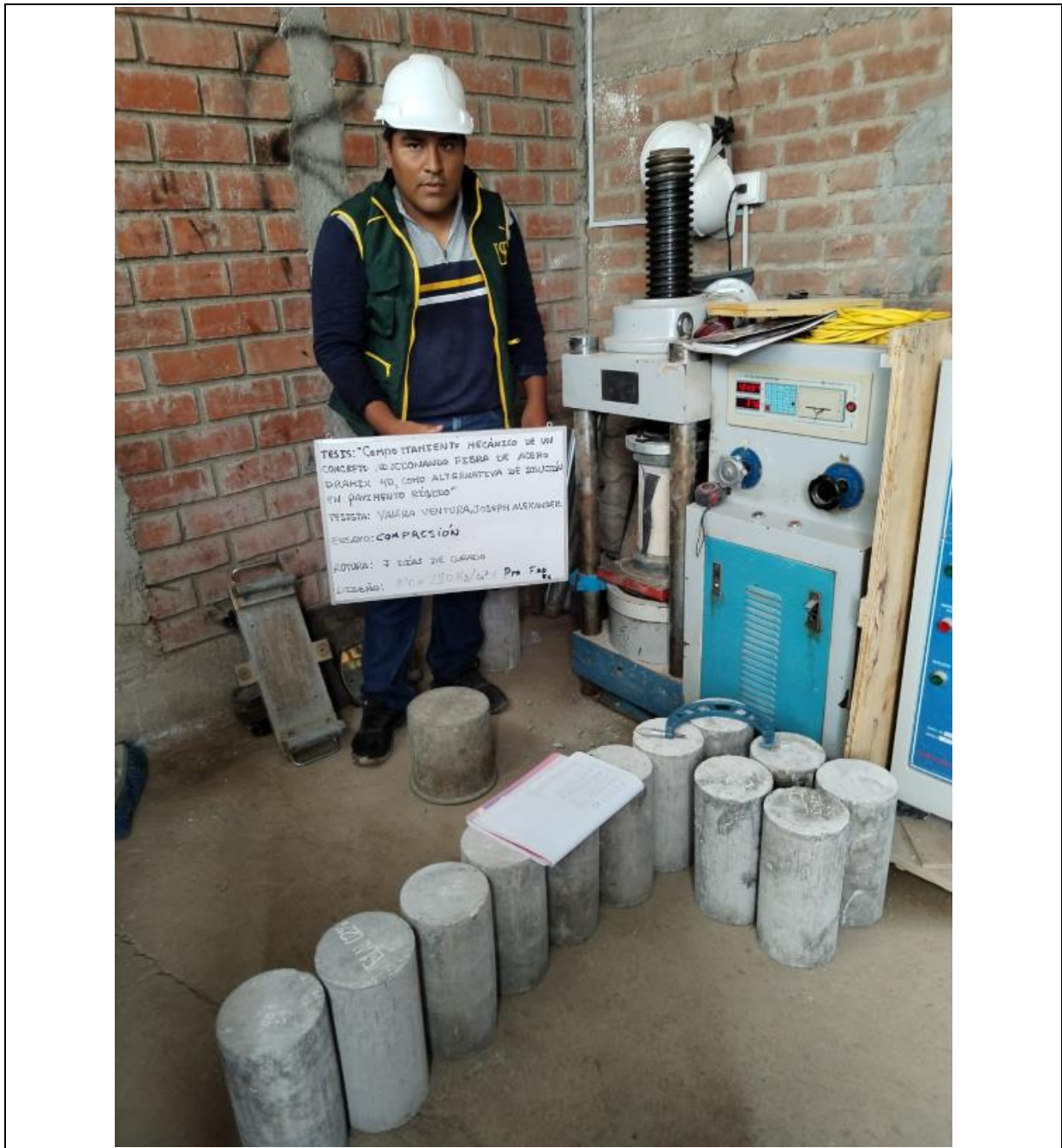
Fig. 38. Ensayo de Resistencia a la compresión para el concreto patrón y dosificado con fibra DRamix 4D
