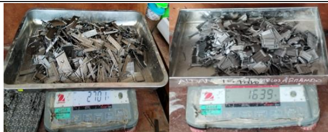
Fig. 18. Fibras de acero Dramix 65/60 y 80/60
