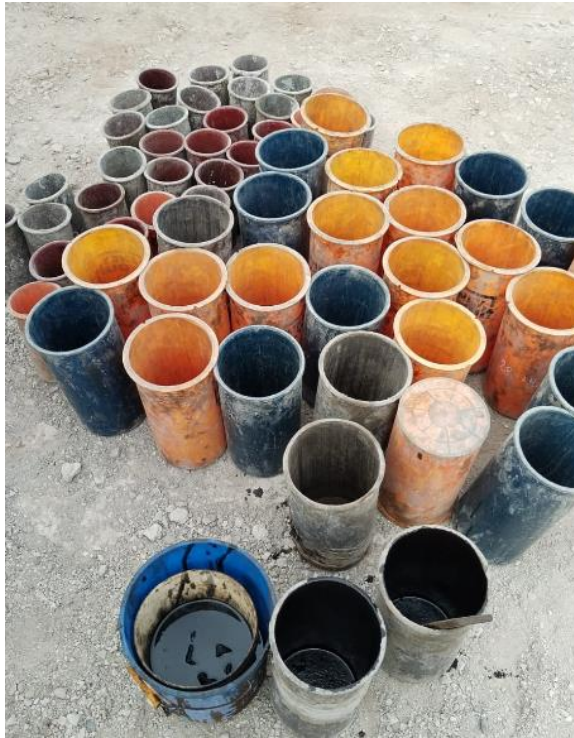
Fig. 23- Moldes cilindricos para la fabricación de especímenes de ensayo de tracción y compresión.
