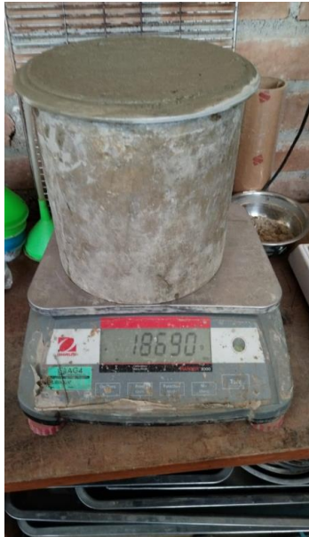
Fig. 30. Ensayo de peso unitario para el concreto patrón y dosificado con fibra de acero Dramix 4D
