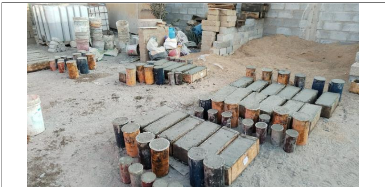
Fig. 33. Realización de probetas y vigas
