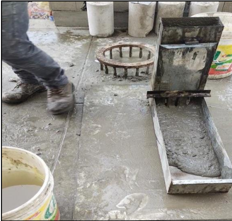
Figura 24: Resultados del ensayo practico de la caja en "L"
