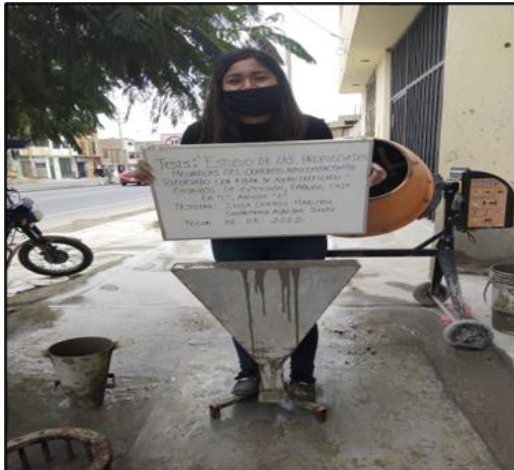
Figura 25: Resultado del ensayo práctico del embudo “V”
