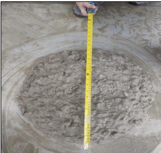
Figura 22: Resultados del ensayo practico de Flujo de Cono
