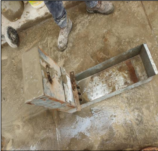
Figura 20: Resultados del ensayo practico de la caja "L"
