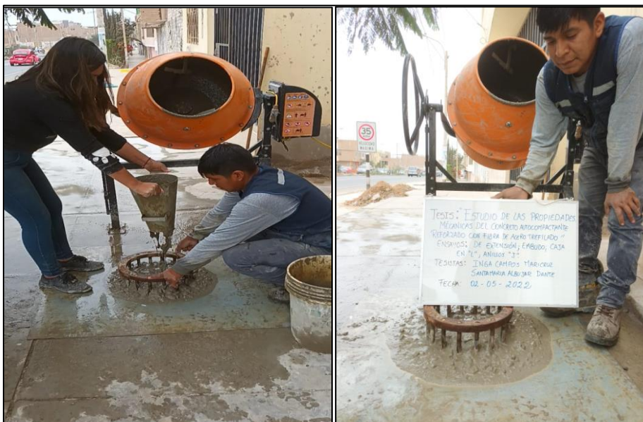
Figura 19: Resultados del ensayo practico del Anillo "J"
