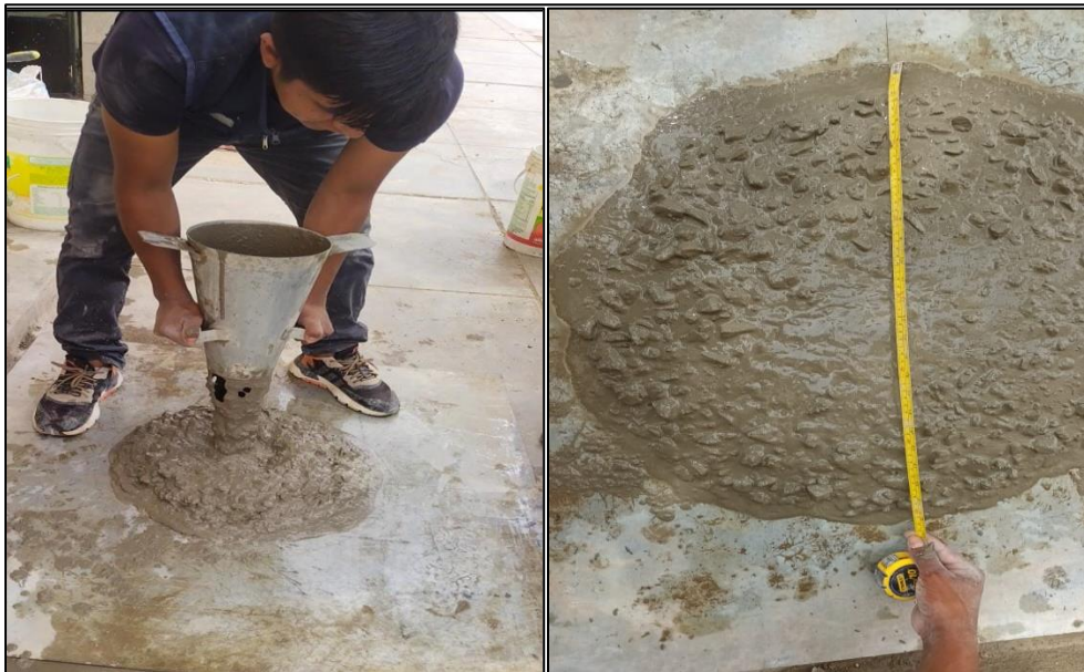
Figura 18: Resultados del ensayo practico de Flujo de Cono
