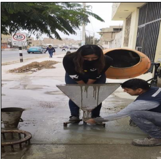
Figura 21: Resultados del ensayo práctico del embudo "V"
