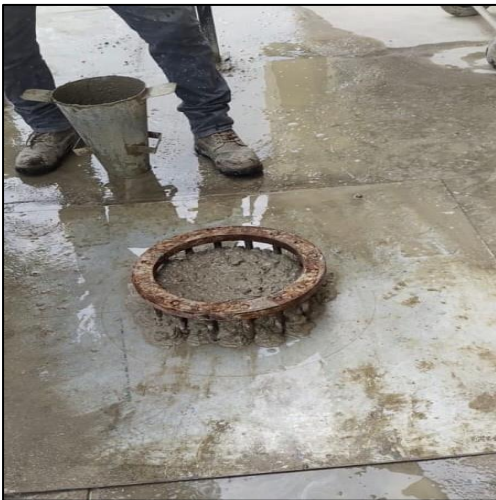
Figura 23: Resultados del ensayo practico del Anillo J
