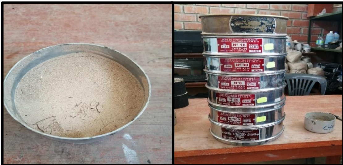
Figura 2. Material que será pasado por las mallas
