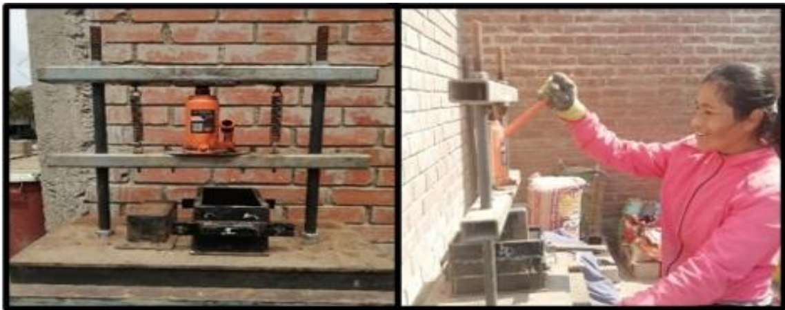
Figura 8. Modelo de la máquina para comprimir los ladrillos de tierra.
