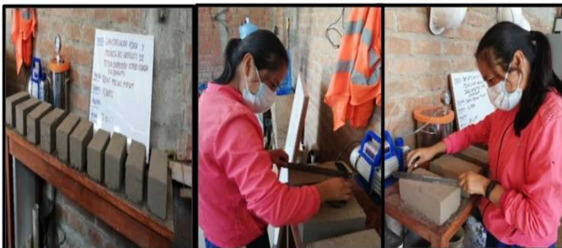
Figura 11. Ensayo de alabeo de los ladrillos
