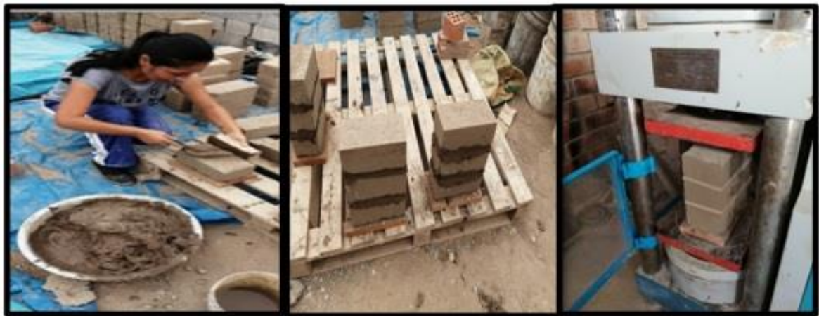
Figura 16. Pilas considerando 3 hileras
