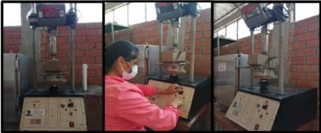
Figura 14. Ensayo de resistencia a la flexión de los especímenes
