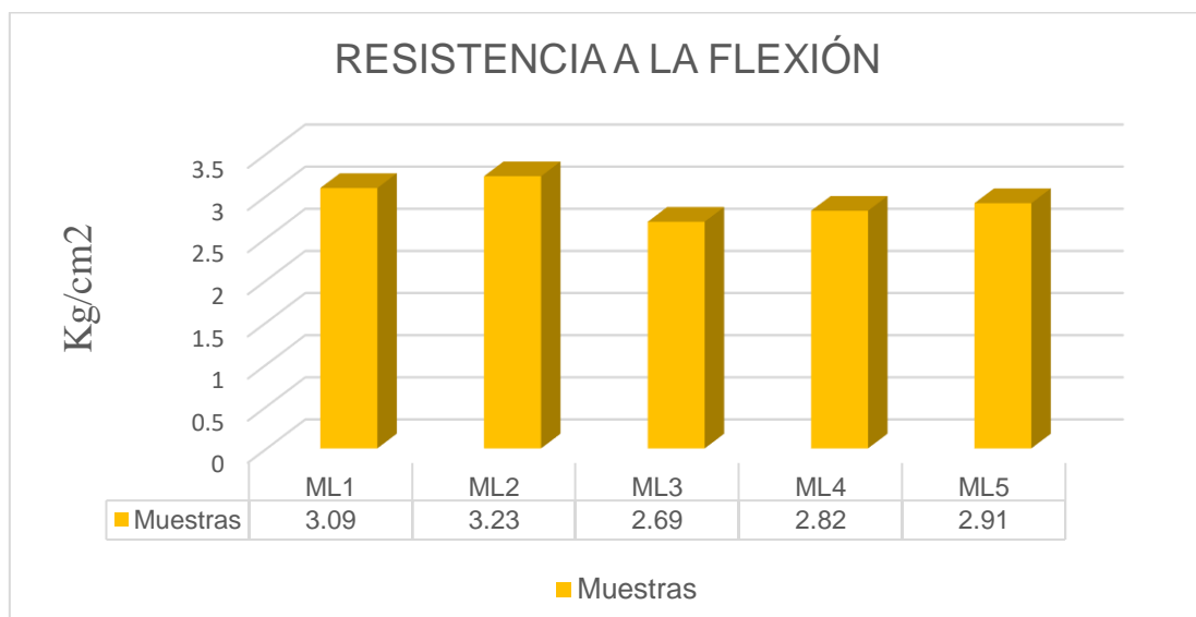
Figura 31. Ensayo de resistencia a la flexión de los ladrillos con 0% de cemento
