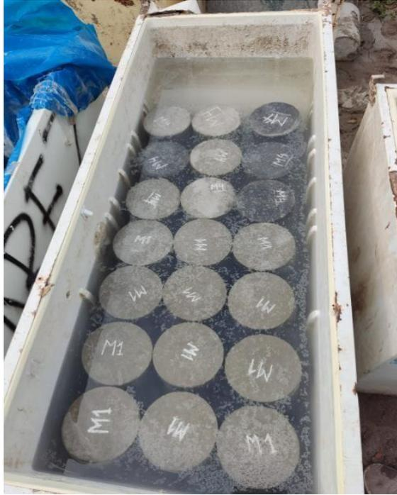
**Foto 7** Vaciado y curado de especímenes cilíndricos
