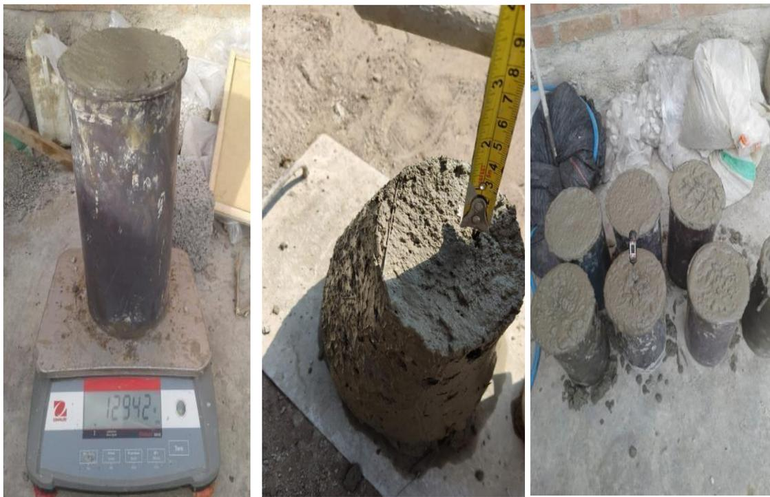
**Foto 6** Peso Unitario, asentamiento, Temperatura de los especímenes
