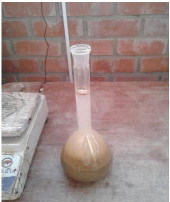
**Foto 4** Ensayo de consistencia y peso específico del agregado fino
