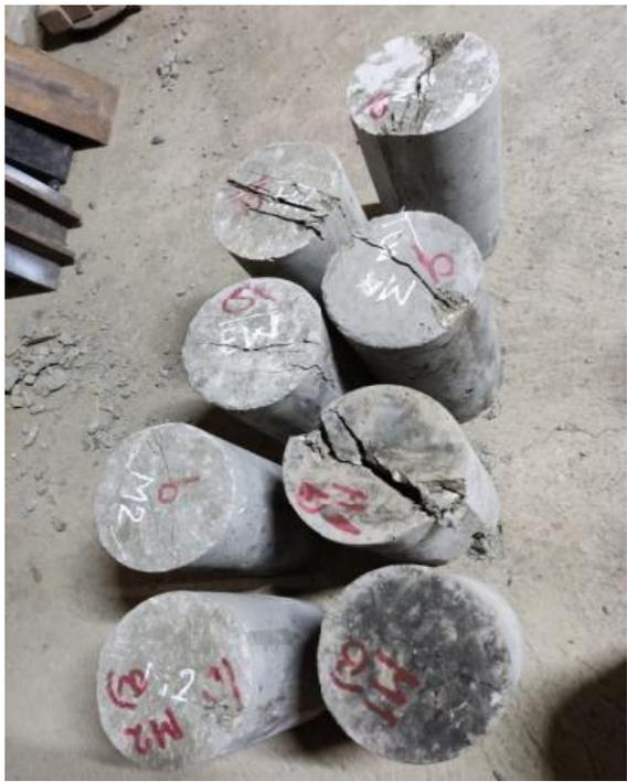
**Foto 9** Ensayo de compresión y rotura de probetas de los especímenes cilíndricos
