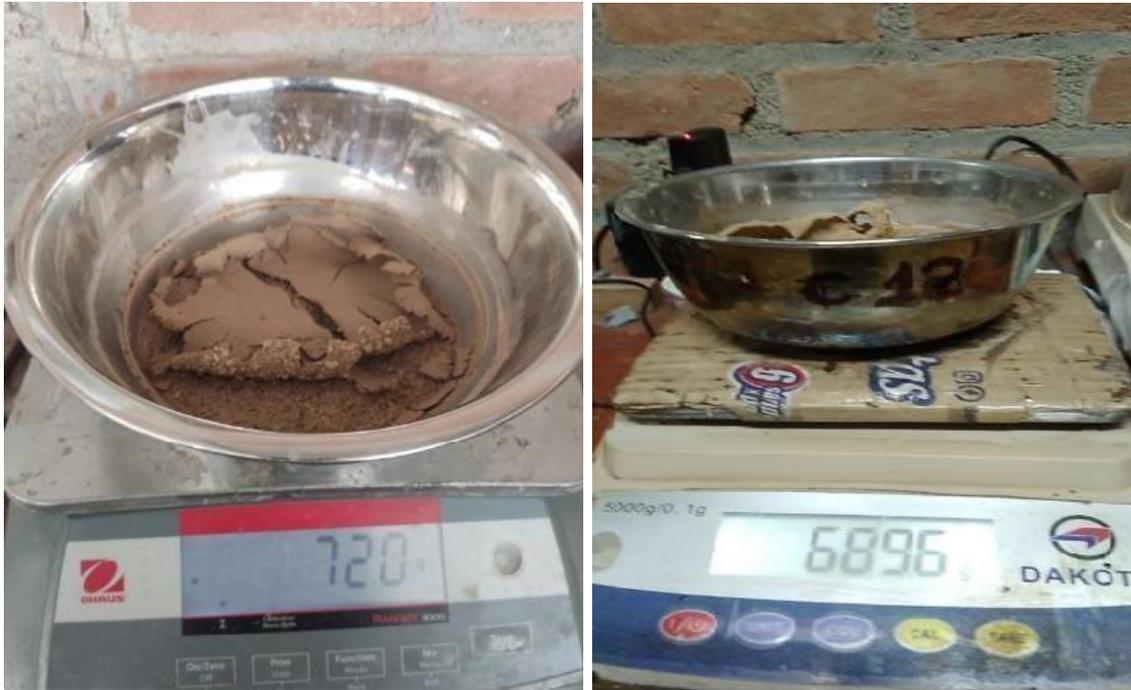
**Foto 5** Ensayo del contenido de humedad del agregado fino
