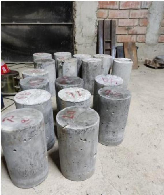
**Foto 8** Preparación de los especímenes para el ensayo compresivo
