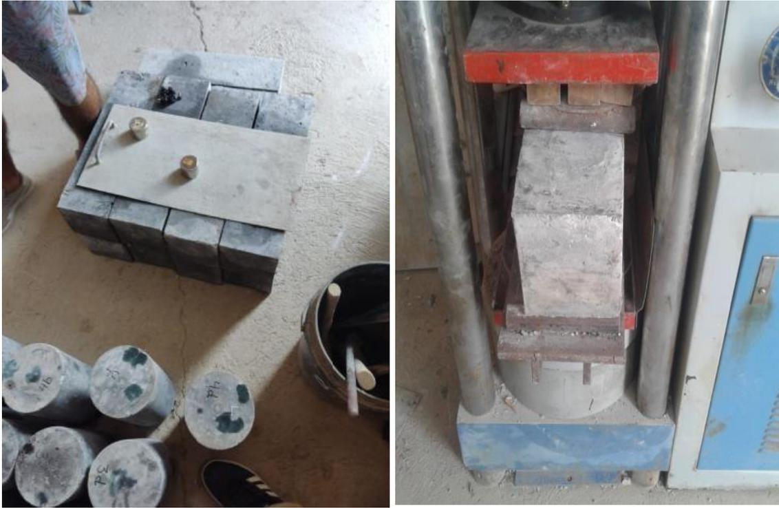
Foto 11 Ensayo a flexión de los especímenes prismáticos
