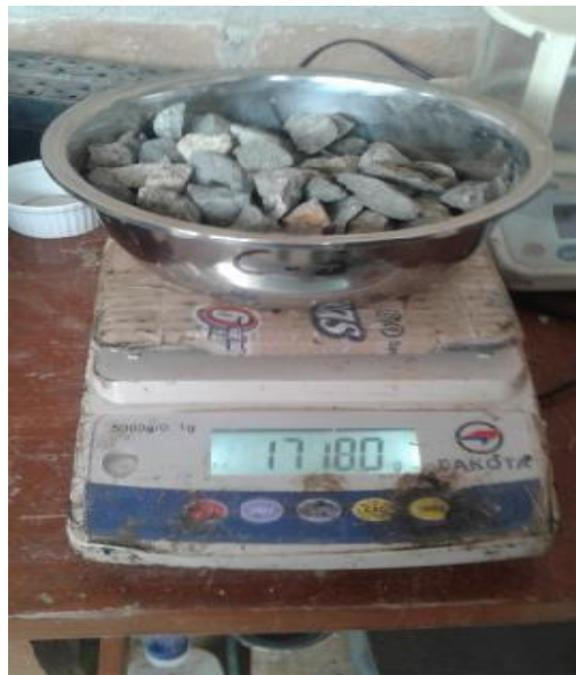
**Foto 3** Pesaje de los agregados para el ensayo granulométrico
