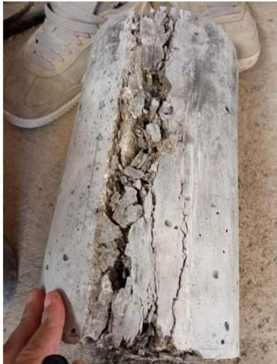
**Foto 10** Ensayo a tracción diametral de los especímenes
