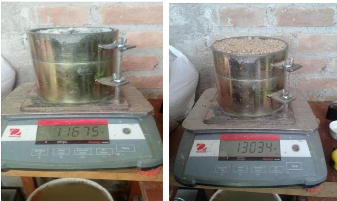
**Foto 2** Ensayo Peso Unitario compactado de los agregados
