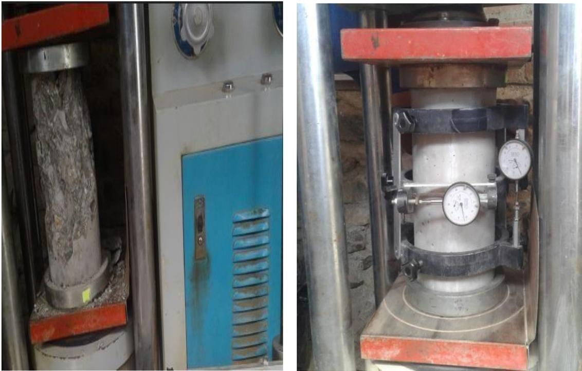
**Foto 12** Ensayo para medición del módulo elástico
