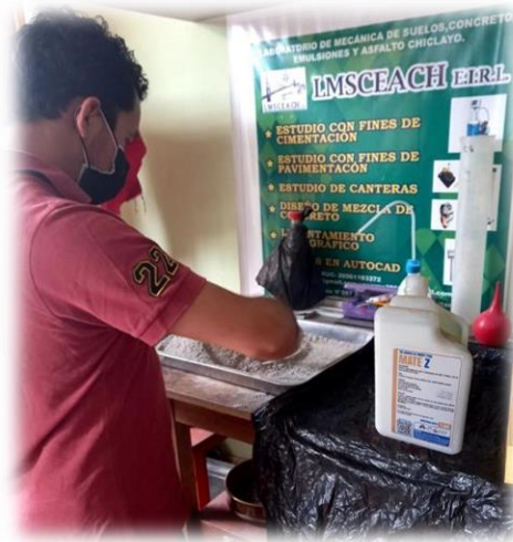
Fig. 13. Mezcla de (aditivo + agua) con cemento y arena
