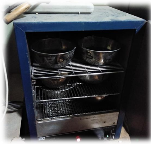
Fig. 5. Puesta al horno de muestra para contenido de humedad Elementos de albañilería (Ladrillos)
