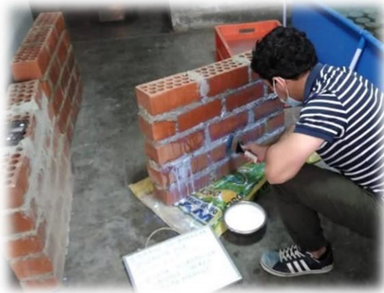
Fig. 11. Aplicación de barrera pasado con brocha (adherencia)
