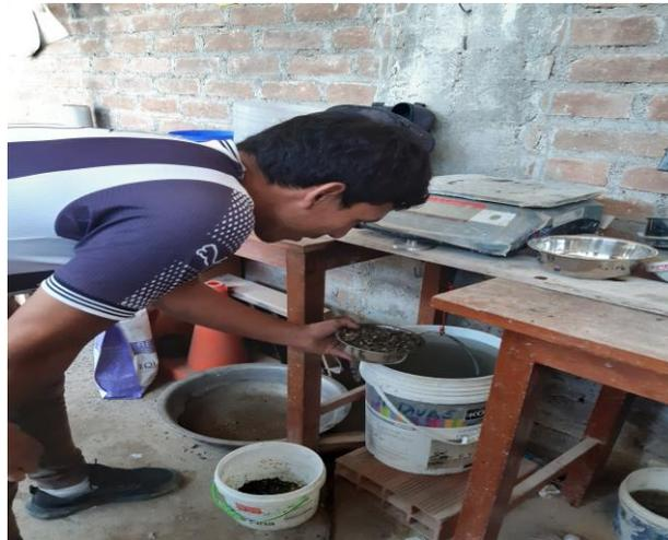
Nota. se realiza el ensayo de peso específico y absorción del confitillo.
