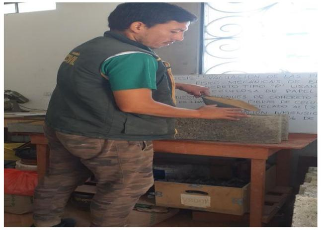
Nota. se realiza el ensayo de porcentaje de vacíos de los bloques.
