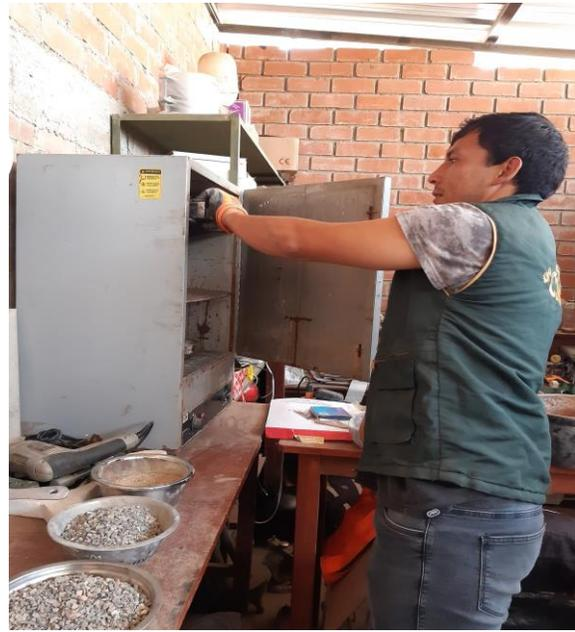
Nota. se realiza el ensayo de contenido de húmedas de los agregados pétreos.
