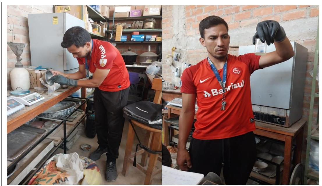
5. Producción de los bloques de concreto Tipo P (bloques patrón y con los porcentajes).
