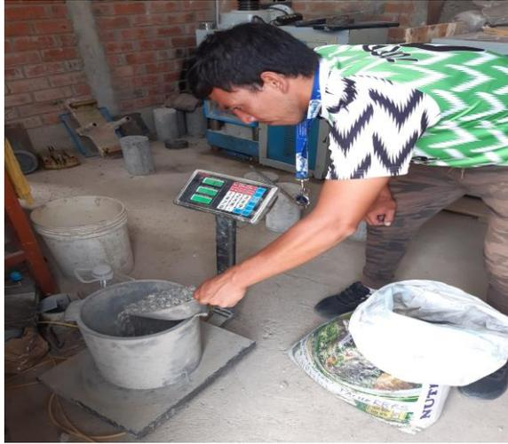
Nota. Se realiza el ensayo de peso unitario suelto y compactado de todos los agregados.
