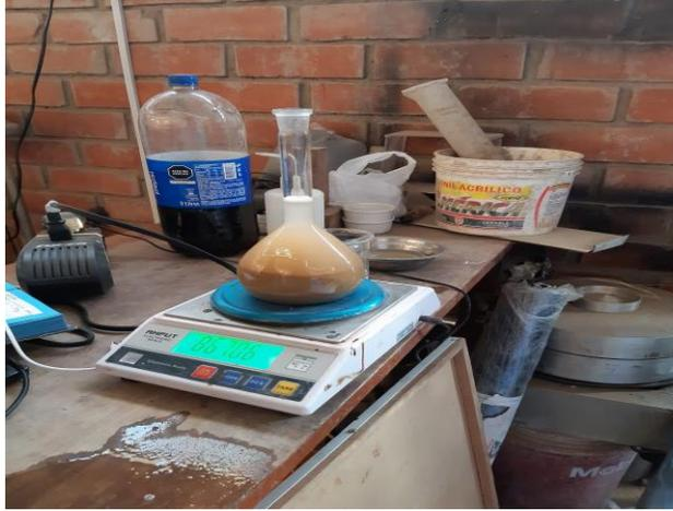
Nota. se realiza el ensayo de peso específico y absorción de la arena.
