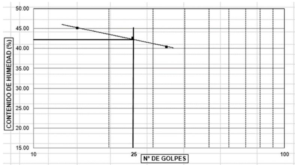
Fig. 4. Límite líquido Cantera 02 - Huaca Pampa El Toro - Tumán - Carretera a Pátapo.
