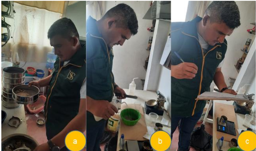
Fotografía 01. (a) Se observa el tamizado de suelo seleccionado de cantera 01 para el análisis granulométrico. (b) Se utiliza la cuchara de Casagrande para determinar el límite líquido del suelo. (c) Registrando los datos de las nuestras muestras de suelos.
