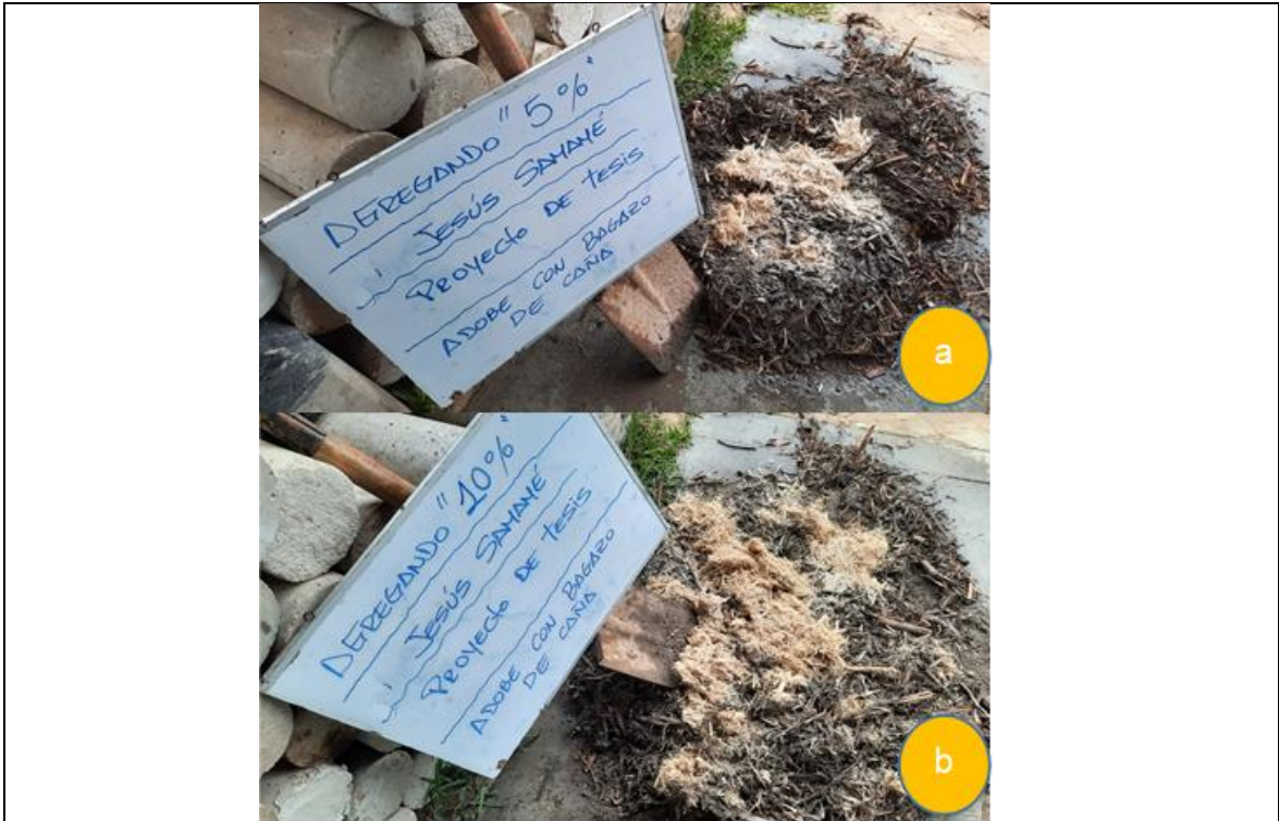
Fotografía 03. (a) Muestra de suelo agregando el 5% de bagazo de caña de azúcar. (b) Muestra de suelo agregando el 10% de bagazo de caña de azúcar
