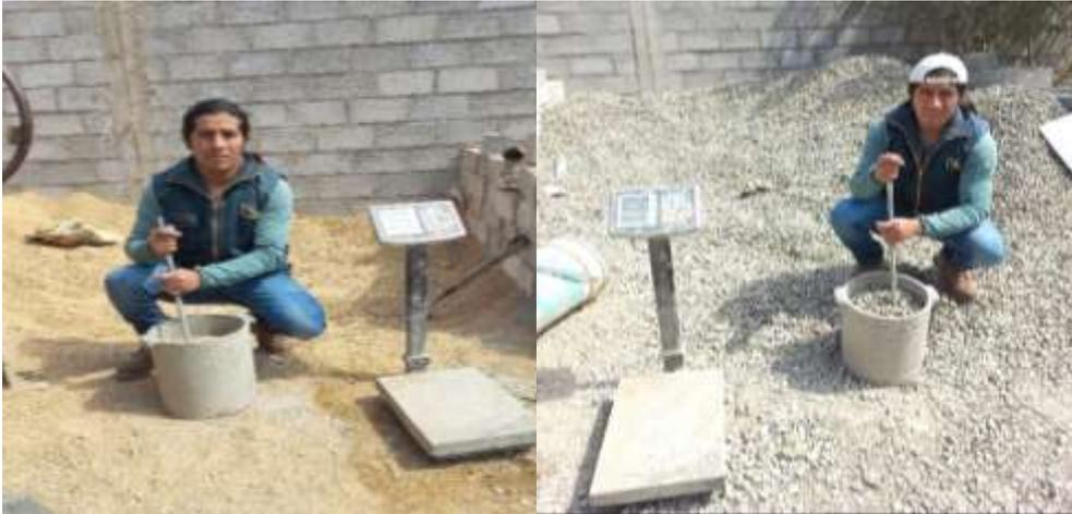
**Fig. 9.** Ensayo Peso unitario suelto y compactado.
