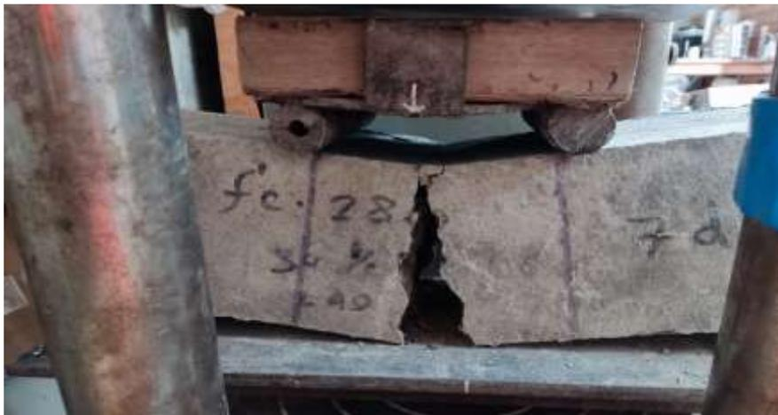
**Fig. 18.** Ensayo a flexión.
