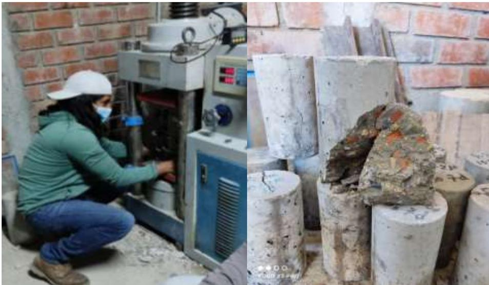
**Fig. 17.** Ensayo a compresión.
