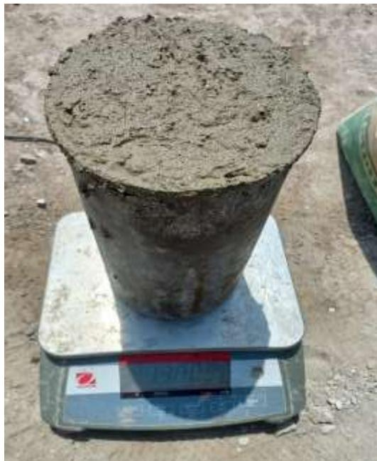
**Fig. 15.** Peso unitario del concreto fresco.
