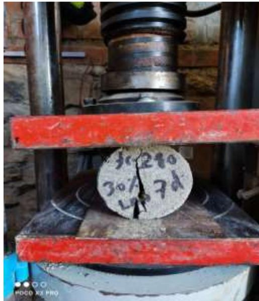
**Fig. 19.** Ensayo a tracción.
