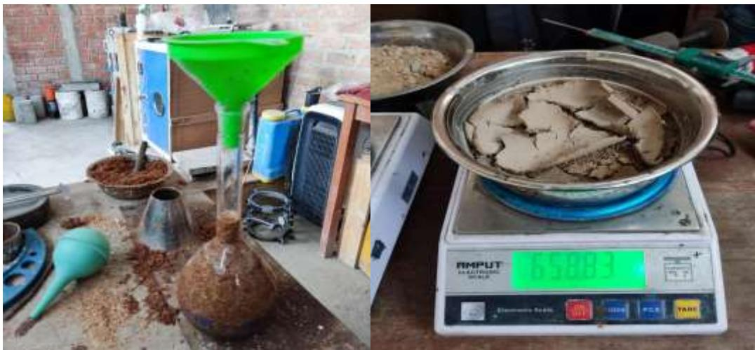
**Fig. 11.** Ensayo de Peso específico y absorción del agregado fino.
