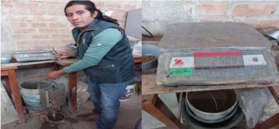
**Fig. 10.** Ensayo Peso específico y absorción de agregado grueso.
