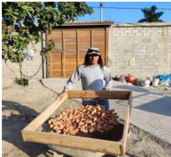
**Fig. 6.** Tamizado del ladrillo triturado.
