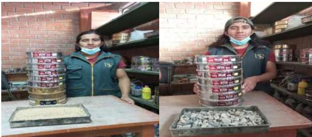
**Fig. 7.** Tamizado del agregado grueso y fino.
