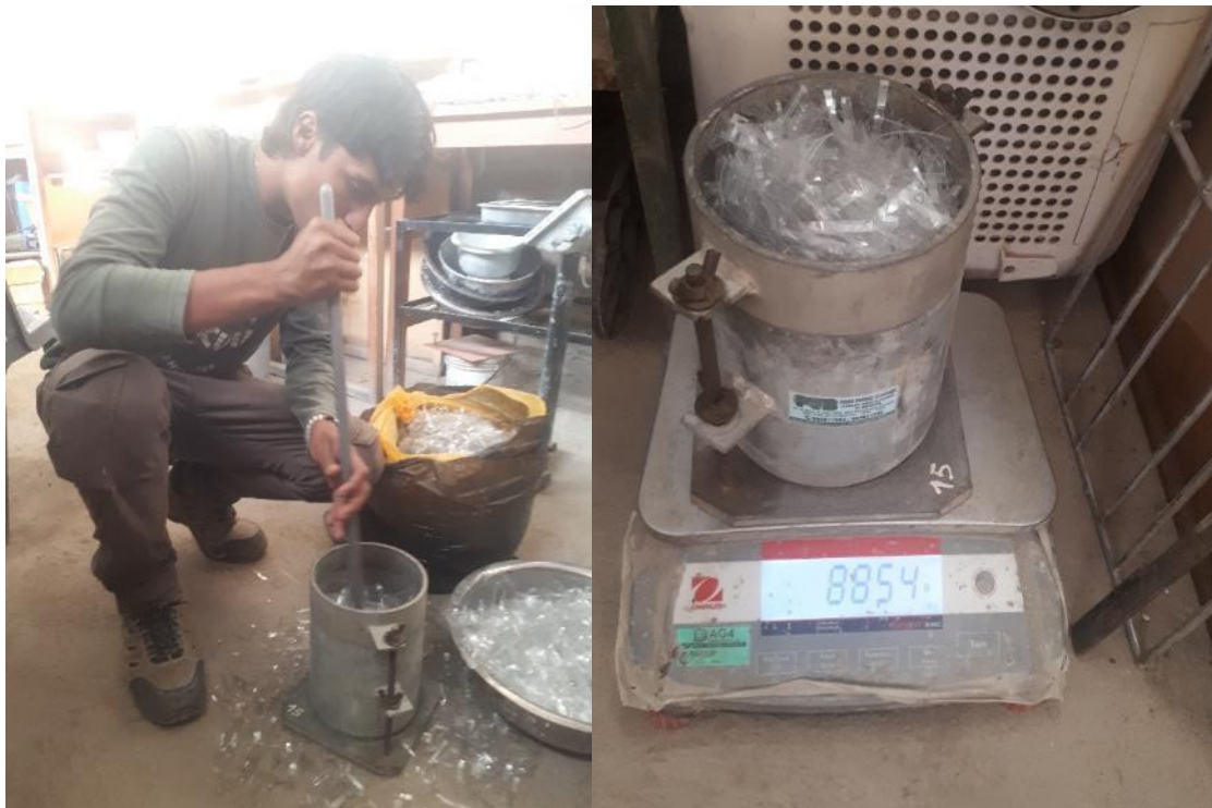
Fig. 86. Peso unitario suelto y compactado del PET reciclado.
