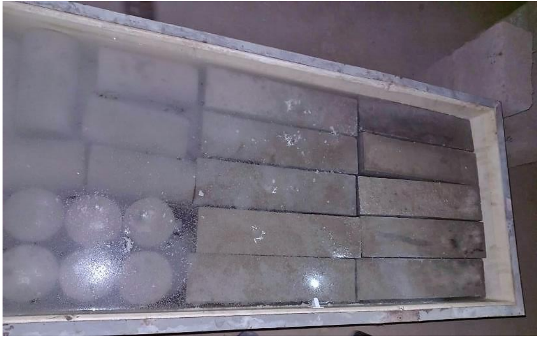
Fig. 97. Curado de cilindros y vigas de concreto.
