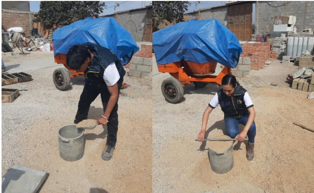
Fig. 76. Ensayo de peso unitario suelto y compactado del agregado fino.
