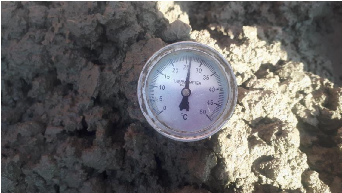
Fig. 93. Ensayo de temperatura del concreto fresco.
