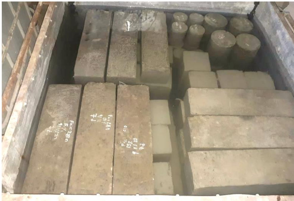
Fig. 106. Curado de cilindros y vigas de concreto.
