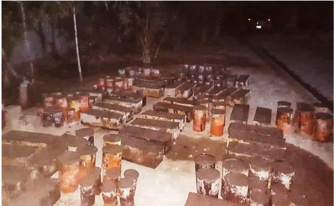
Fig. 95. Vaciado de probetas y vigas.
