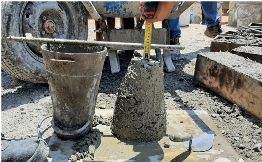
Fig. 100. Ensayo de consistencia del concreto en su estado fresco.
