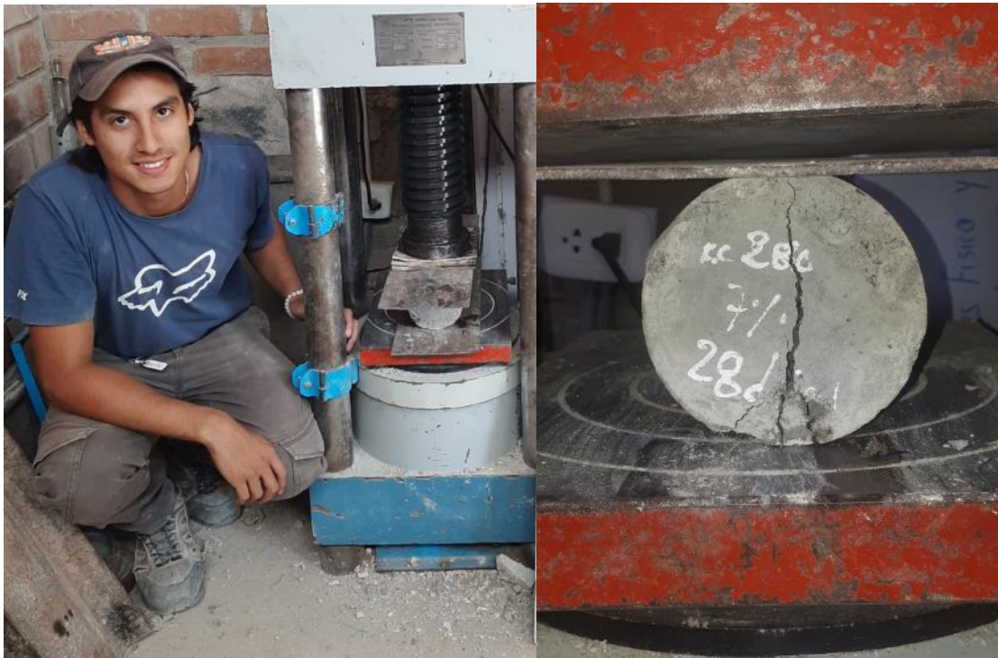
Fig. 110. Ensayo de resistencia a la tracción.
