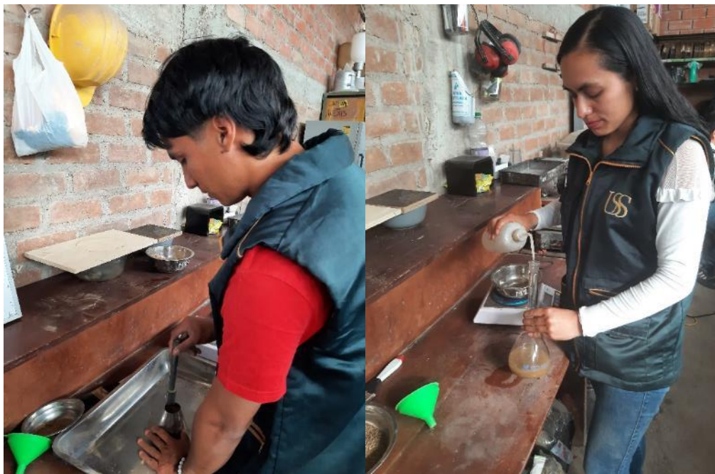
Fig. 77. Ensayo de peso específico y absorción del agregado fino.
