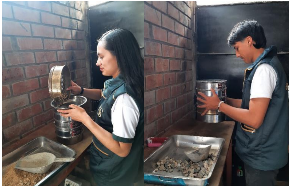
Fig. 74. Ensayo de granulometría de agregado fino y grueso.
