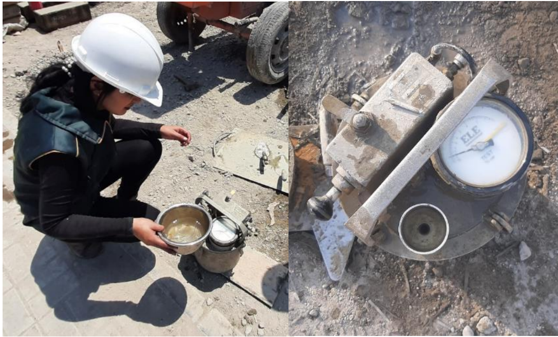
Fig. 103. Ensayo de contenido de aire.
