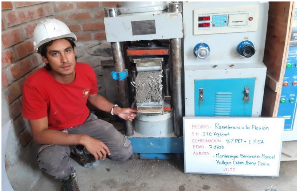
Fig. 113. Ensayo de resistencia flexión.
