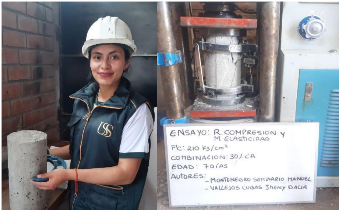
Fig. 109. Ensayo de resistencia a la compresión y módulo de elasticidad.
