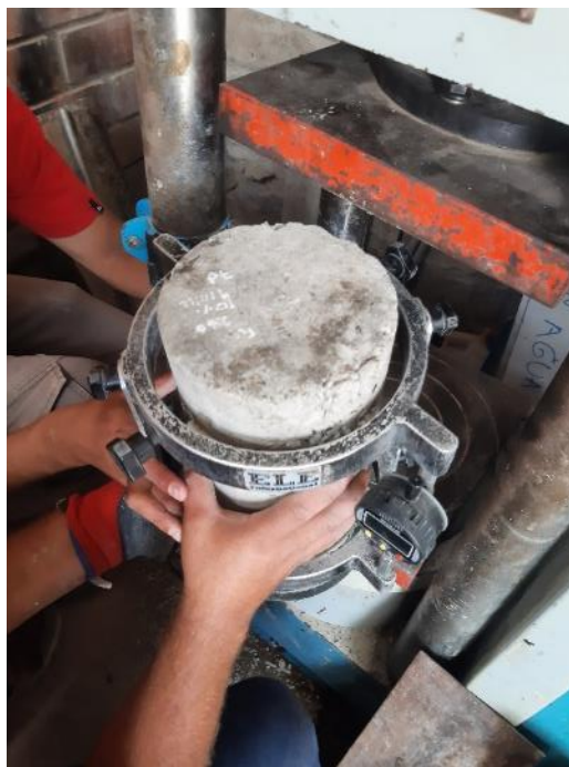
Fig. 112. Ensayo de resistencia a la compresión y módulo de elasticidad.
