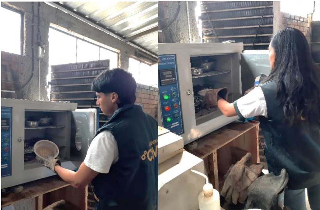
Fig. 79. Ensayo de contenido de humedad del agregado fino y grueso.
