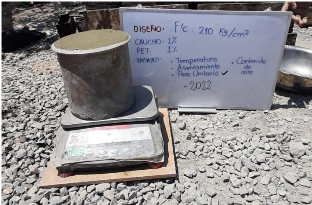
Fig. 101. Ensayo de peso unitario del concreto.
