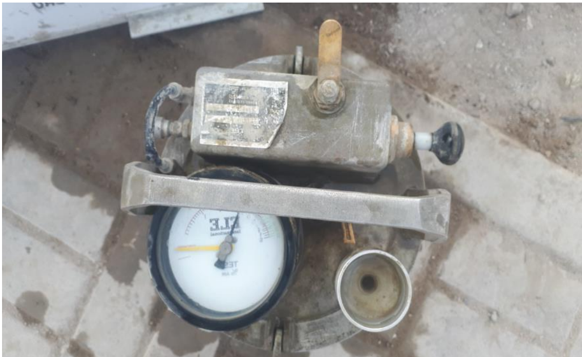
Fig. 94. Ensayo de contenido de aire.
