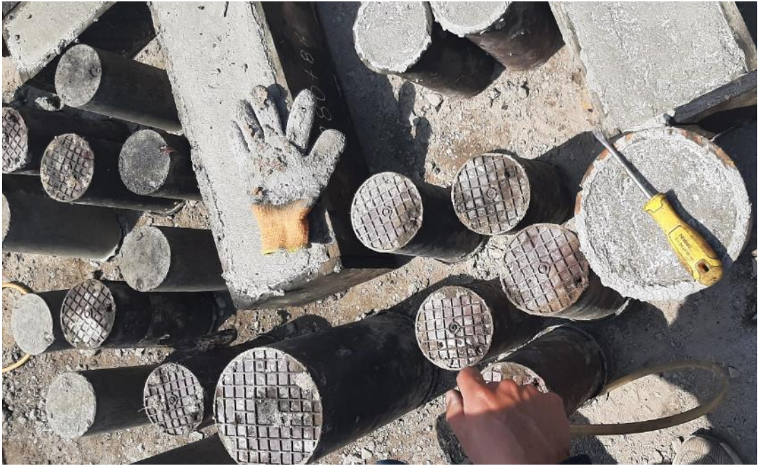
Fig. 105. Desmoldado de los cilindros y vigas de concreto.
