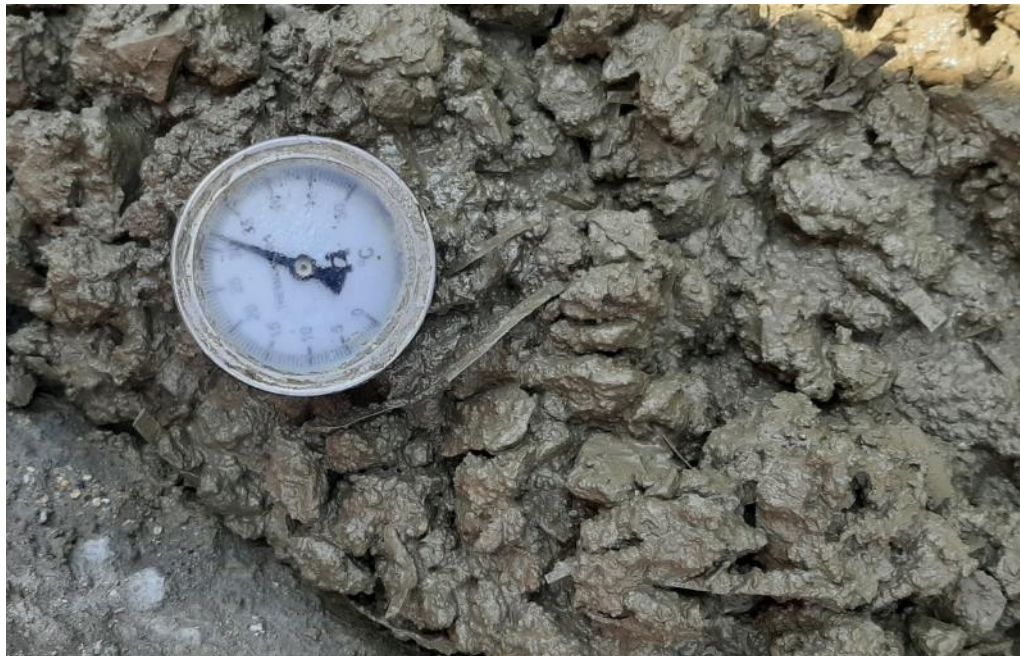
Fig. 102. Ensayo de temperatura del concreto fresco.
