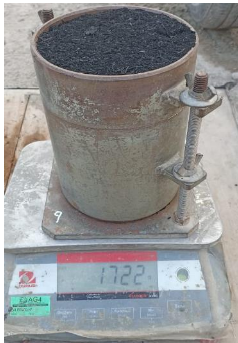
Fig. 83. Peso unitario suelto y compactado del caucho
