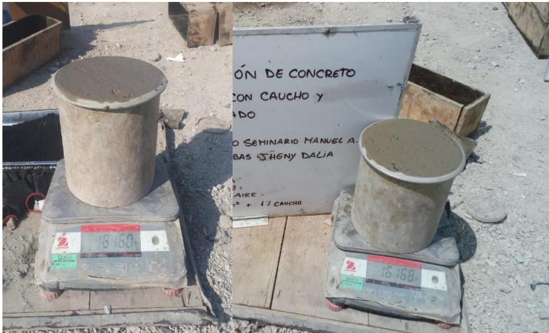
Fig. 92. Ensayo de peso unitario del concreto.
