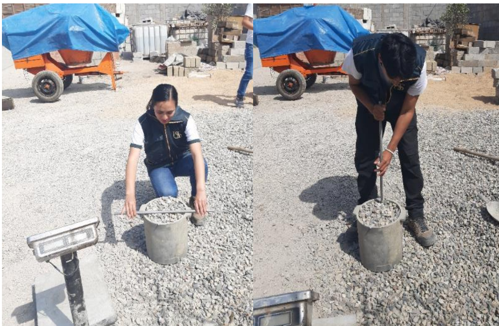
Fig. 75. Ensayo de peso unitario suelto y compactado del agregado grueso.
