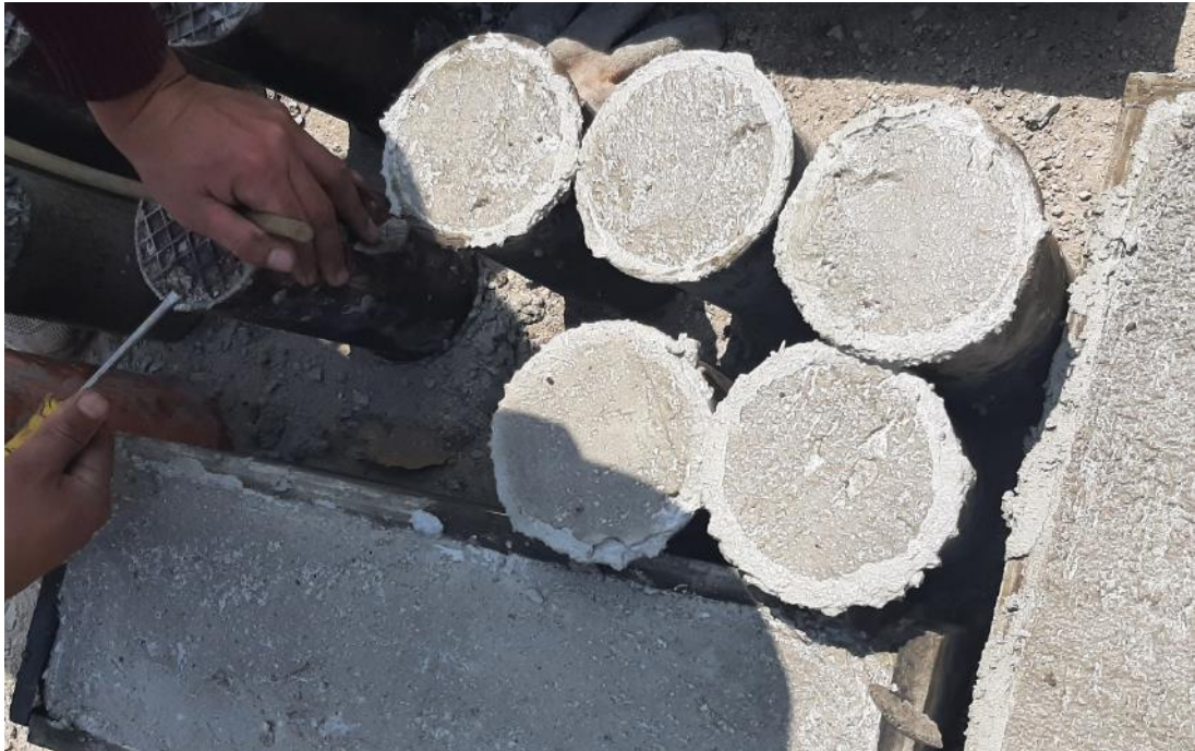
Fig. 96. Desmoldado de los cilindros y vigas de concreto.
