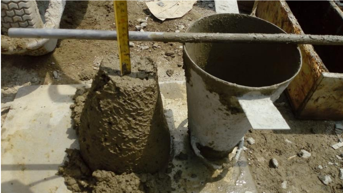
Fig. 91. Ensayo de consistencia del concreto en su estado fresco.
