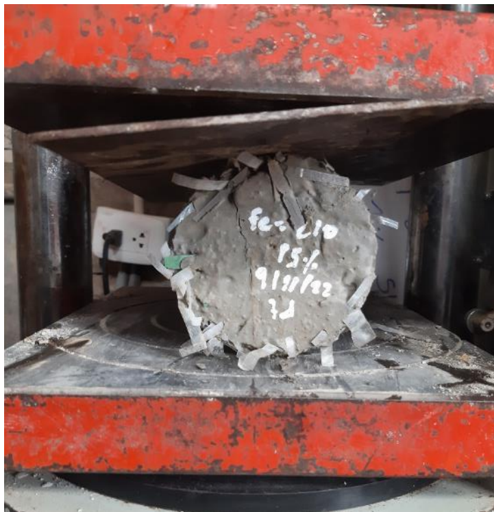
Fig. 114. Ensayo de resistencia a la tracción.
