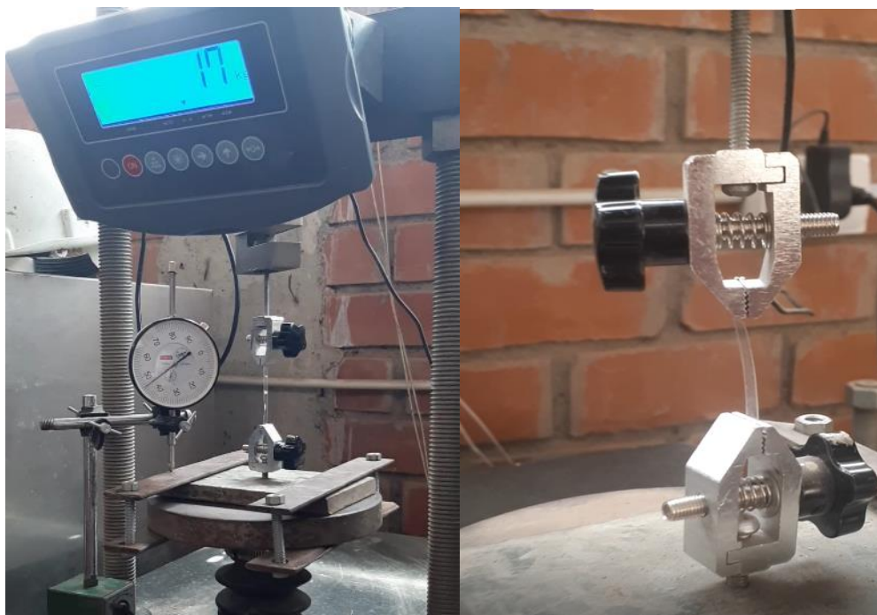
Fig. 87. Tracción de las fibras de PET reciclado.
