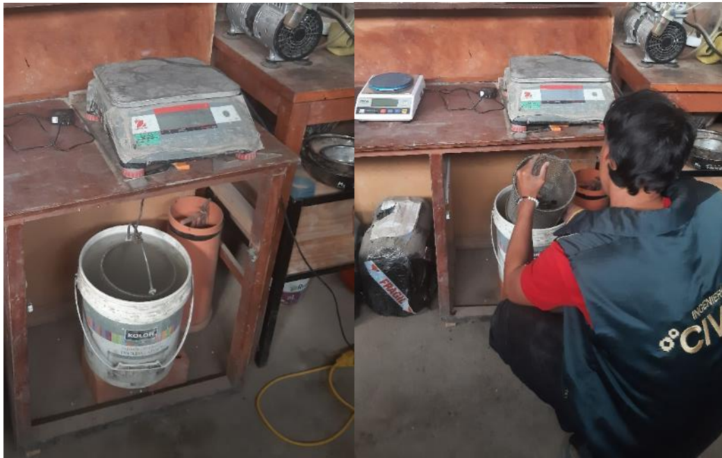
Fig. 78. Ensayo de peso específico y absorción del agregado grueso.
