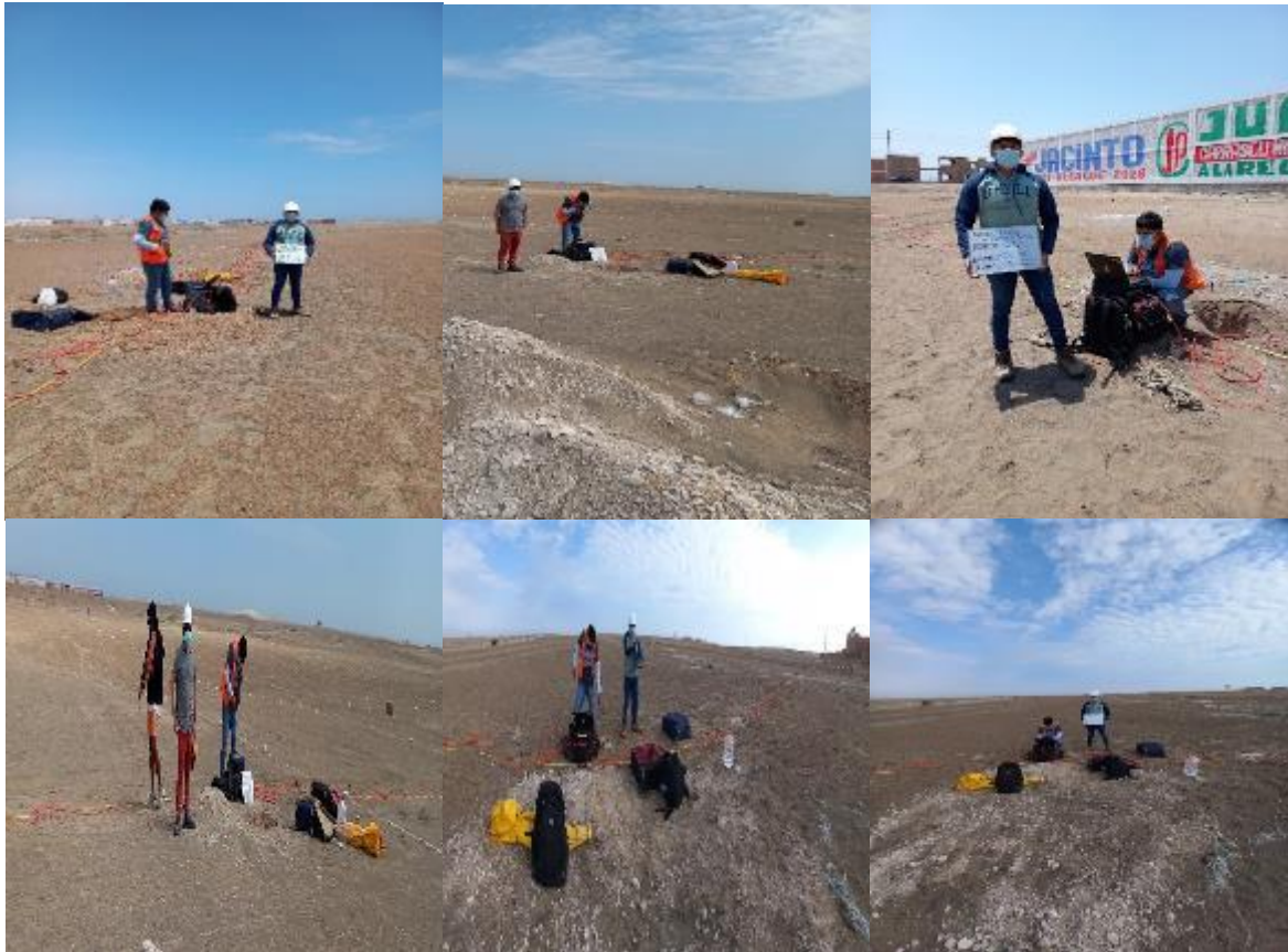
Fig. 20. Ensayo MASW, en Franja Costera Pimentel- Lambayeque- Perú.
