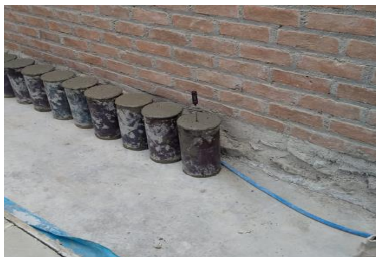
Fig. 13. Peso Unitario del concreto.
