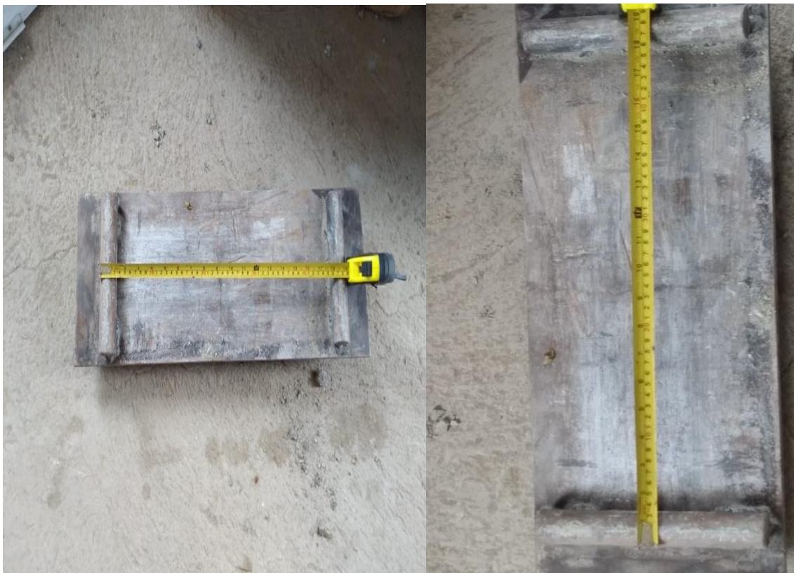
Foto 08: Apoyos para el ensayo de resistencia a flexión
