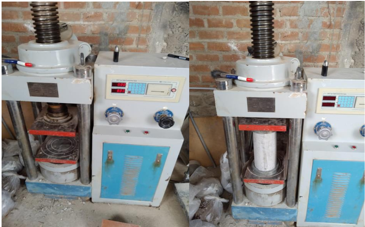
Foto 06: Ensayo de resistencia a la compresión del concreto
