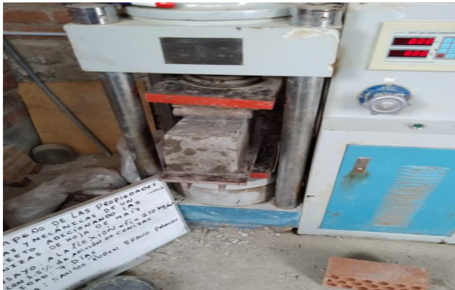
Fig. 16. Resistencia a flexión del concreto.
