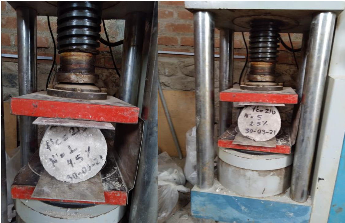
Foto 07: Ensayo de resistencia a tracción del concreto
