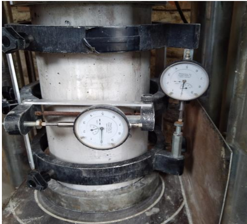
Fig. 17. Módulo de elasticidad del concreto.
