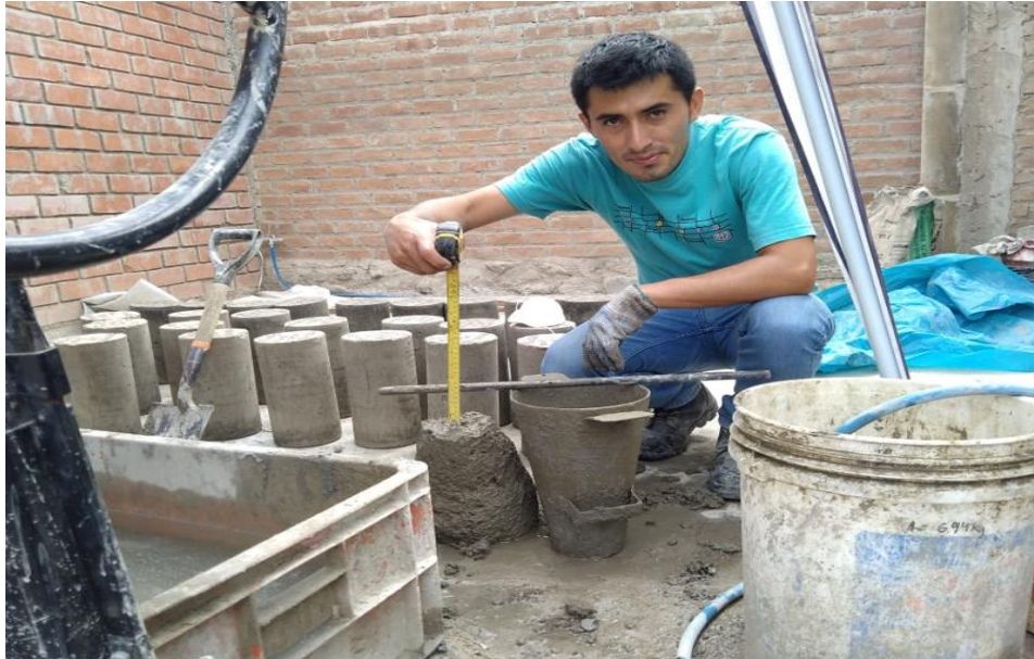
Fig. 11. Ensayo de asentamiento del concreto.
