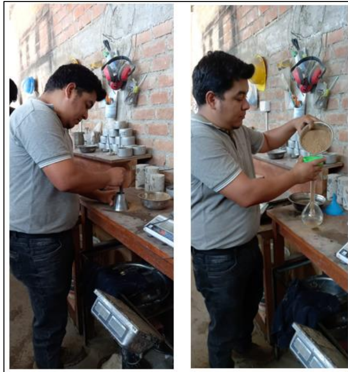
Fig. 23. Ensayo de peso específico y absorción del agregado fino
