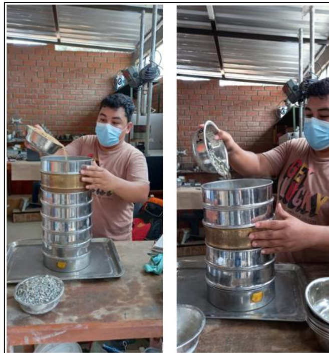
Fig. 22. Ensayo granulométrico de agregado fino y grueso
