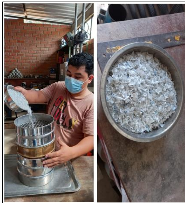
Fig. 26. Preparación de PET, ensayo granulométrico
