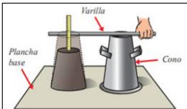
Fig. 2. Prueba de Asentamiento Cono de Abrams
