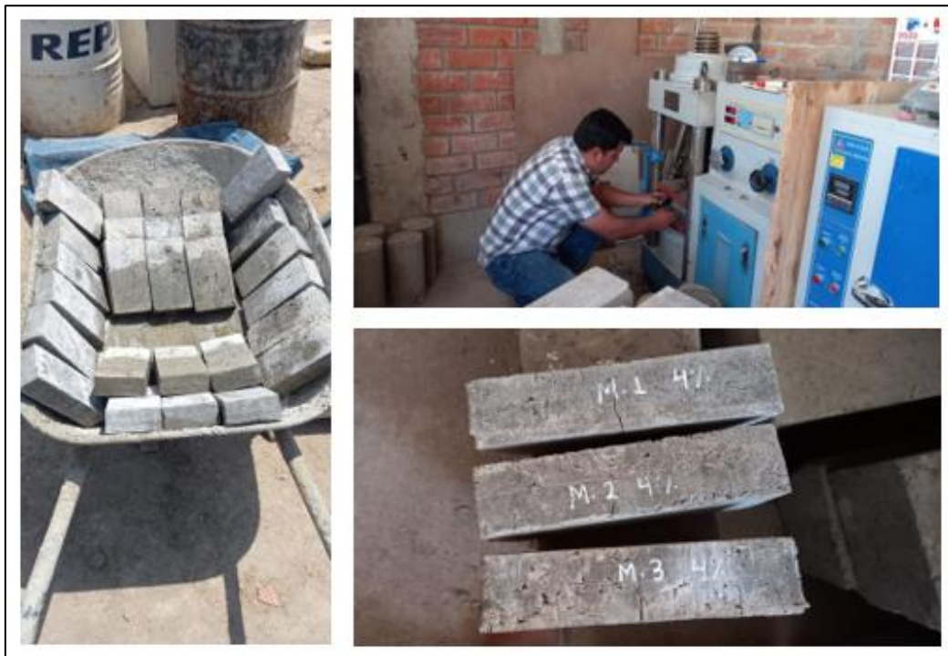
Fig. 28. Ensayo de compresión de los adoquines
