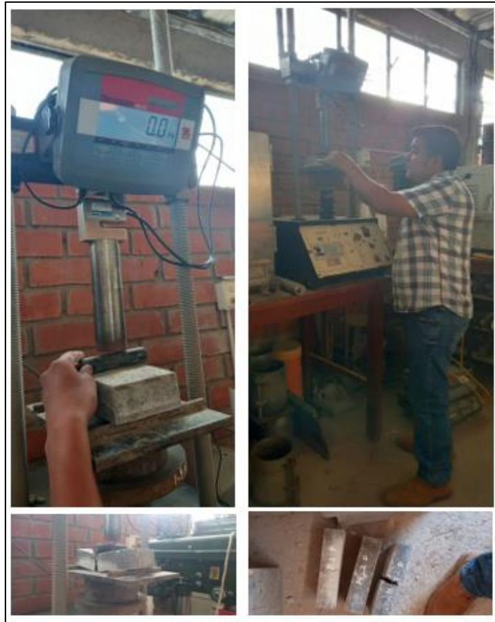
Fig. 29. Ensayo de flexión de adoquines
