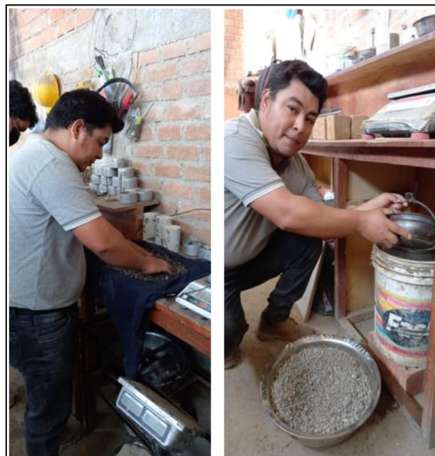
Fig. 24. Ensayo de peso específico y absorción del agregado grueso
