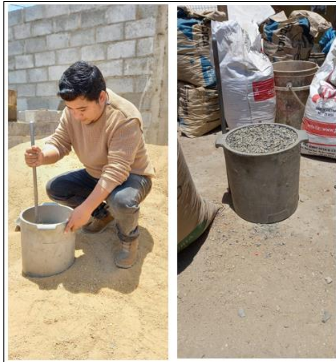
Fig. 25. Ensayo de peso unitario de agregados
