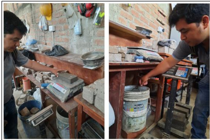
Fig. 30. Ensayo de absorción y densidad de adoquines
