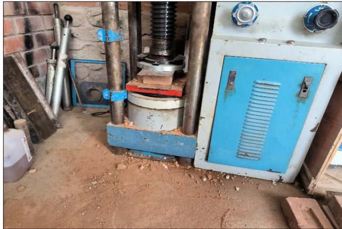
Foto 9: Ensayo de resistencia a la compresión ( f'_b ) de la muestra patrón con concreto triturado al 10%
