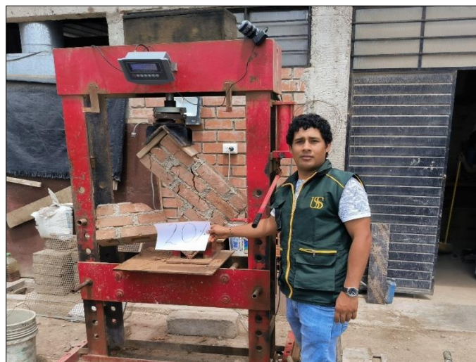
Foto 14: Ensayo de resistencia de la albañilería al corte (V'm) de la muestra patrón con concreto triturado al 20%
