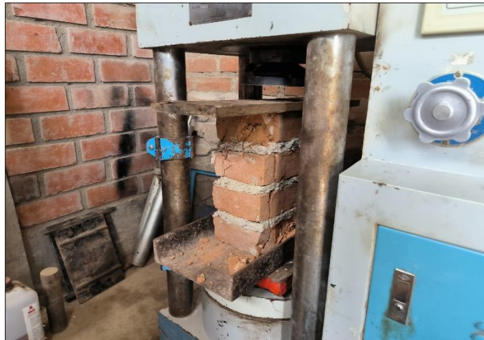
Foto 12: Ensayo de resistencia a la compresión en pilas (f'm) de la muestra patrón con concreto triturado al 15%
