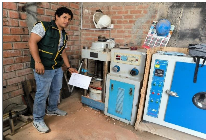
Foto 8: Ensayo de resistencia a la compresión ( f'_b ) de la muestra patrón
