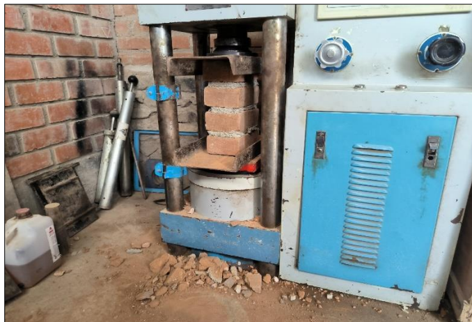
Foto 10: Ensayo de resistencia a la compresión en pilas ( f'_m ) de la muestra patrón
