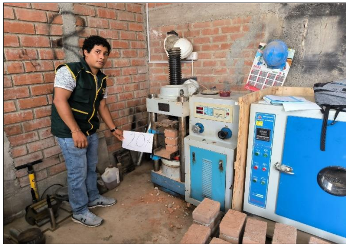
Foto 13: Ensayo de resistencia a la compresión en pilas (f'm) de la muestra patrón con concreto triturado al 20%
