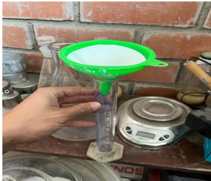
Fig. 9. Filtrando con embudo y uso de papel filtro
