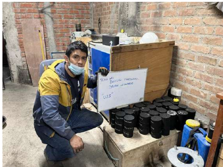
Anexo N° 4. Briquetas listas para compactar
