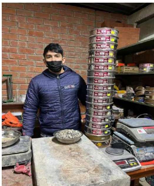
Fig. 4. Previo al tamizado de agregados
