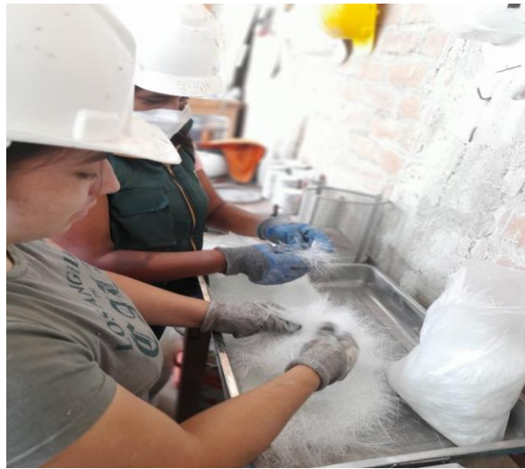
Fig. 6 Fibra de vidrio siendo deshilachada.
