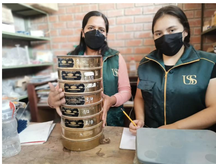
Fig. 8 Tamizado de agregado fino y grueso de materiales pétreos.
