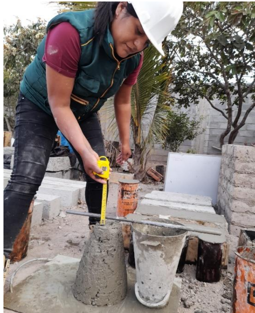
Fig. 16. Medición del asentamiento en concreto fresco.
