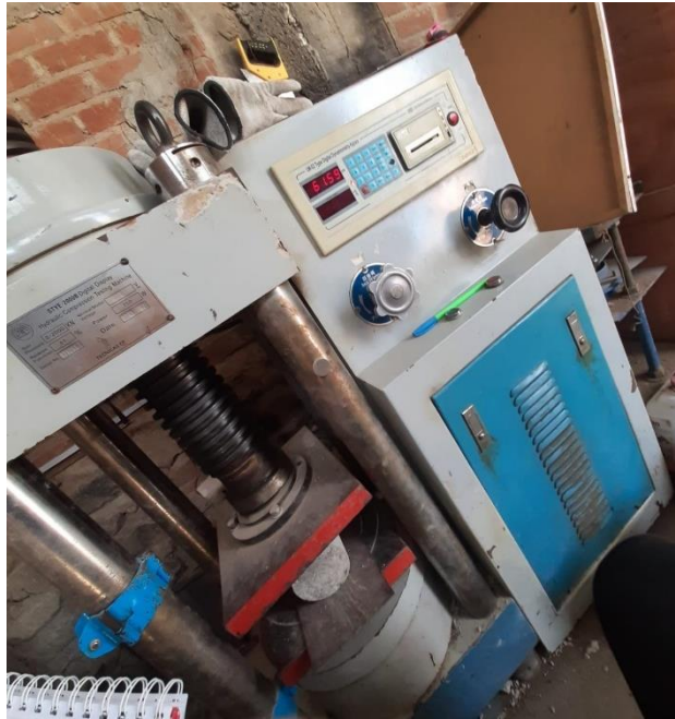
Fig. 20. Ruptura de testigos ensayadas a tracción.
