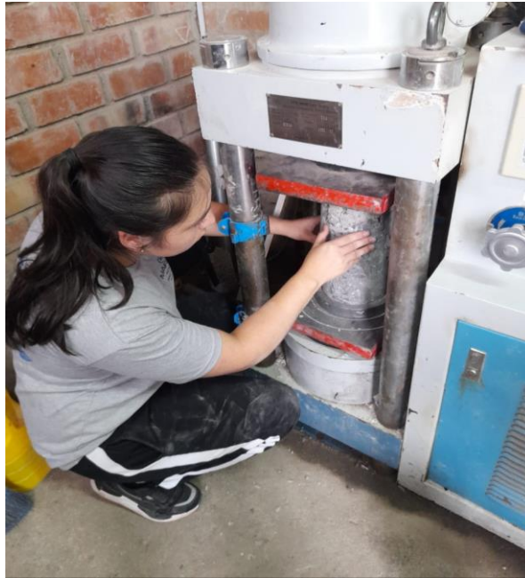
Fig. 19. Ruptura de testigos ensayadas a compresión.
