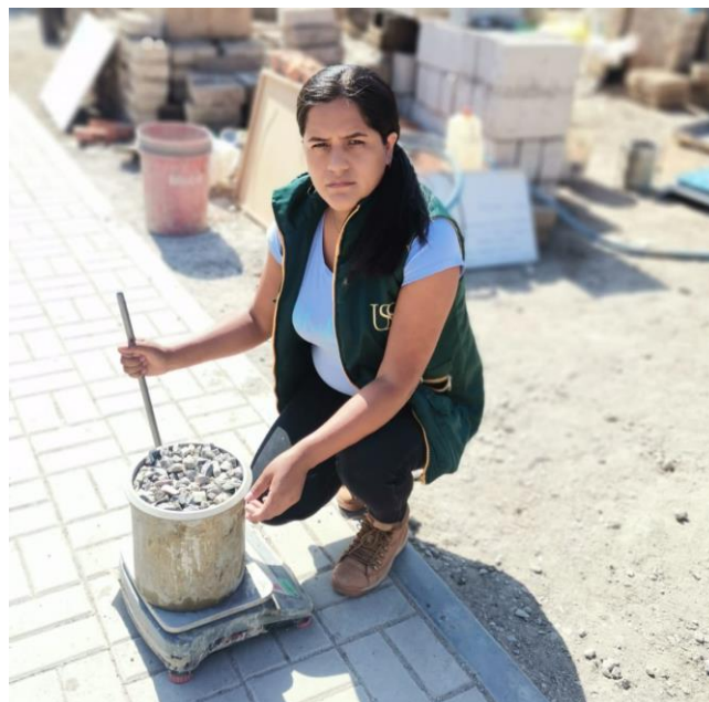
Fig. 9 Peso unitario compactado del agregado grueso.
