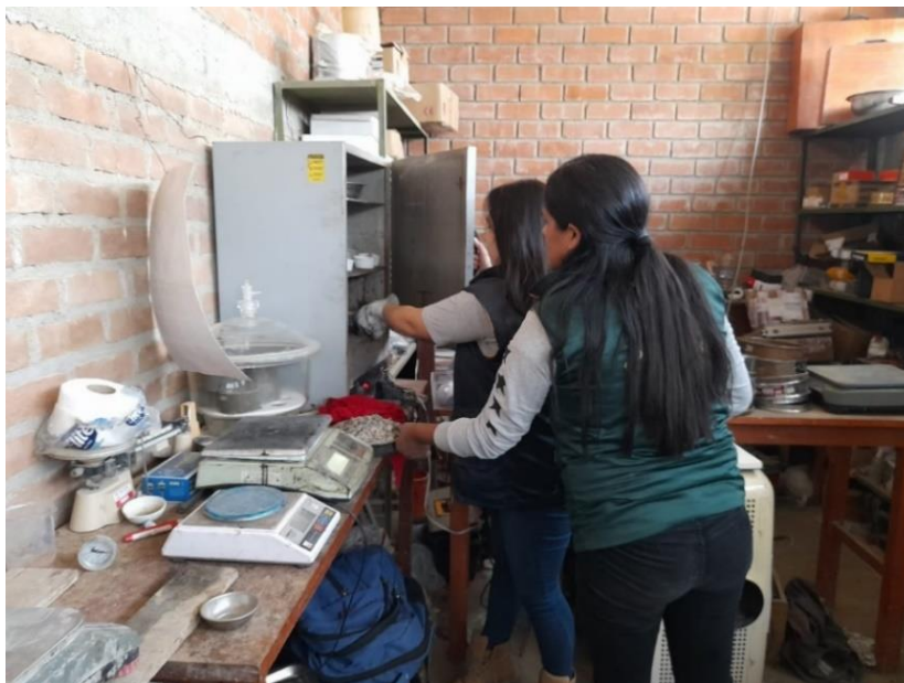
Fig. 10 Muestra colocada al horno para contenido de humedad.
