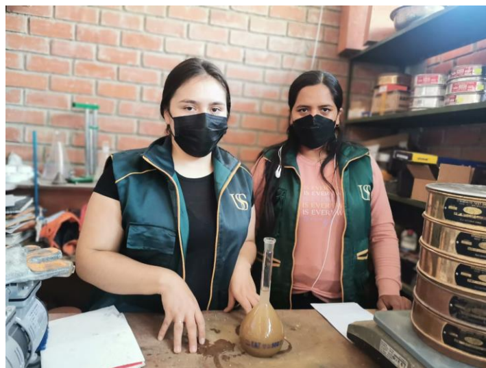
Fig. 12 Fiola con muestra y agua para peso específico.
