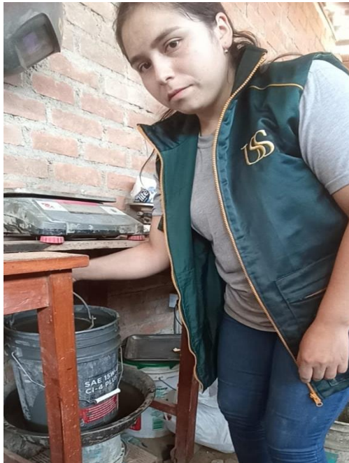
Fig. 11 Ensayo de peso específico del agregado grueso.
