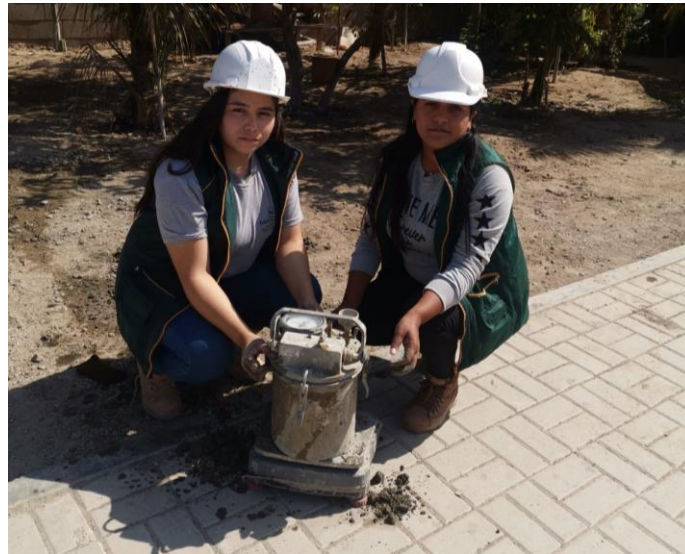
Fig. 18. Medición de contenido de aire en concreto fresco.
