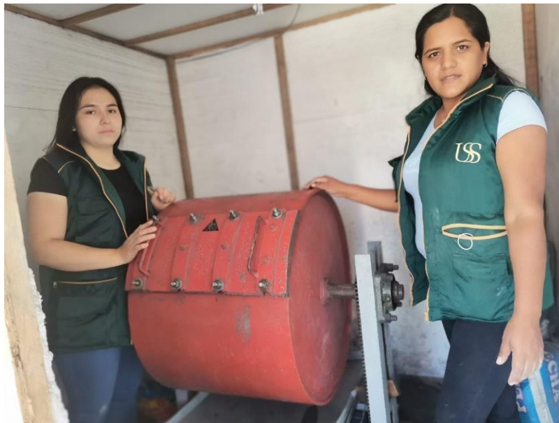
Fig. 14. Máquina de los ángeles para ensayo de abrasión.
