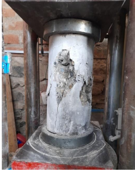
Fig. 15. Probetas de prueba a 7 días para determinar la resistencia crítica de diseño f'_{cr} , con figuras tipo 3.
