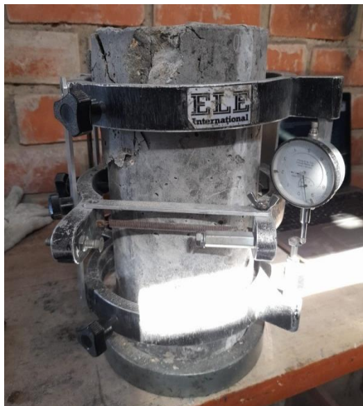
Fig. 22. Módulo de elasticidad a probetas de concreto.
