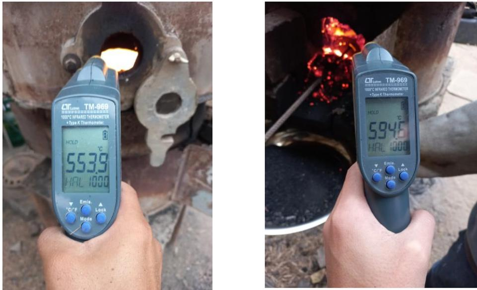
**Fig. 11:** Toma de temperaturas en para obtener la mejor ceniza
