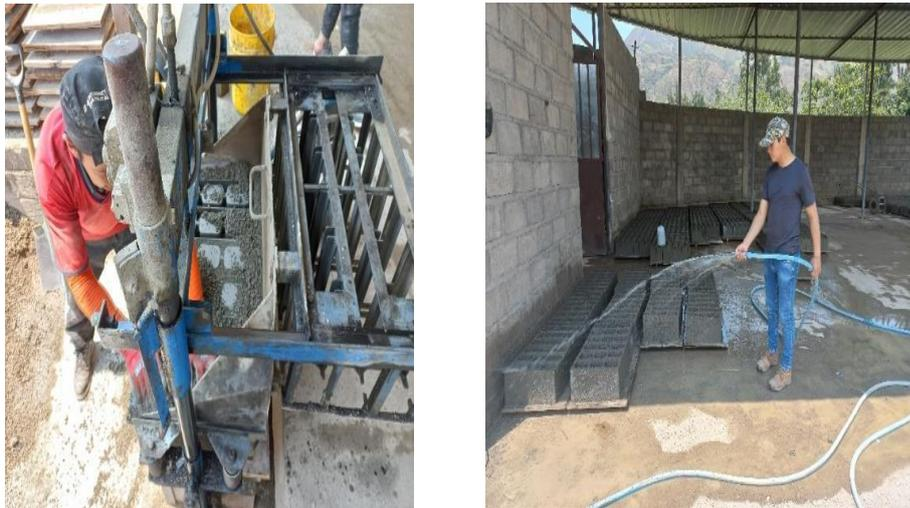
**Fig. 13:** Elaboración de bloques de concreto en serie y curado
