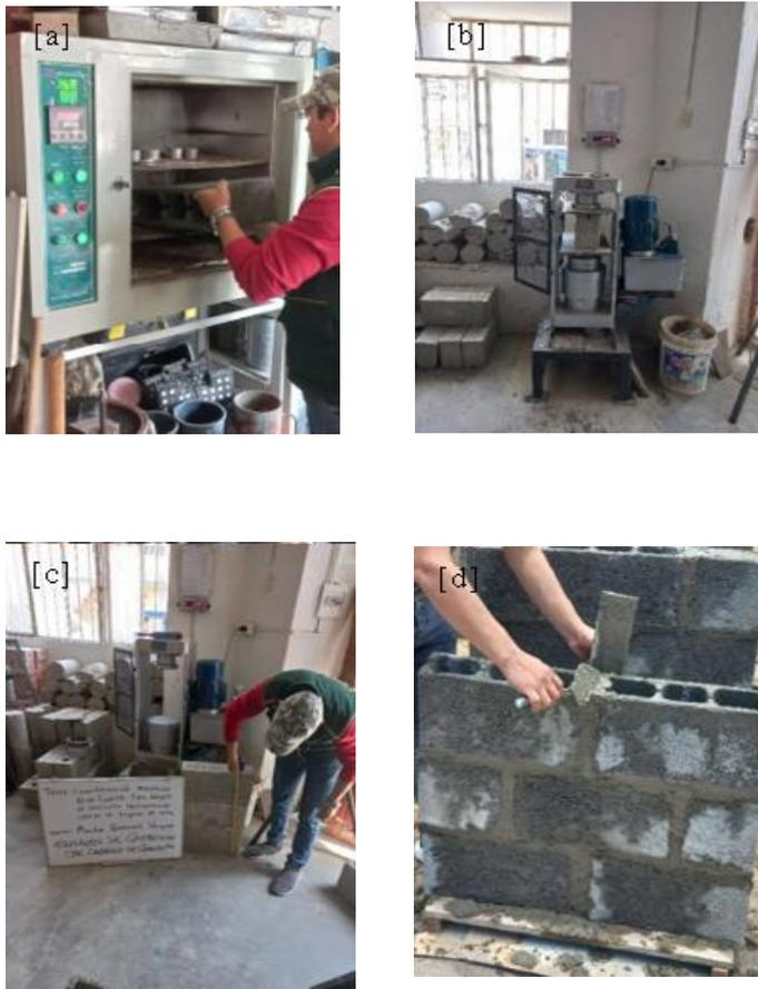
Fig. 14: Ensayos en absorción, resistencia a compresión y muretes
