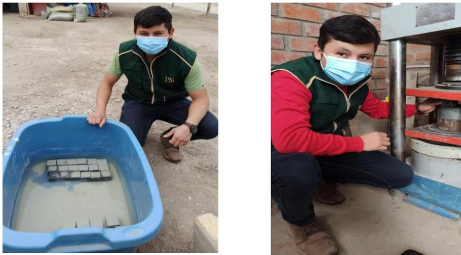
**Fig. 12:** Muestras de curado y rotura de morteros analizados.
