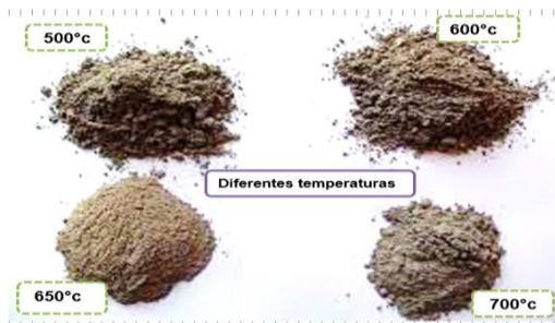
**Fig. 4:** Quemado de ceniza a diferentes temperaturas
