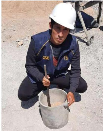
**Fig.17.** Peso unitario compactado del agregado fino.
