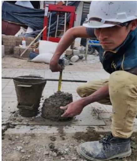
**Fig.23.** Medición del asentamiento en concreto fresco.
