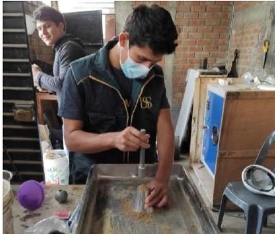
**Fig.20.** Determinación de la muestra saturada superficialmente seca del agregado fino.
