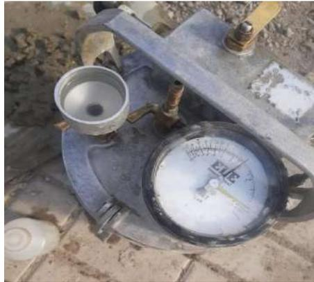
**Fig.26.** Medición del contenido de aire del concreto.
