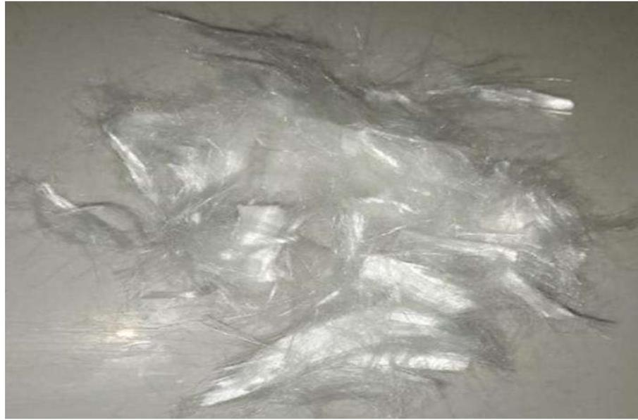
**Fig.15.** Fibra de polipropileno.
