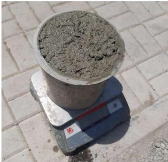
**Fig.25.** Medición del peso unitario del concreto.
