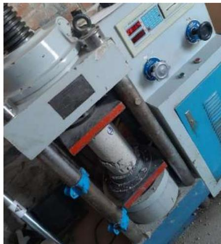
**Fig.27.** Probetas ensayadas a compresión.
