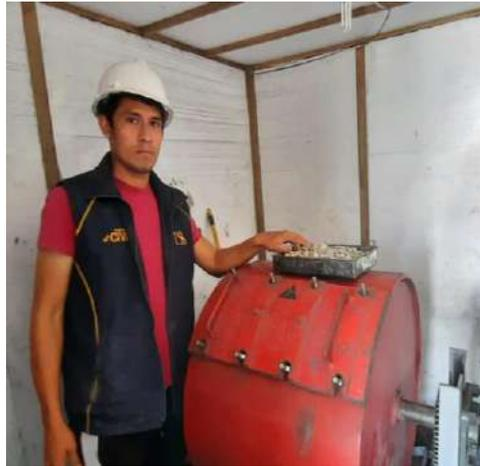
**Fig.22.** Máquina de los ángeles para ensayo de abrasión de agregado grueso.
