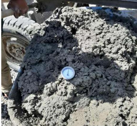
**Fig.24.** Medición de la temperatura del concreto fresco.
