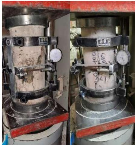
**Fig.30.** Ensayo de módulo de elasticidad.
