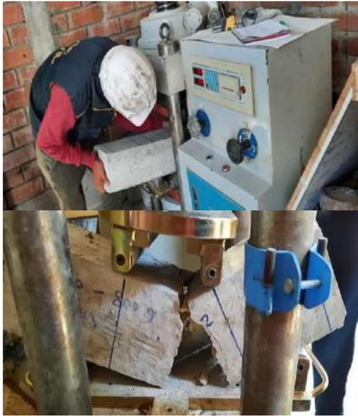
**Fig.29.** Vigas ensayadas a flexión.
