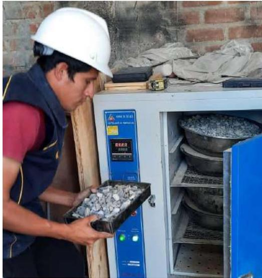
**Fig.18.** Muestra de agregado grueso a ser introducida al horno
