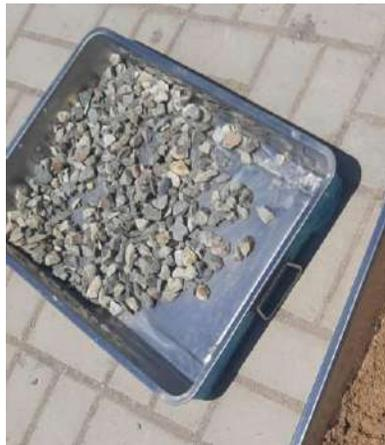
**Fig.19.** Muestras de agregado fino y grueso para peso específico.
