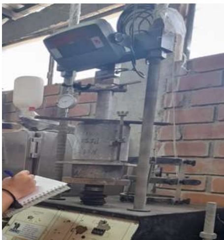
Fig. 5. Realización de ensayo de california bearing ratio del suelo en estudio
