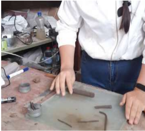
Fig. 3. Realización de ensayo de límites de Atterberg del suelo en estudio.
