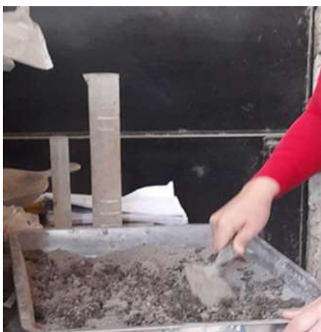
Fig. 4. Realización de proctor modificado del suelo en estudio.
