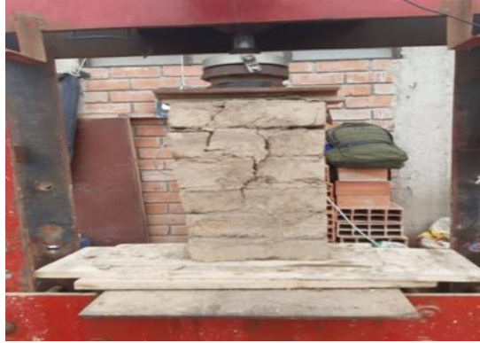
Fig. 10. Ensayo de resistencia a la compresión en pilas
