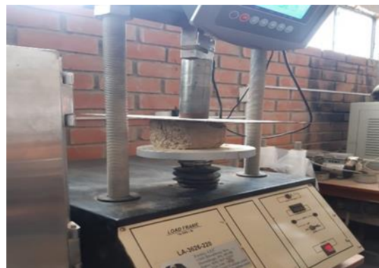
Fig. 9. Ensayo de resistencia a la compresión en cubos
