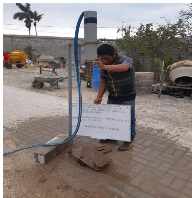
Realización del ensayo de erosión en el adobe
