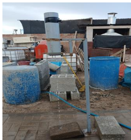
Fig. 7. Ensayo de resistencia al desgaste por goteo
