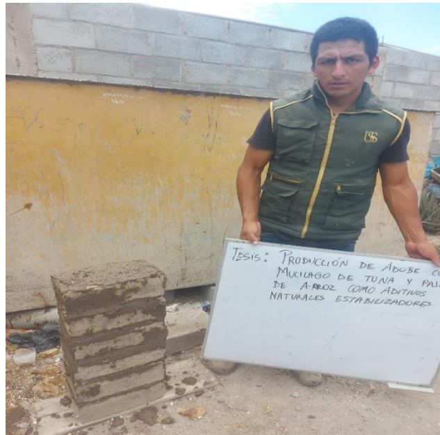
Muestra elaborada para el ensayo a compresión en muretes de adobe
