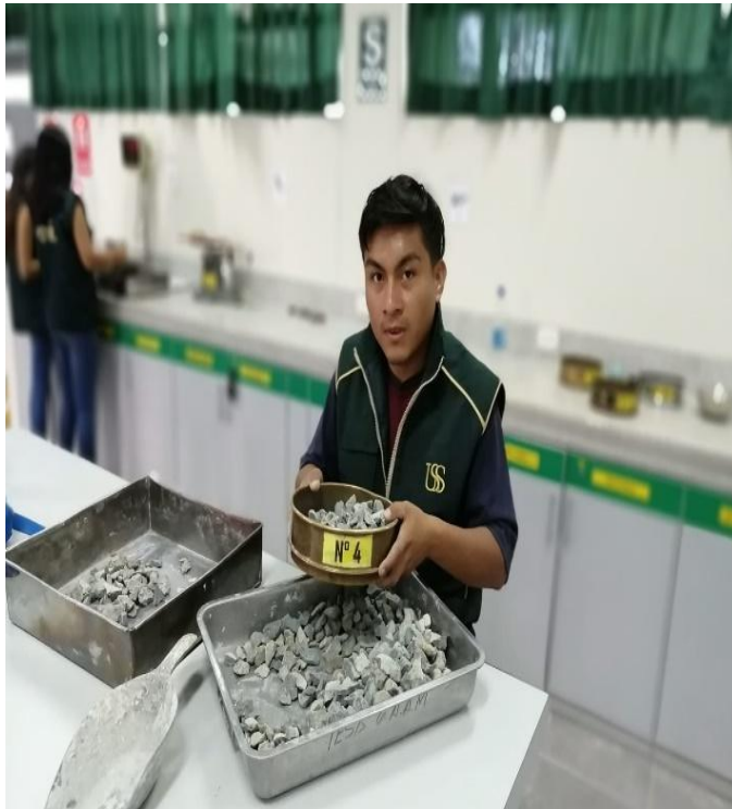
Foto N°03. Análisis granulométrico de los agregados.
