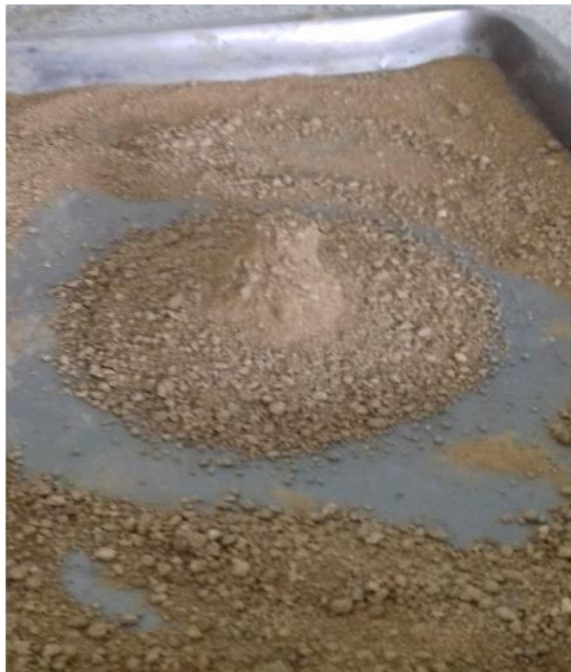
Foto N°04. Muestra del agregado grueso superficialmente seca
