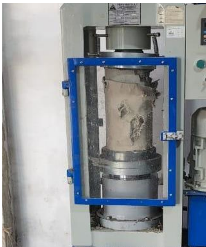
Foto N°06. Ensayo de Resistencia a la Compresión
