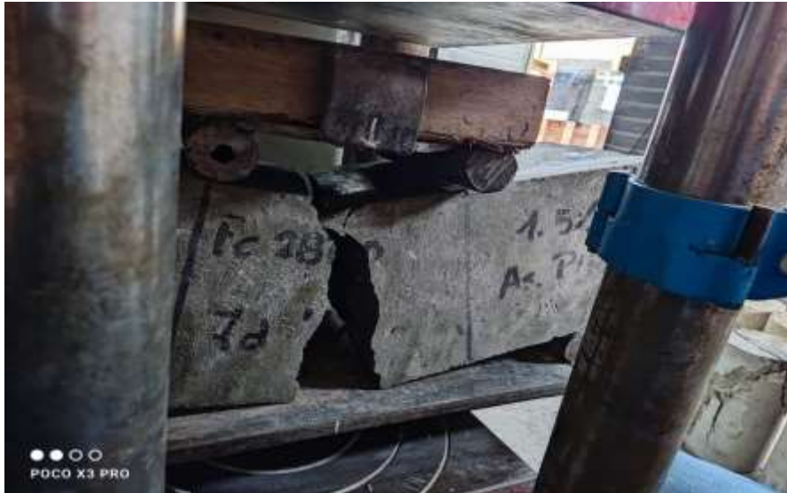
Fig. 57. Falla de viga – Ensayo a flexión.
