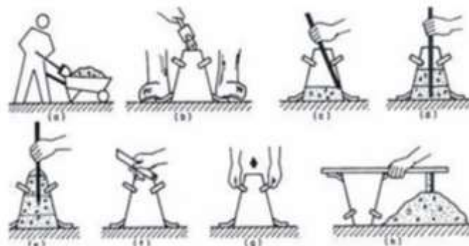
Fig. 1. Procedimiento para determinar el SLUMP [43].
