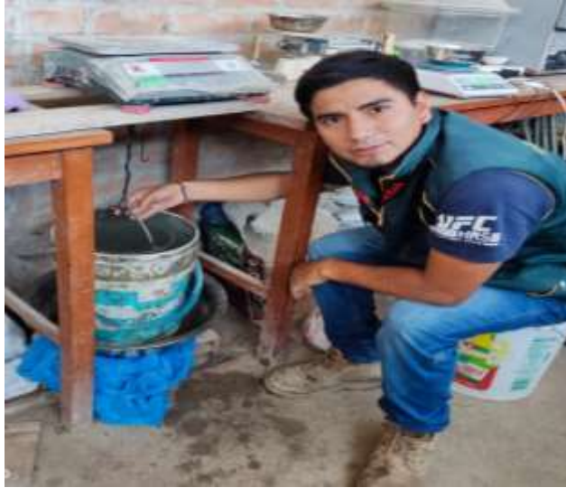
Fig. 20. Ensayo de Peso específico y absorción del agregado grueso.
