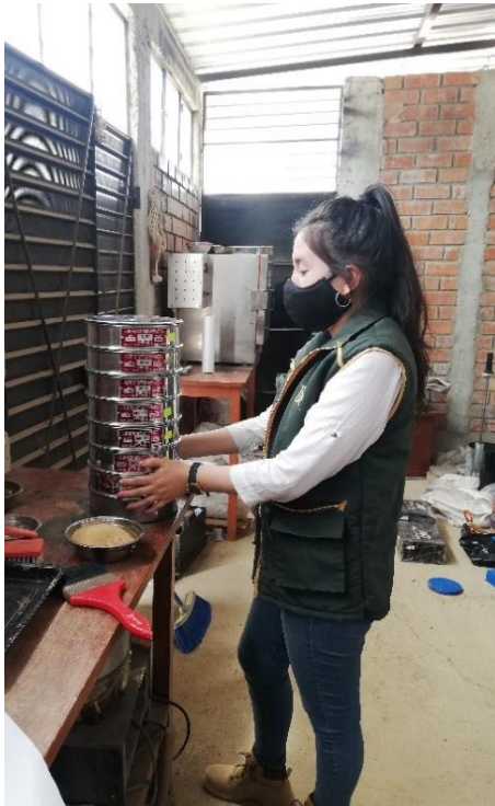
Análisis granulométrico del agregado fino.
