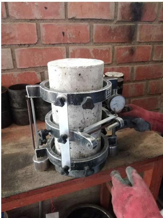
Ensayo de módulo de elasticidad.
