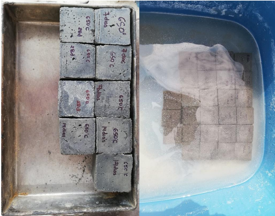
Especímenes cúbicos de mortero endurecidos y curado en agua.
