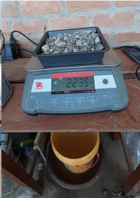
Absorción y peso específico del agregado grueso.
