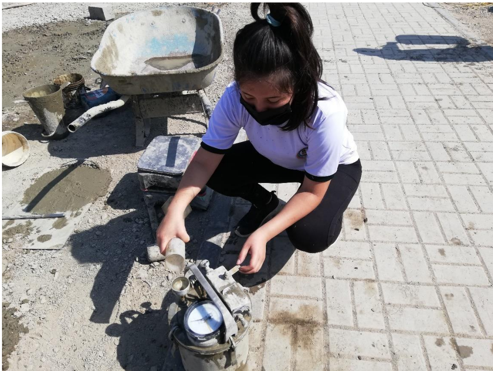
Ensayo de contenido de aire.
