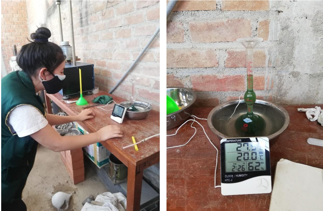
Ensayo de peso específico para el cemento.
