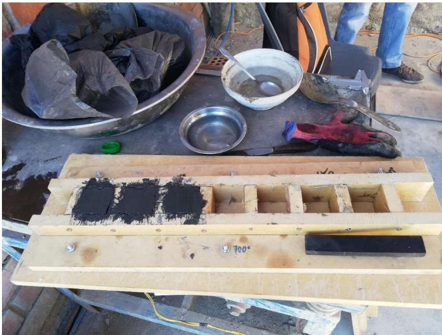
Preparación de los especímenes cúbicos de mortero con CBCA.
