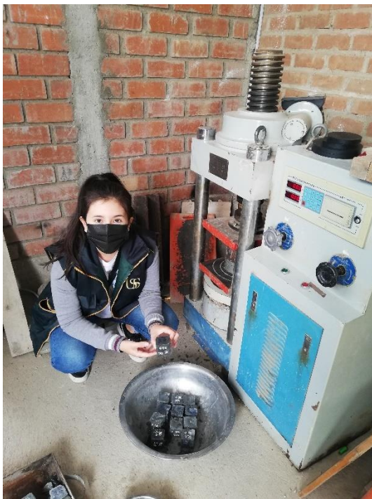
Ensayo de resistencia a la compresión de los especímenes cúbicos.
