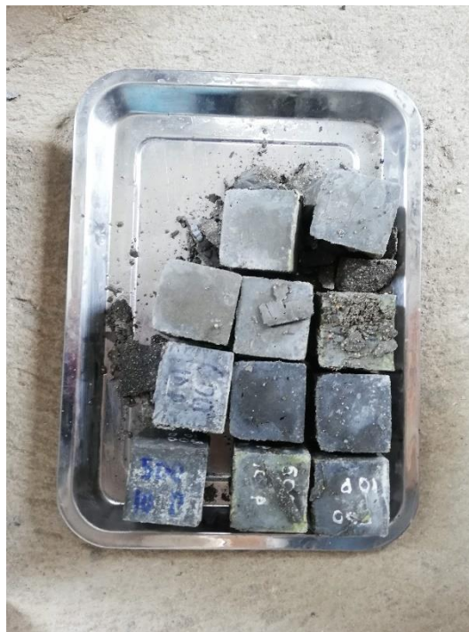
Ensayo de resistencia a la compresión de los especímenes cúbicos.
