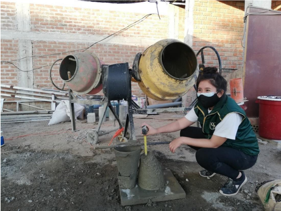
Ensayo de asentamiento o slump.
