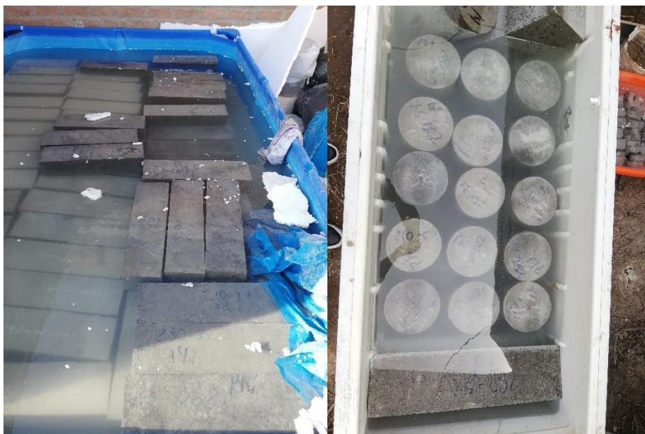
Curado de los testigos de concreto.
