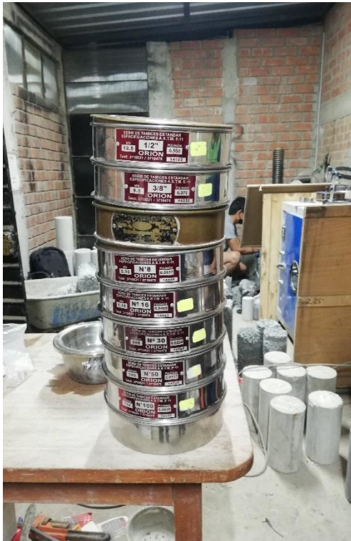
Granulometría y peso específico de CBCA.
