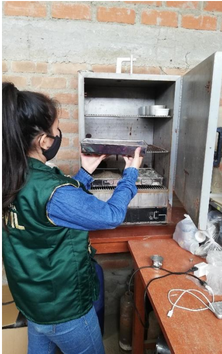
Contenido de humedad del agregado fino.
