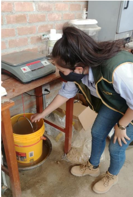
Absorción y peso específico del agregado grueso.
