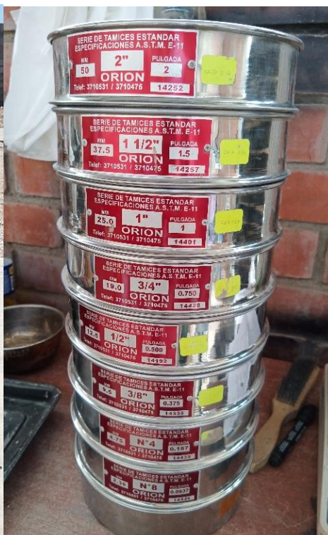
Análisis granulométrico del agregado grueso.
