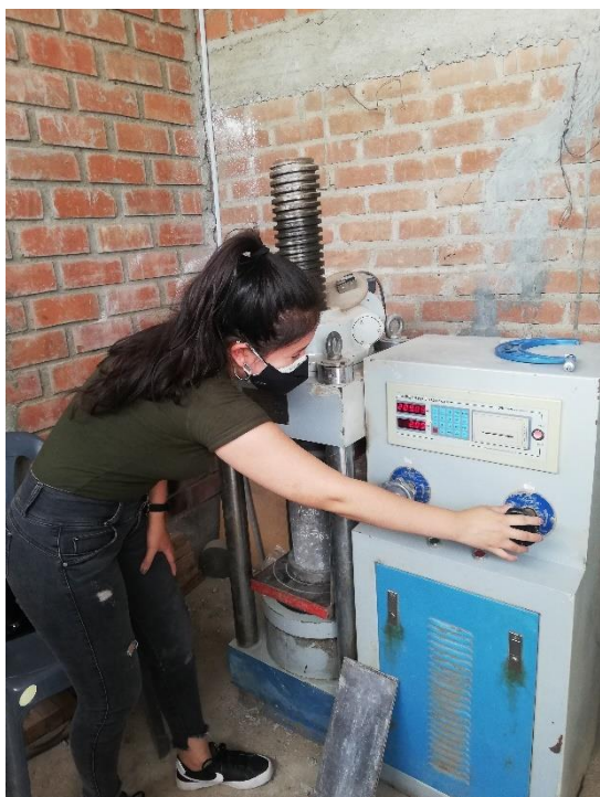
Ensayo de resistencia a la compresión axial.
