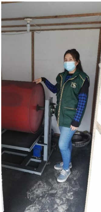
Molienda de CBCA en máquina de abrasión Los Ángeles.
