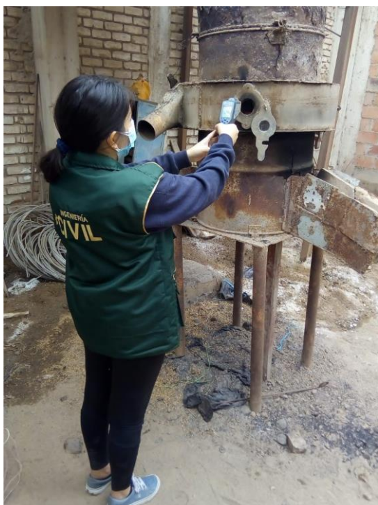
Quemado de CBCA con control de temperatura.
