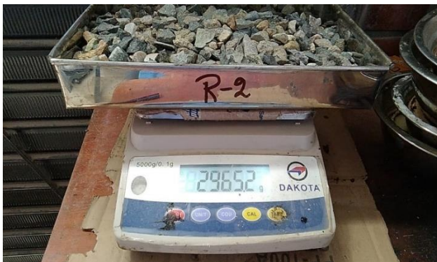
Contenido de humedad del agregado grueso.
