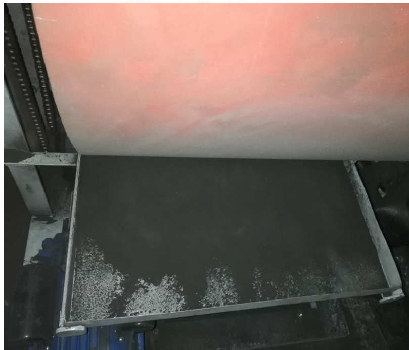
Molienda de CBCA en máquina de abrasión Los Ángeles.
