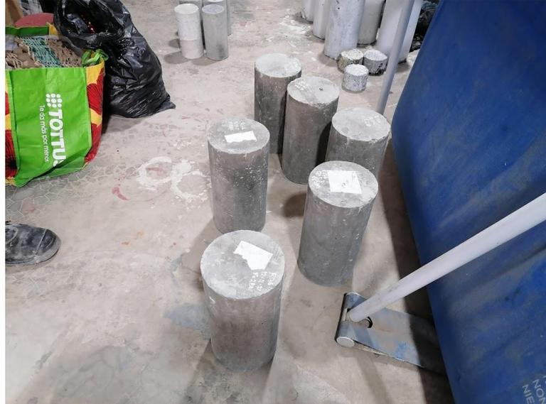
*Elaboración de probetas patrón para ensayos de resistencia*
