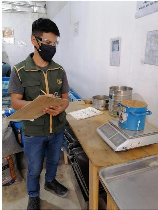
*Ensayo de Peso Unitario del agregado fino*
