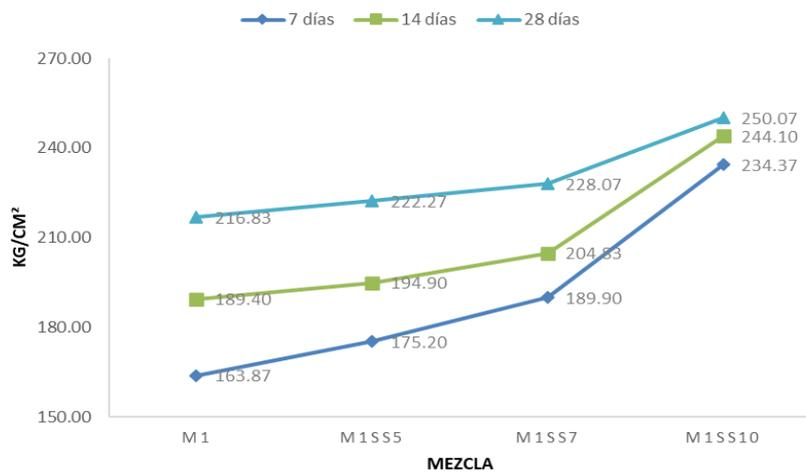
**Fig. 13.** Resistencia a compresión de probeta patrón + adiciones, concreto 210 kg/cm<sup>2</sup>
