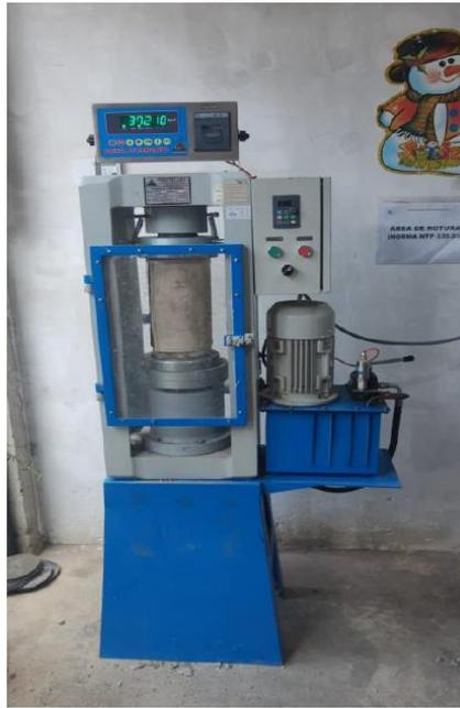
*Ensayo de resistencia a la compresión cilíndrica a los 7, 14 y 28 días de curado para concreto  $f'c = 210 \text{ kg/cm}^2$*
