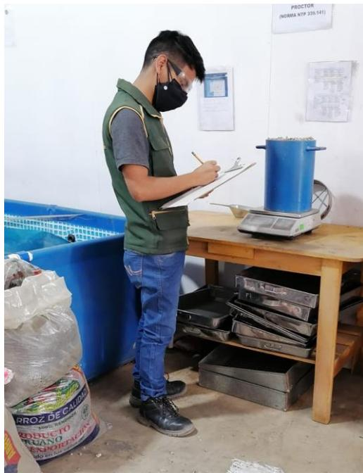
*Ensayo de Peso Unitario del agregado grueso*
