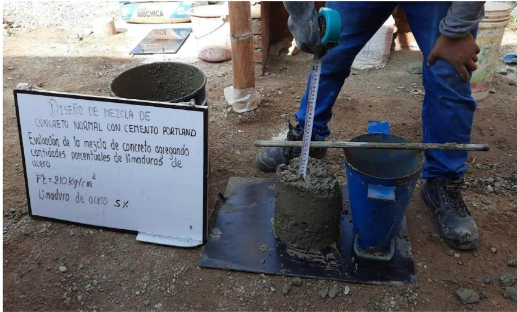
*Prueba de consistencia del concreto patrón en estado fresco (SLUMP) para un diseño de concreto  $f'c = 210 \text{ kg/cm}^2$*
