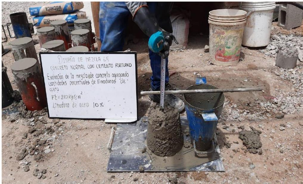
*Prueba de consistencia del concreto modificado (+10% de limaduras de acero) en estado fresco para un diseño de concreto  $f'c = 210 \text{ kg/cm}^2$*
