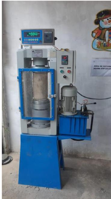
*Ensayo de resistencia a la compresión cilíndrica a los 7, 14 y 28 días de curado para concreto  $f'c = 280 \text{ kg/cm}^2$*
