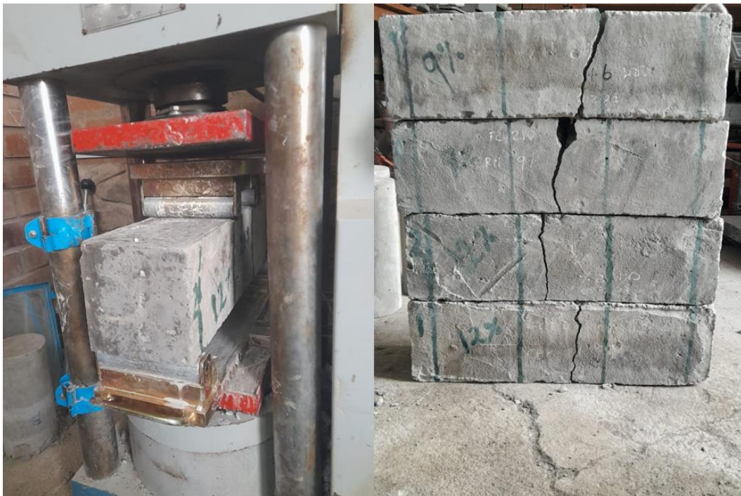
Fig. 62. Ensayo de resistencia a la flexión
