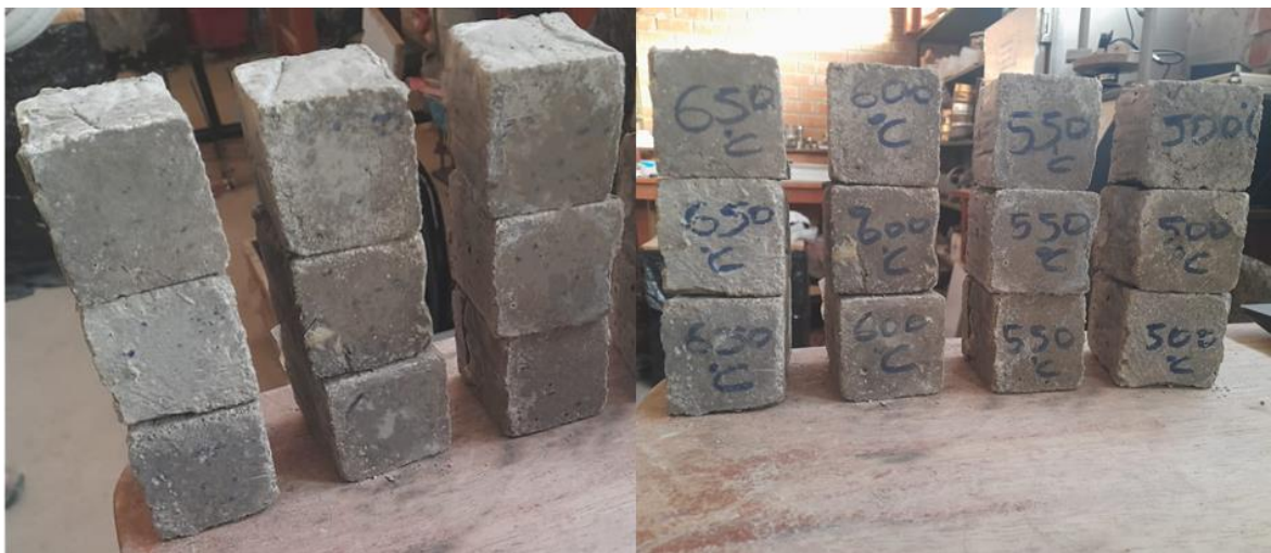
Fig. 56. Bloques de Morteros de 1:3.5 con 10% CRM es estado endurecido
