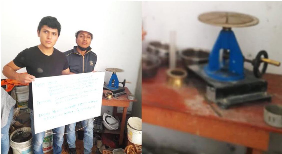
Fig. 55. Determinación de la fluidez del mortero 1:3.5 con 10% CRM
