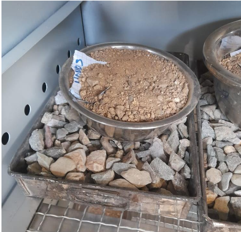
Fig. 49. Ensayo contenido de humedad del agregado fino y grueso
