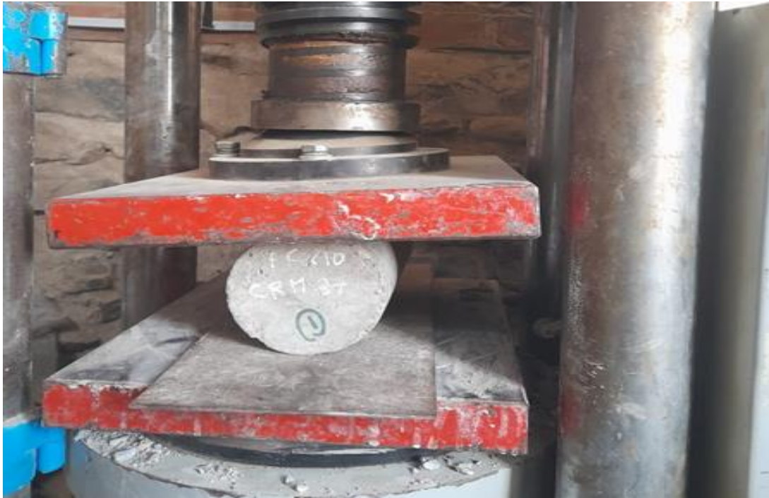
Fig. 61. Ensayo de resistencia a la tracción por compresión diametral
