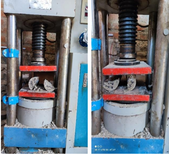
Fig. 85. Falla de espécimen con FPM, por tracción.
