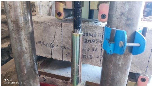
Fig. 82. Falla por flexión de especímenes con FH.
