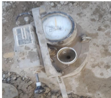
Fig. 71. Ensayo de contenido de aire
