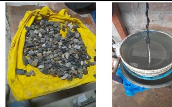
Fig. 63. Ensayo de peso específico y absorción agregado grueso.
