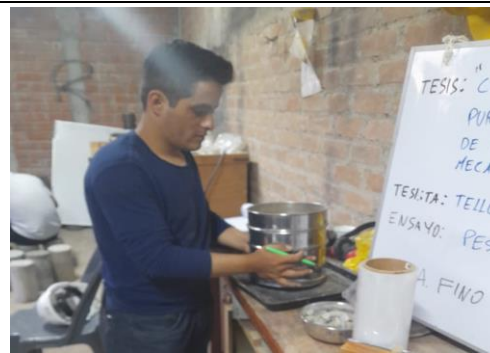
Fig. 62. Ensayo de granulometría de agregados.
