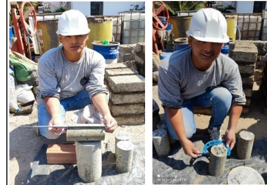
Fig. 75. Medición de especímenes para ensayos mecánicos.
