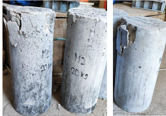
Fig. 80. Falla de especímenes con FH, luego del ensayo a compresión.
