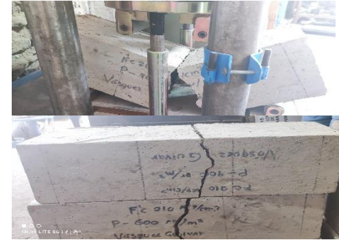
Fig. 81. Falla por flexión de espécimen con FPM. El espécimen se dividió en dos partes luego de la falla.
