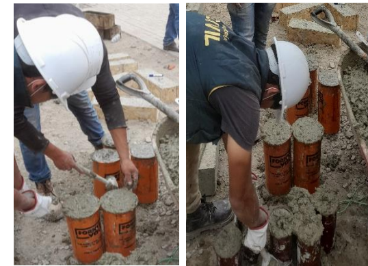
Fig. 72. Elaboración de especímenes cilíndricos.
