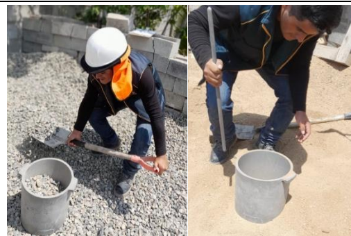
Fig. 65. Ensayo de peso unitario de los agregados.
