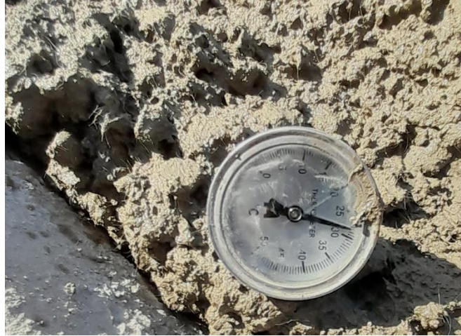
Fig. 22. Medición de la temperatura de la mezcla de concreto fresco.
