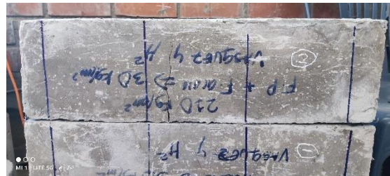
Fig. 83. Falla por flexión de especímenes con FH. Nótese una grieta poco perceptible, y el elemento se mantiene visiblemente en su estado original.
