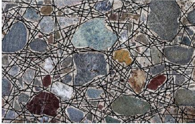
Fig. 11. Refuerzo fibroso del concreto con fibras de acero. Distribución al azar típica de las fibras de acero en la mezcla del concreto. [49]
