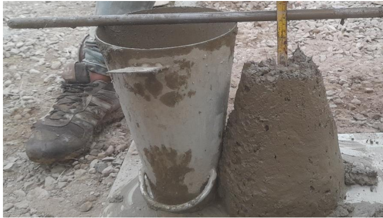
Fig. 20. Revenimiento de la mezcla de concreto fresco.
