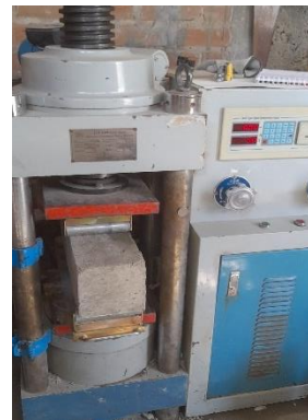
Fig. 77. Configuración del espécimen para ensayo a flexión.
