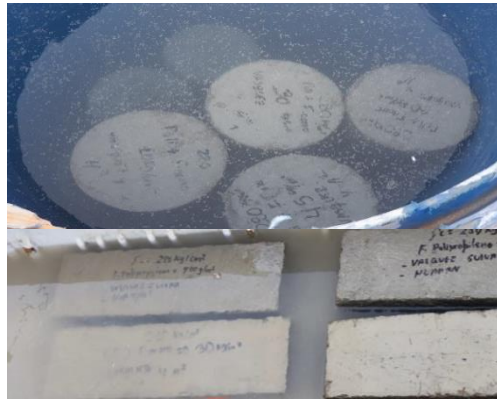
Fig. 73. Elaboración de especímenes prismáticos. (vigas).
