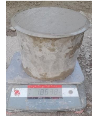
Fig. 69. Ensayo de peso unitario del concreto fresco.
