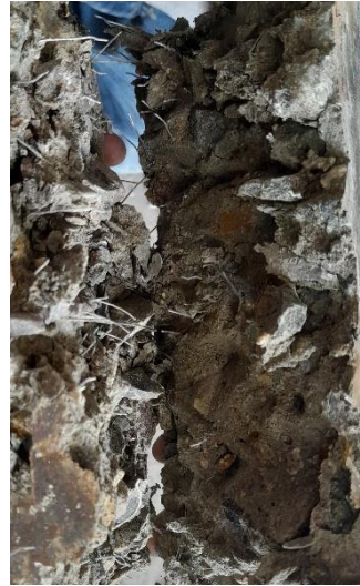
Fig. 86. Falla de espécimen con FH, por tracción
