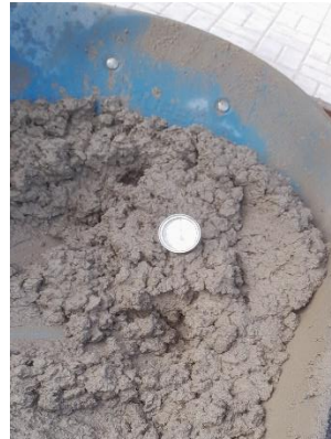
Fig. 68. Ensayo de temperatura del concreto fresco.
