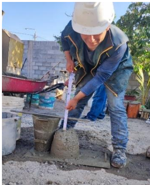
Fig. 70. Ensayo de Asentamiento (Slump).
