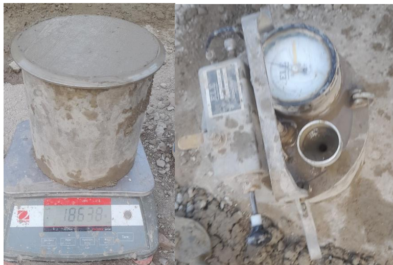
Fig. 21. Ensayo para determinar el contenido de aire de la mezcla fresca de concreto.
