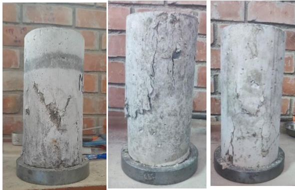
Fig. 79. Falla de especímenes con FPM, luego del ensayo a compresión.
