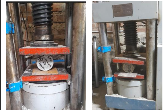
Fig. 78. Configuración de del espécimen para el ensayo de tracción.
