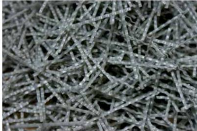
Fig. 16. Macrofibra de acero para concreto Sika® Fiber CHO 80/60 NB. [51]
