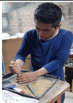
Fig. 64. Ensayo de peso específico del agregado fino.
