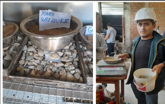
Fig. 61. Ensayo de contenido de humedad de los agregados.
