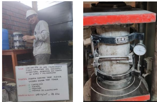
Fig. 76. Configuración del espécimen para ensayo de resistencia a compresión y módulo de elasticidad.
