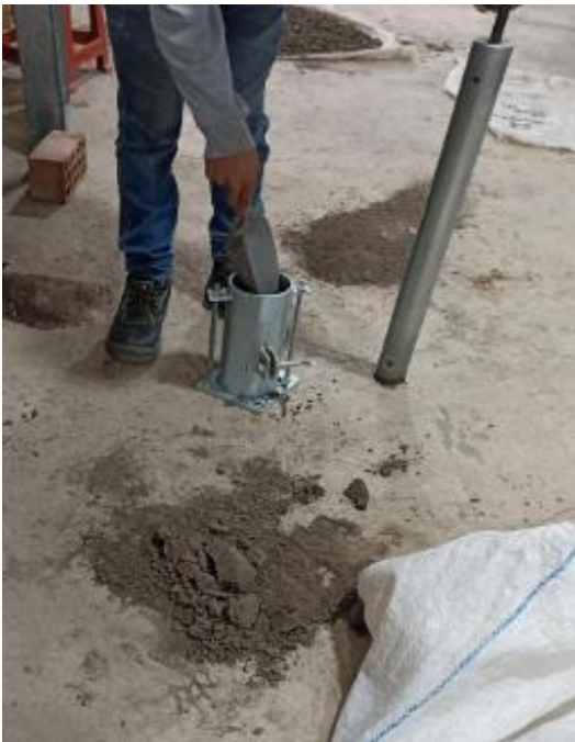
Fig. 10. Ensayo Próctor modificado
