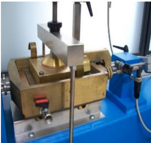
Fig. 12. Ensayo de corte directo
