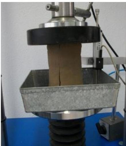
Fig. 11. Ensayo de compresión no confinada
