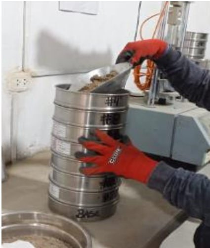
Fig. 7. Granulometría del material
