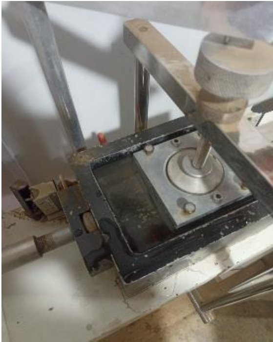
Fig. 25. Ensayo de corte directo
