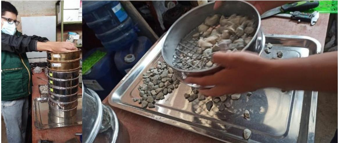
**Fig. 5.** Ensayo de Granulometría en agregados.
