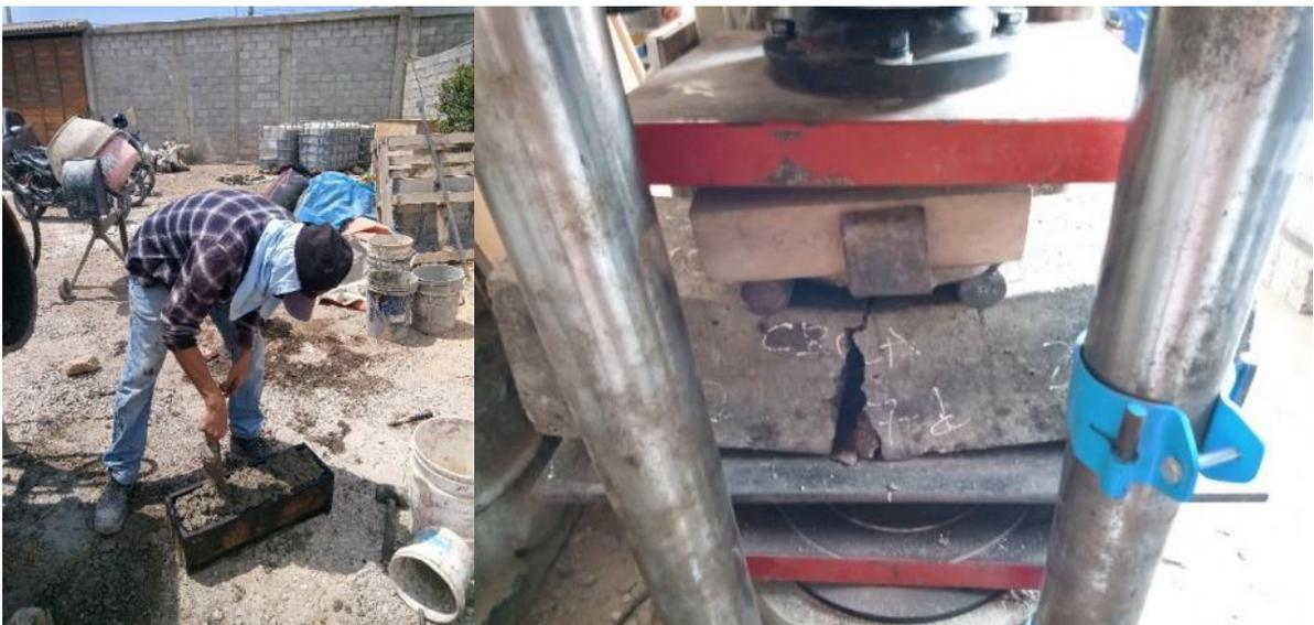
**Fig. 20.** Prismas rectangulares para la prueba de resistencia a la flexión.
