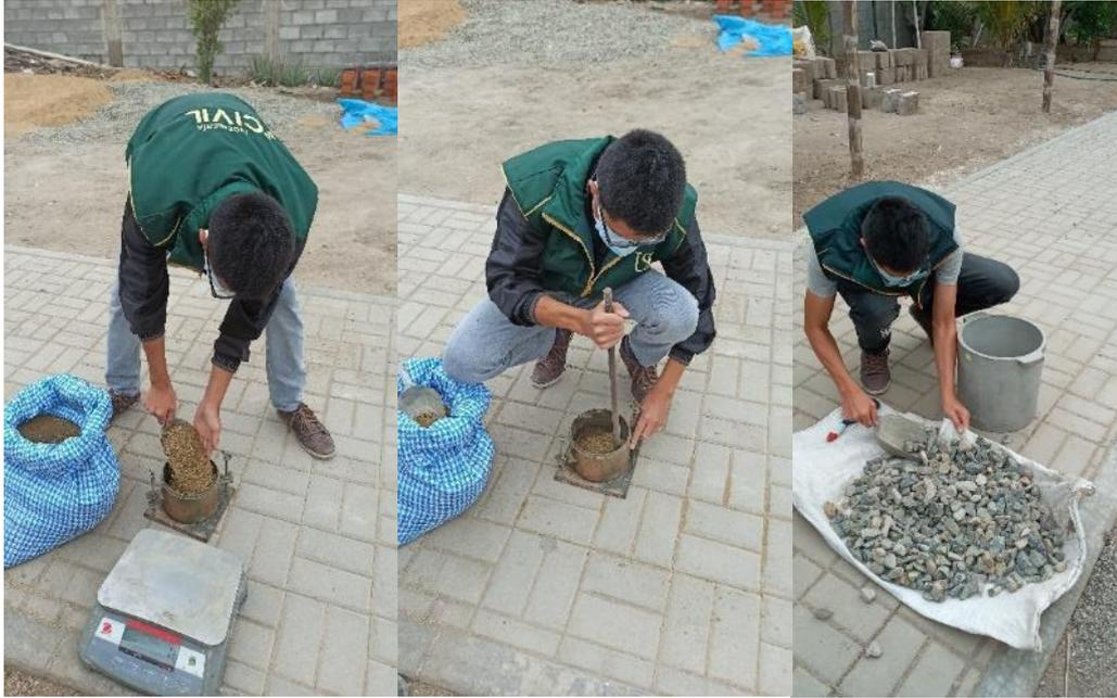
**Fig. 8.** Peso unitario en agregados.
