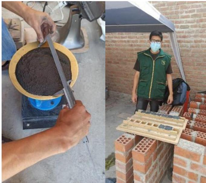
**Fig. 11.** Fluidez y desencofrado de cubos.
