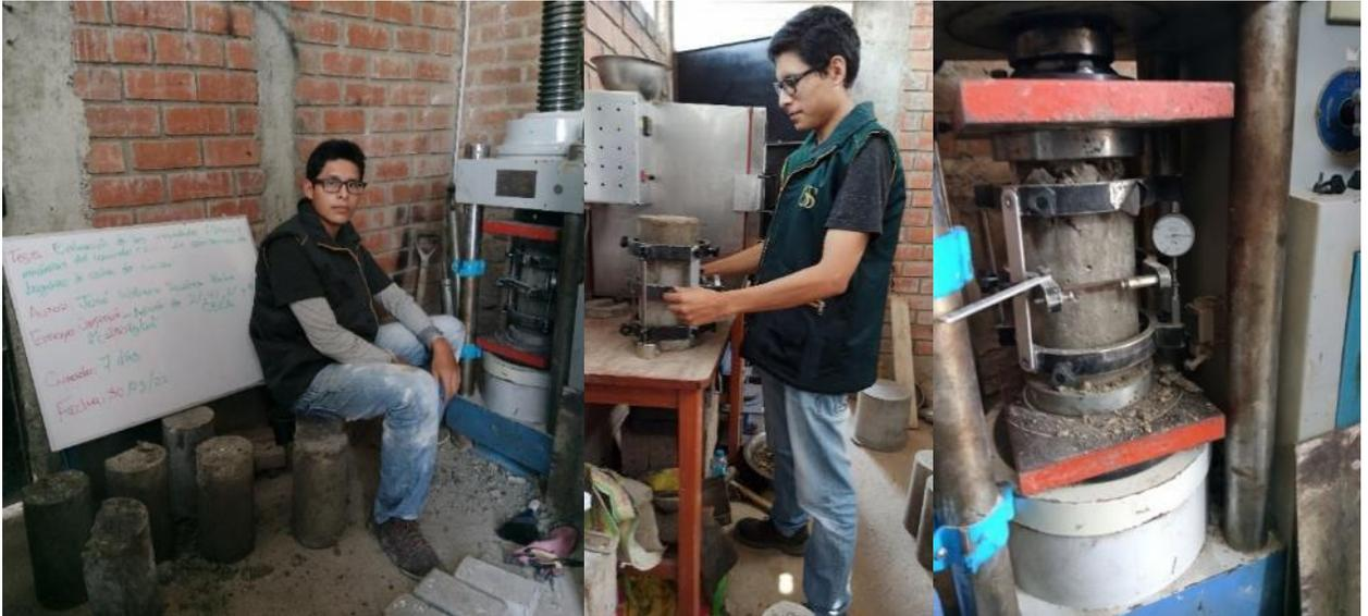
**Fig. 18.** Muestras cilíndricas para los ensayos de módulo de elasticidad y resistencia a la compresión.
