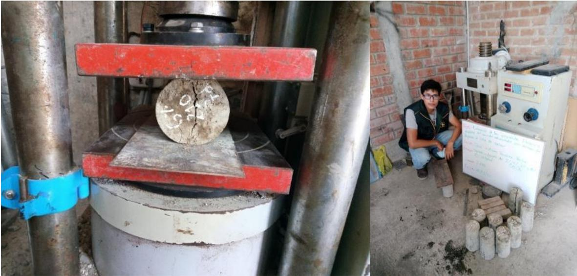
**Fig. 19.** Muestras cilíndricas para la prueba de resistencia a la tracción.
