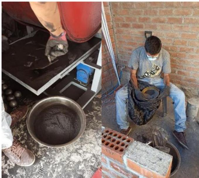
**Fig. 14.** Resultado del triturado en molino de bolas y tamizado de CBCA.
