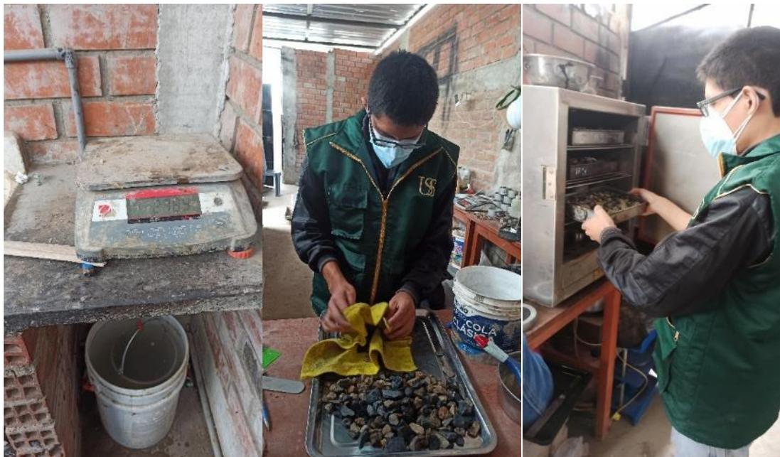
**Fig. 7.** Absorción y peso específico en agregado grueso.
