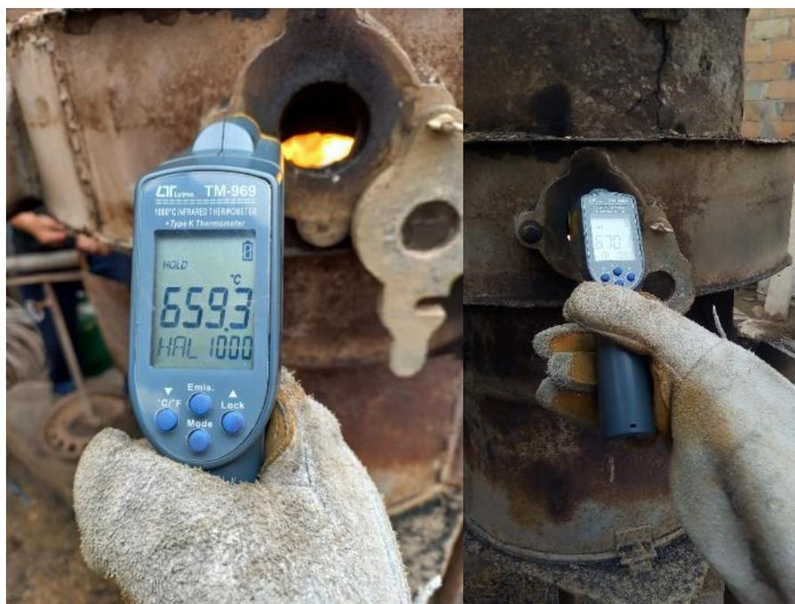
**5. Ceniza para adicionar al concreto según la temperatura óptima de calcinación**
