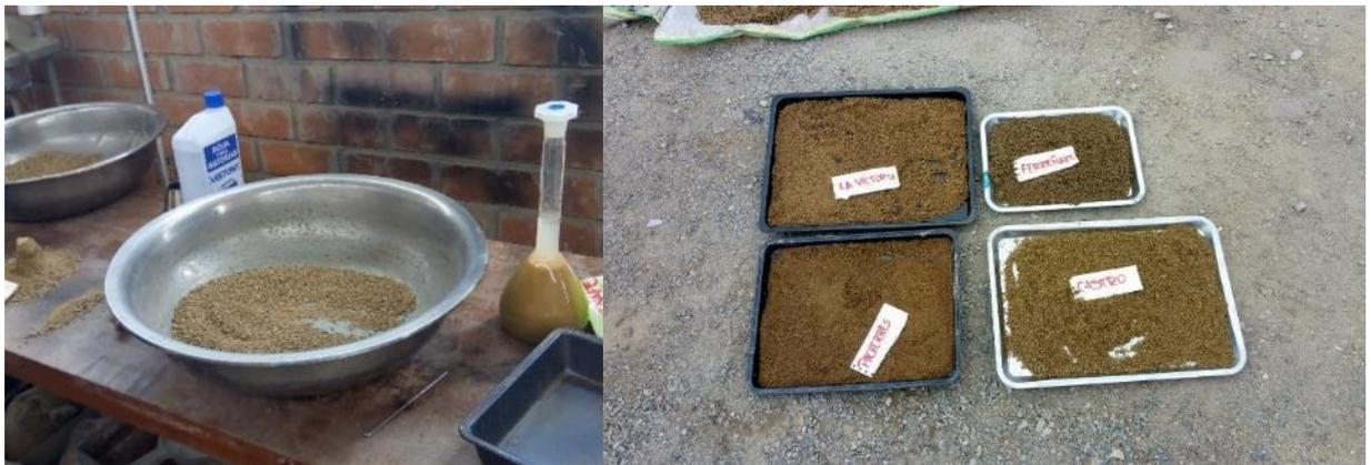
**Fig. 6.** Ensayo de absorción y gravedad específica en agregado fino.
