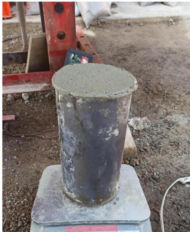
**Fig. 15.** Peso unitario en el concreto fresco.
