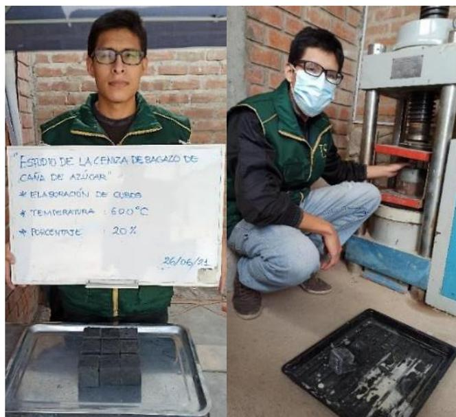
**Fig. 12.** Muestras de ensayo y colocación en máquina para resistencia a la compresión.
