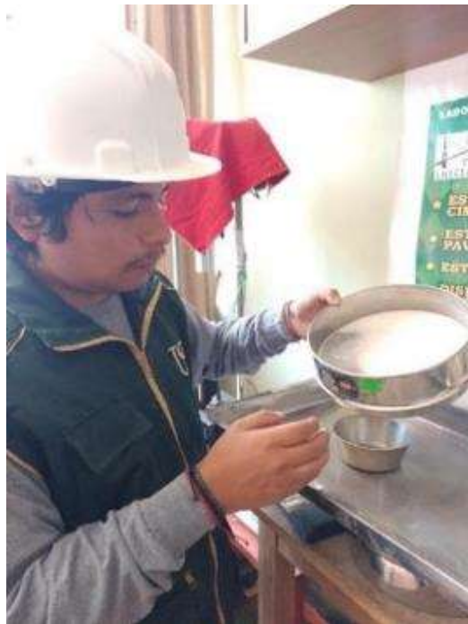
Fig. 16. Tamizado del almidón de arroz.
