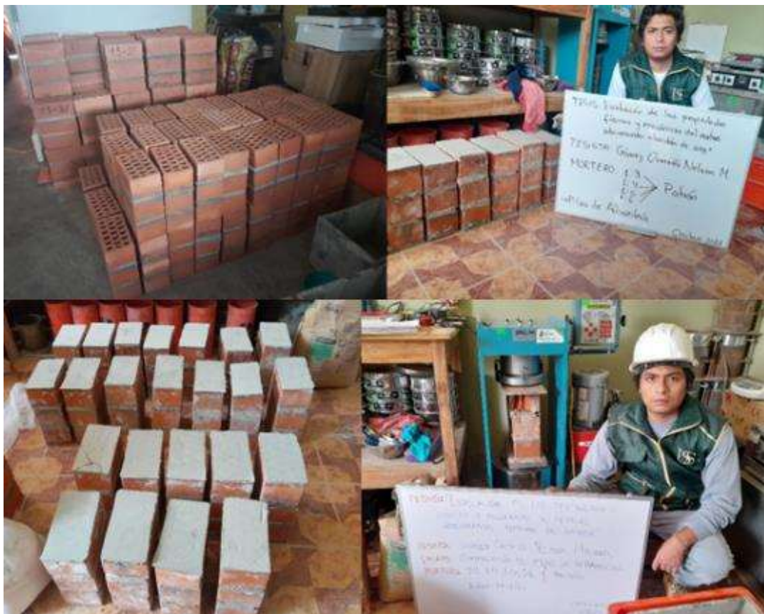
Fig. 43. Resistencia a la compresión axial en pilas de albañilería.
