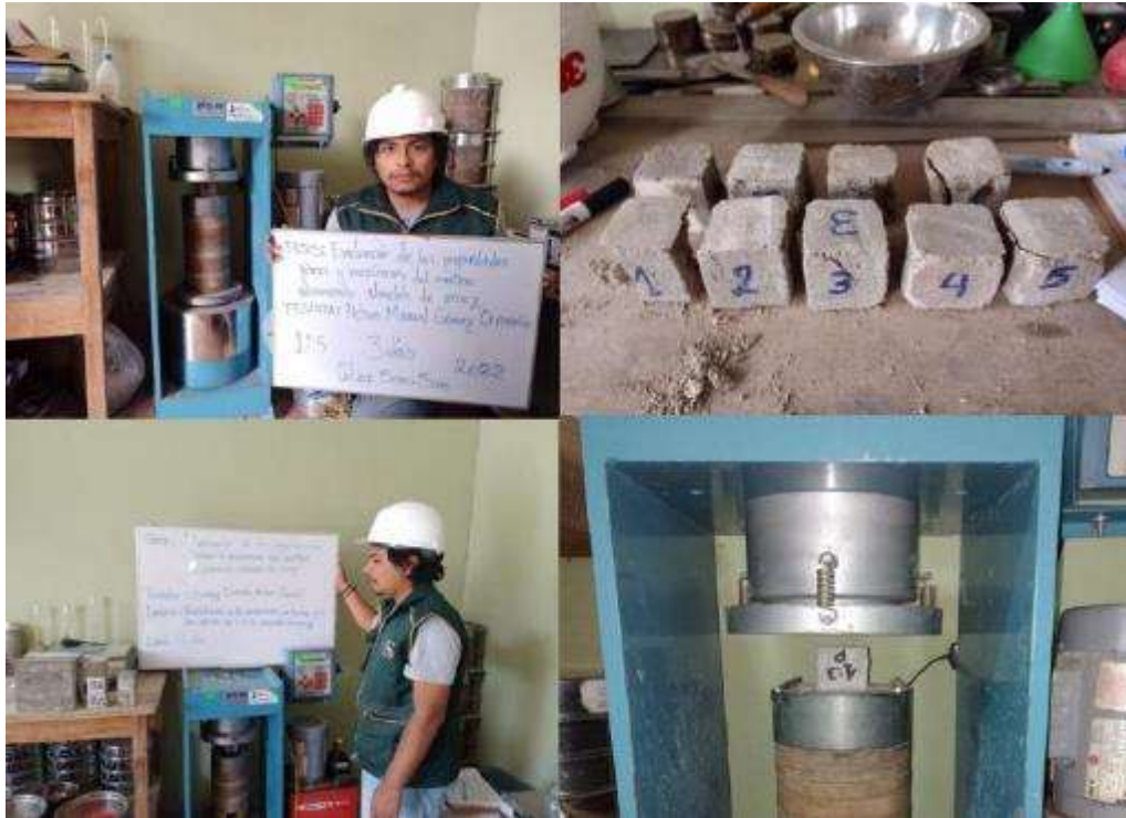
Resistencia a compresión del mortero en cubos de 50 mm de lado
