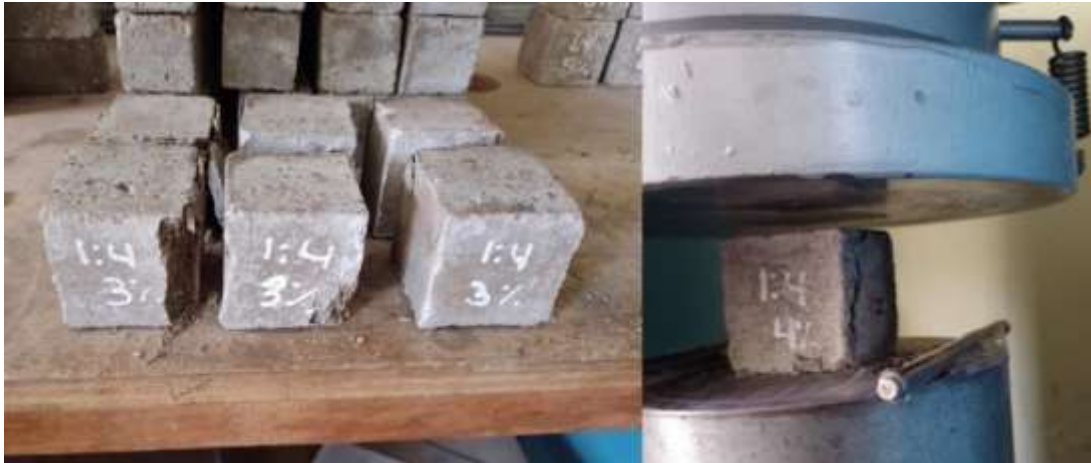
Fig. 37. Ensayo a la compresión de cubos.
