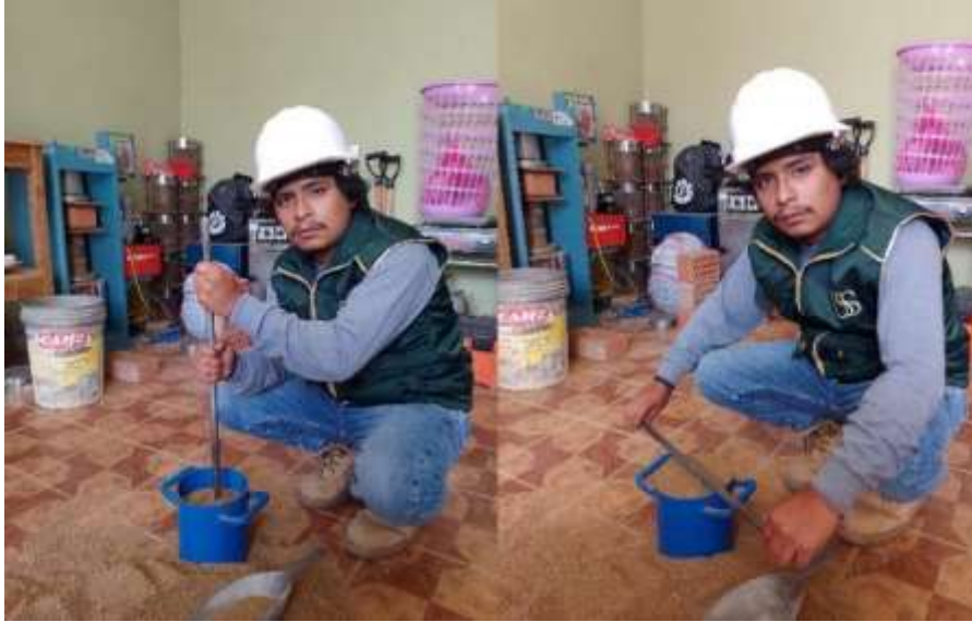
Fig. 22. Peso unitario compactado.
