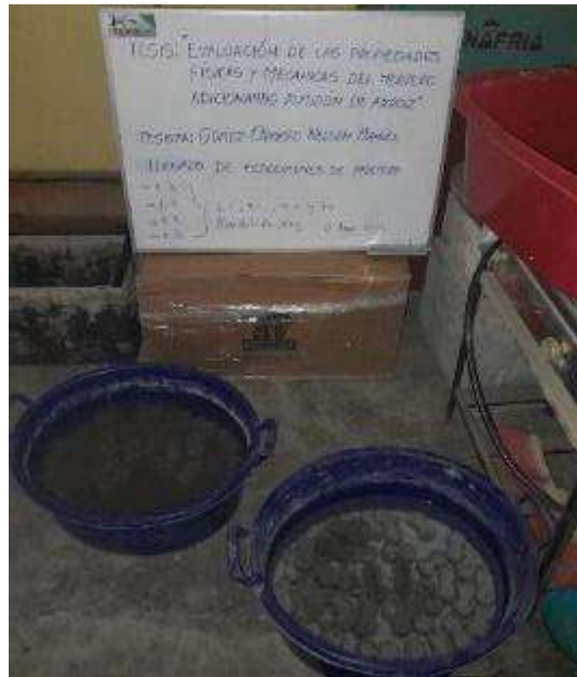
Curado de especímenes de tracción
