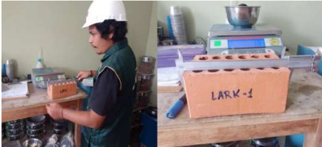
Variación dimensional del ladrillo
