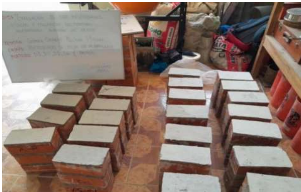
Refrentado de pilas de albañilería
