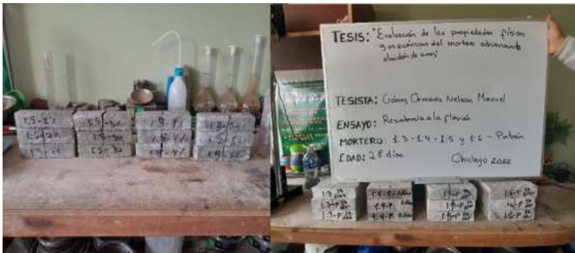
Fig. 38. Vigas de mortero.
