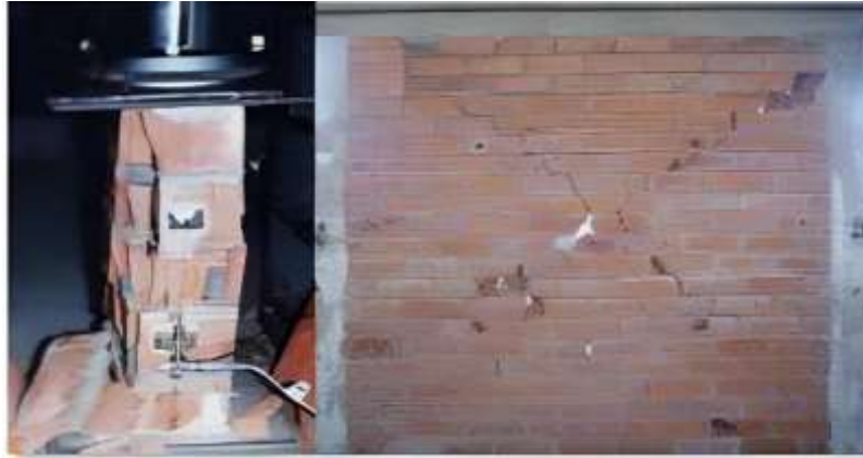
Fig. 9. Falla en muro, elaboradas con albañilería huecas.
