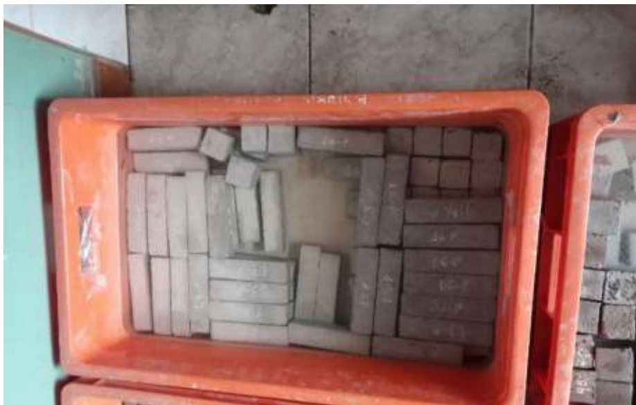
Curado de vigas
