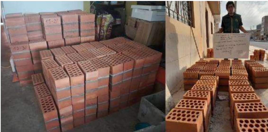
Elaboración de pilas de albañilería
