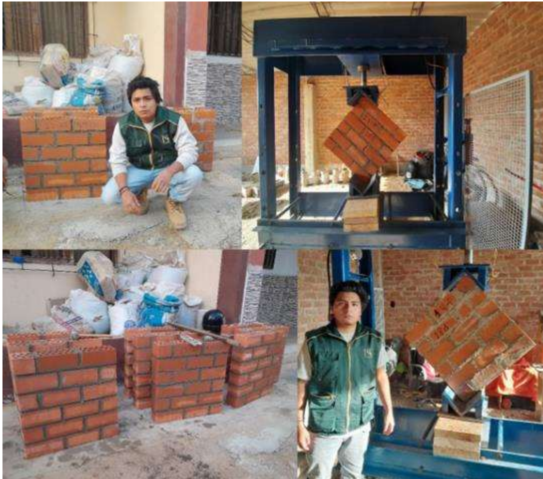
Fig. 44. Resistencia a la compresión diagonal en muretes.
