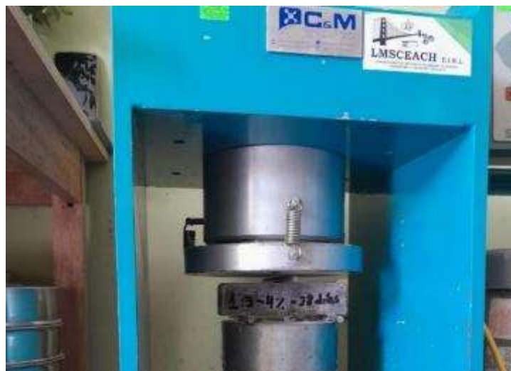
Compresión axial del mortero de vigas
