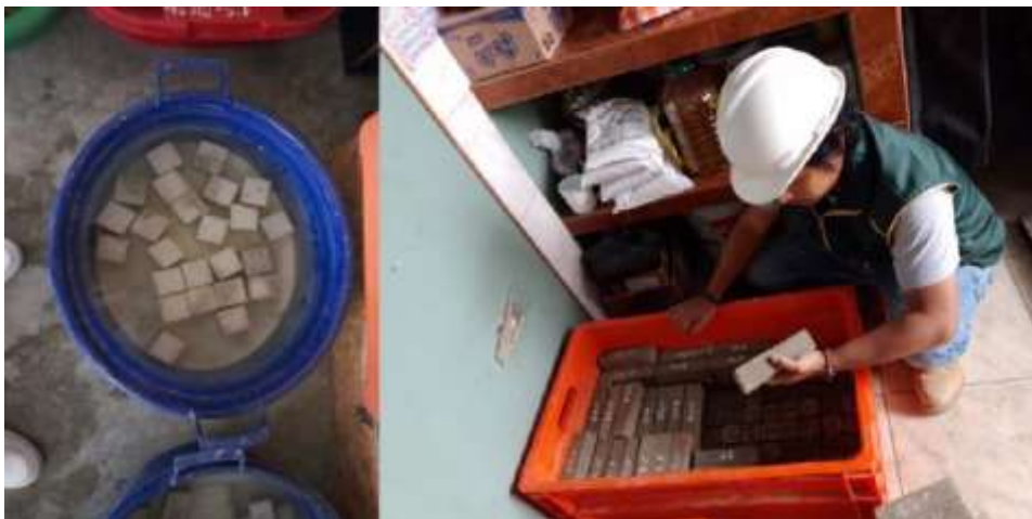
Curado de cubos y vigas
