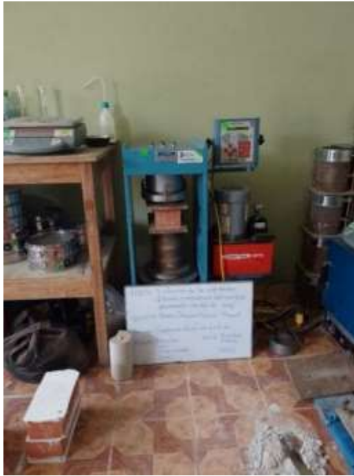
Ensayo de resistencia a compresión axial de las unidades de albañilería 2
