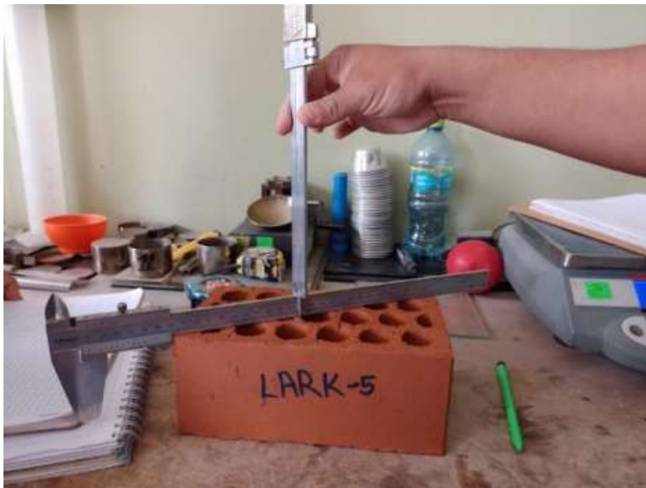
Alabeo a la unidad de albañilería
