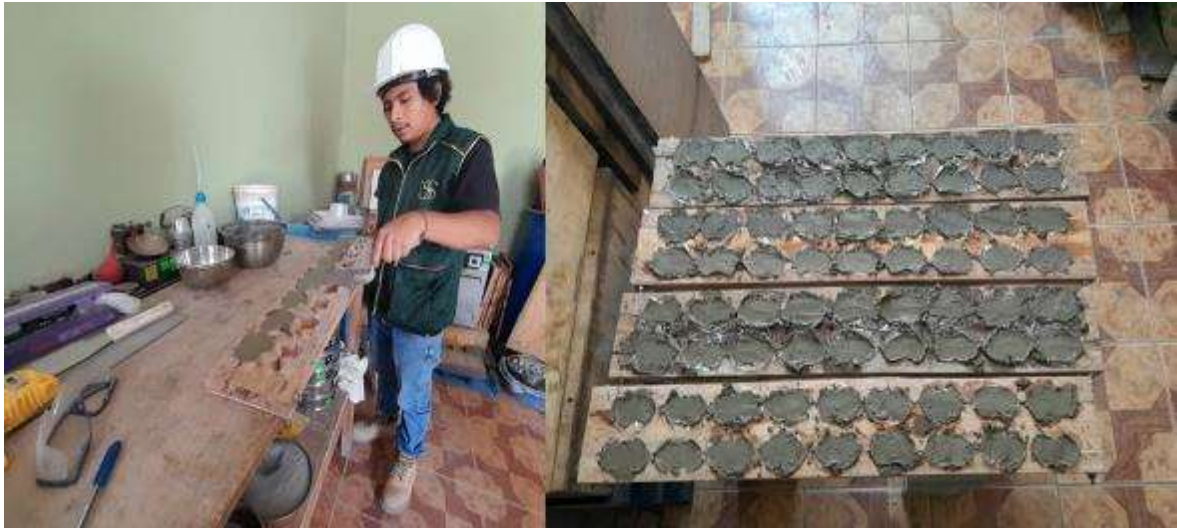
Elaboración de especímenes para tracción
