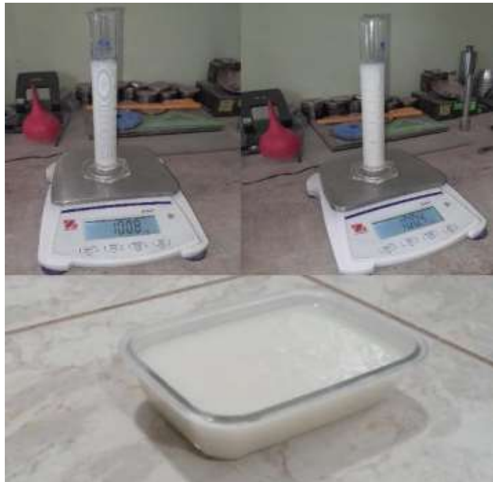
Peso específico del almidón de arroz
