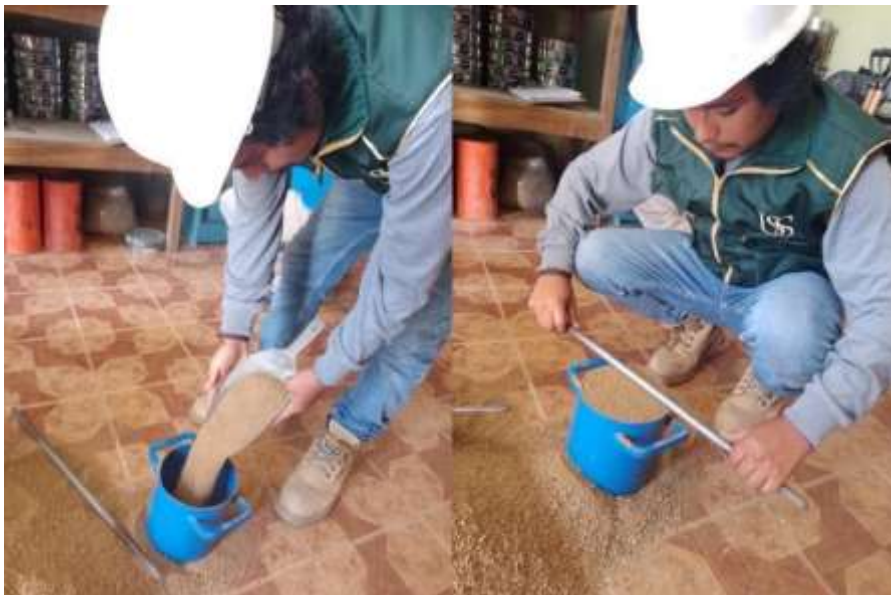
Fig. 21. Peso unitario Suelto.
