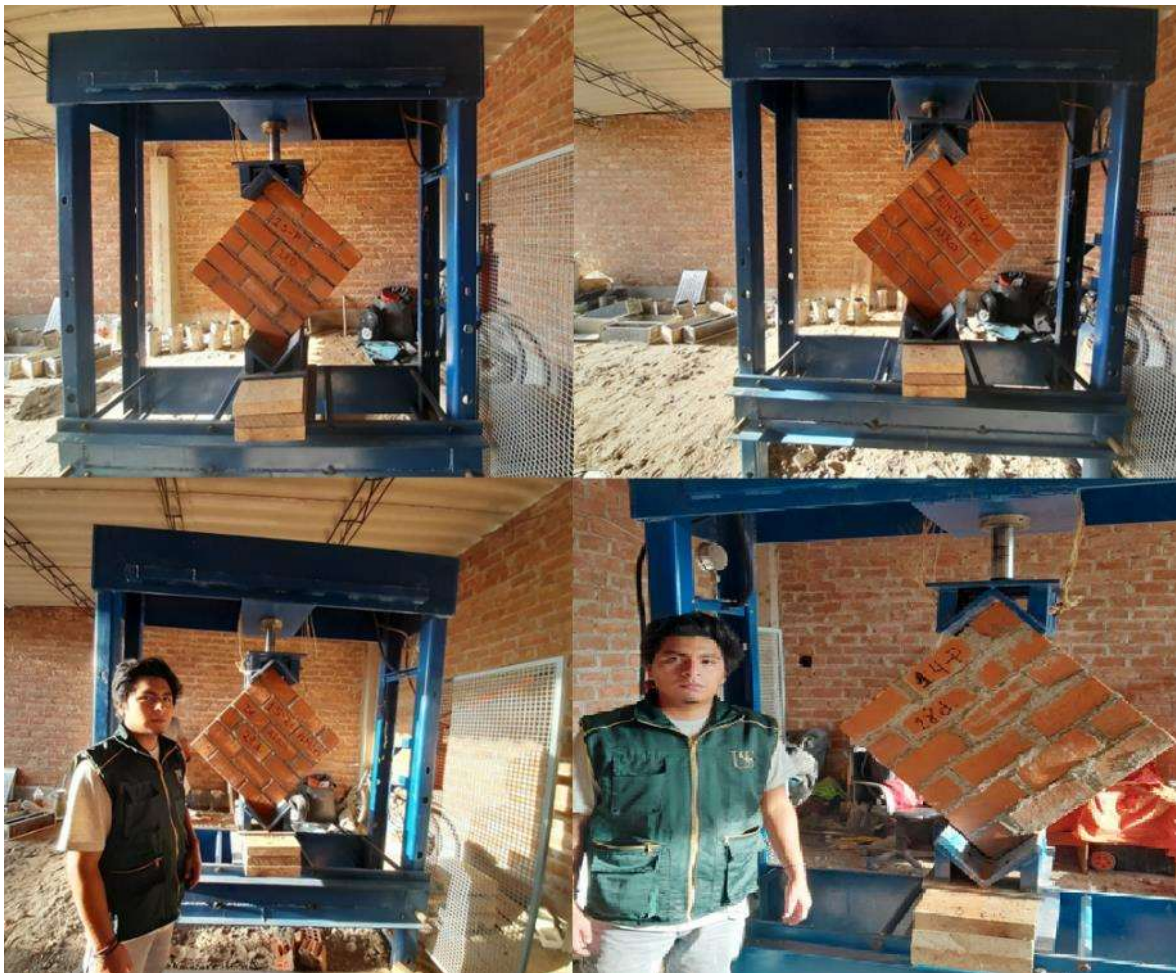
Rotura de muretes de albañilería
