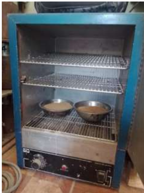
Fig. 24. Contenido de humedad.
