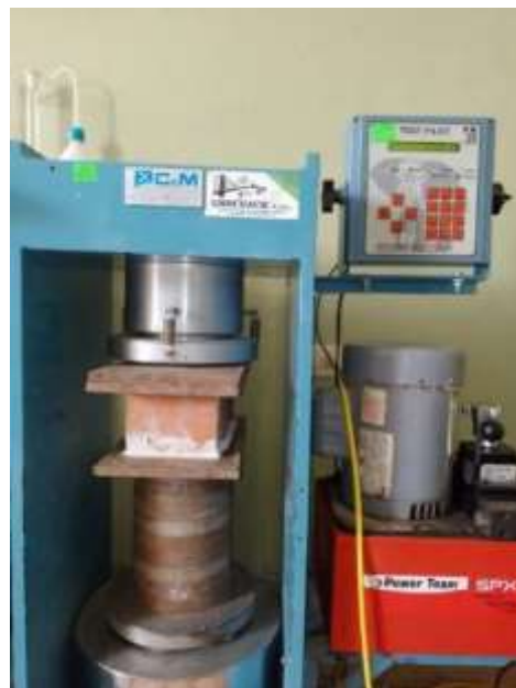
Ensayo de resistencia a compresión axial de las unidades de albañilería
