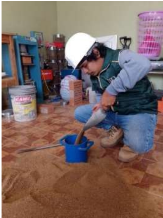
Peso unitario suelto del agregado fino
