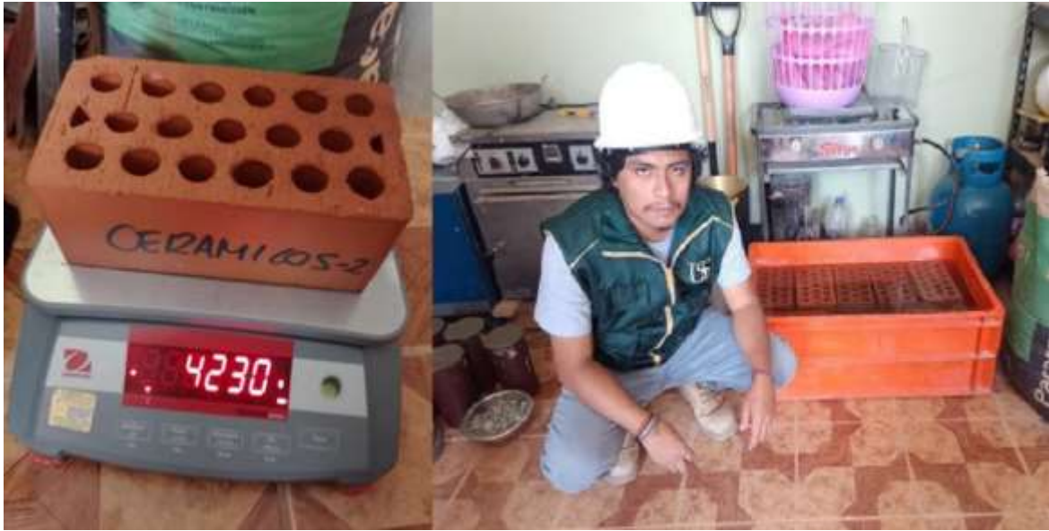
Peso de unidades saturadas para determinar el porcentaje de absorción (%)
