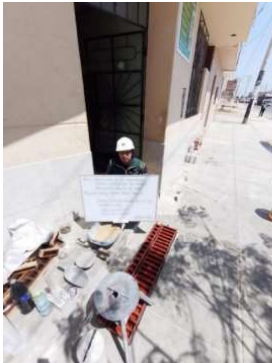
Materiales utilizados para realizar el mortero patrón y mortero adicionando almidón de arroz
