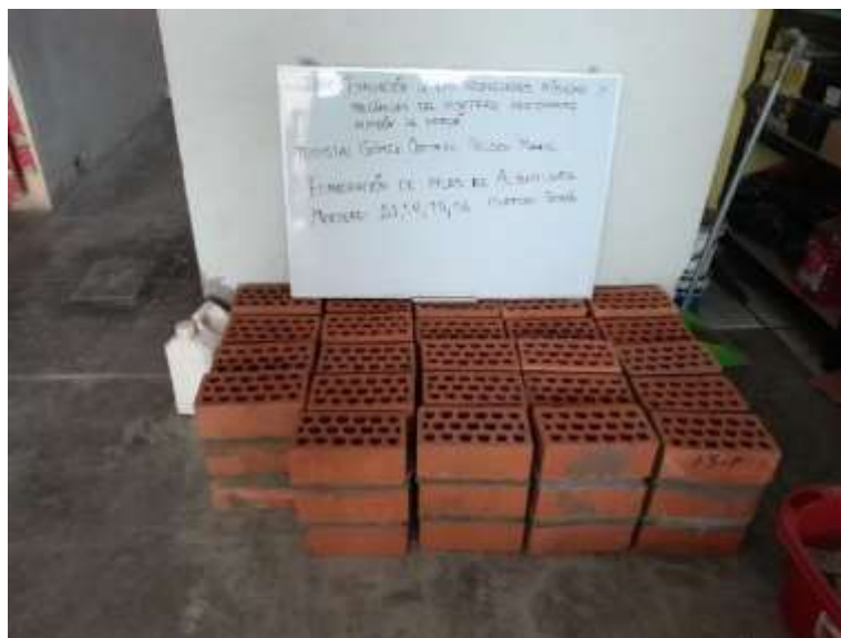
Pilas de albañilería para ensayo de adherencia por flexión
