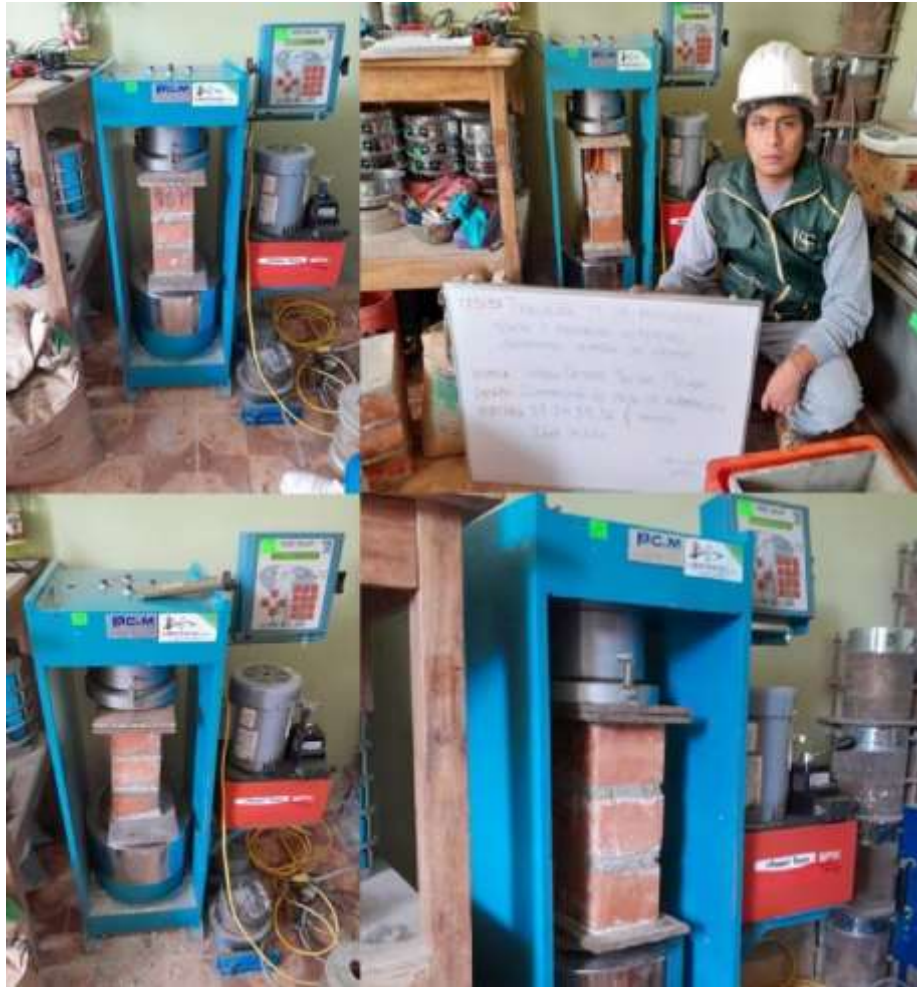
Ensayo de resistencia a compresión axial
