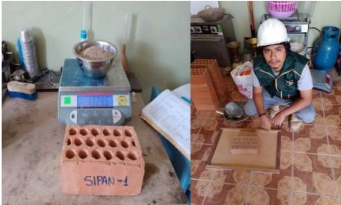
Determinación del porcentaje de vacíos en la unidad de albañilería
