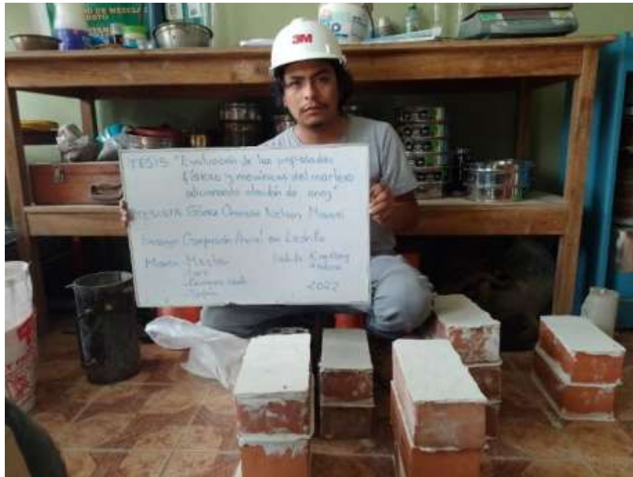
Refrentado de unidades de albañilería
