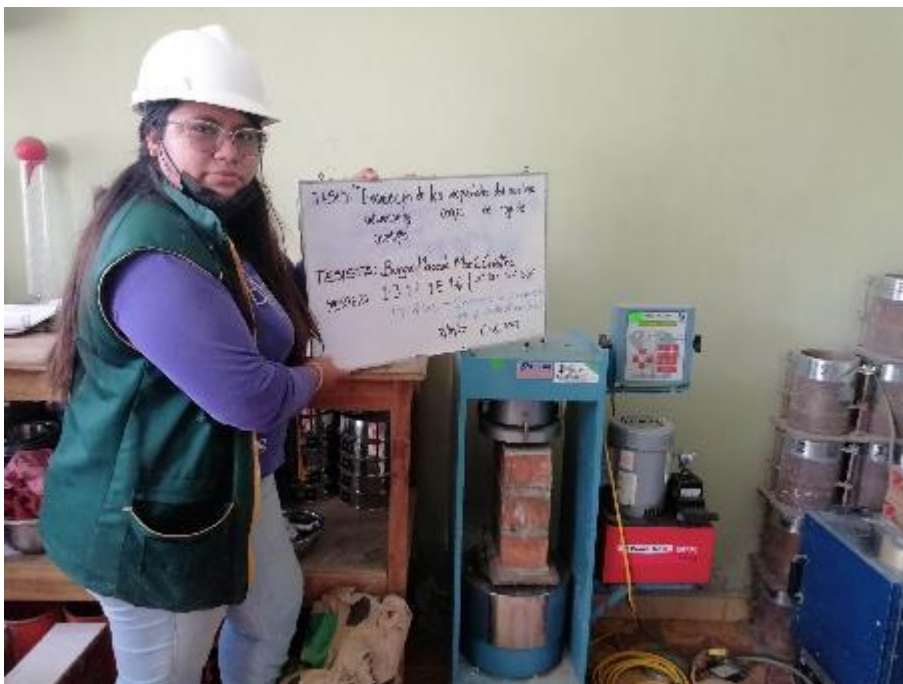
Ensayo de resistencia a la compresión en pilas de albañilería
