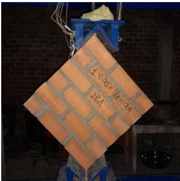
Ensayo de compresión diagonal en muros
