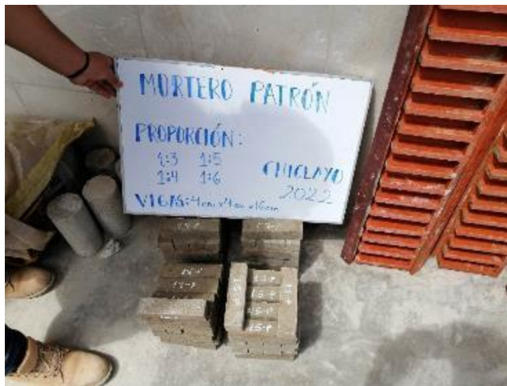
Fig. 35. Vigas de mortero
