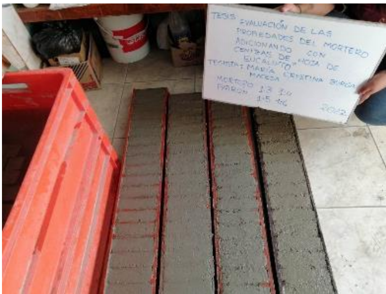
Vaciado de mortero para vigas
