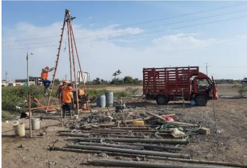
Fig. 12. Equipo para ensayo de penetración estándar.
