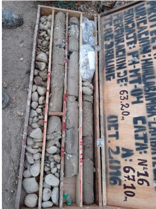
Fig. 13. Muestras obtenidas del ensayo de SPT por medio del tubo Shelby.
