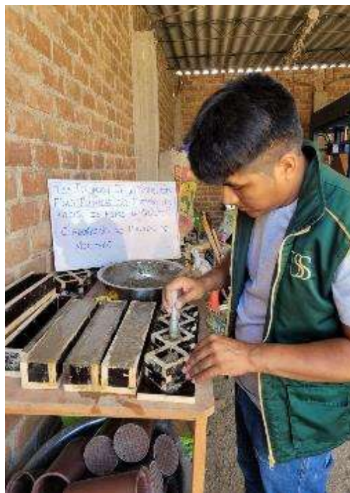
Fig. 11. Elaboración de cubos de mortero de 5 cm de lado
