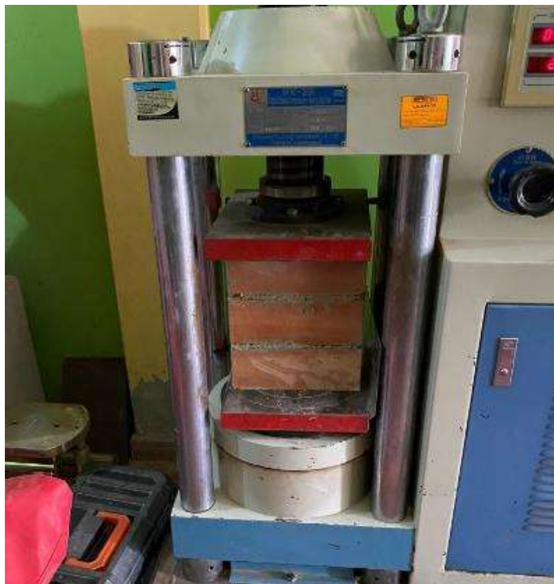
Fig. 17. Ensayo de prisma de albañilería
