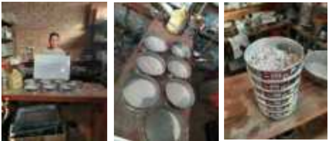
e) Análisis granulométrico por tamices de agregado fino.
