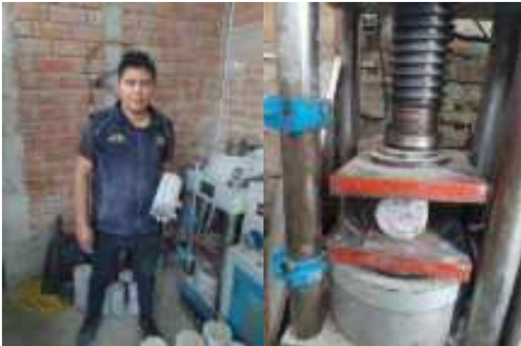
Fig. 33. Ruptura de testigo de ensayo a tracción.
