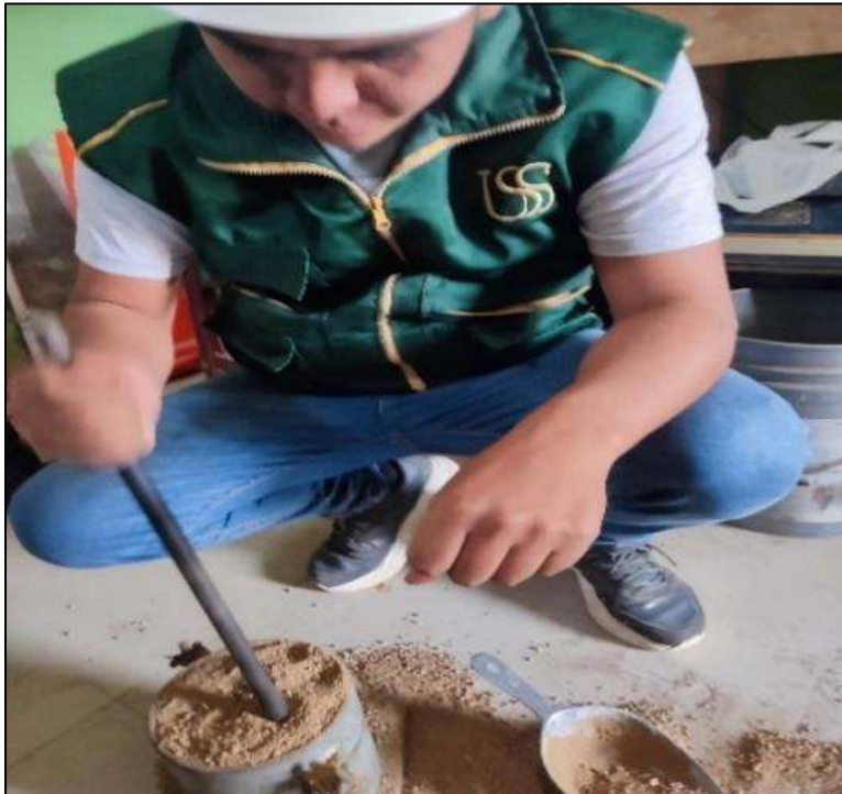
Fig. 17. Peso unitario compactado del agregado fino
