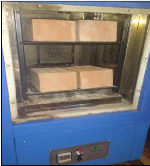
Fig. 24. Unidades puestas al horno por un periodo de un día
