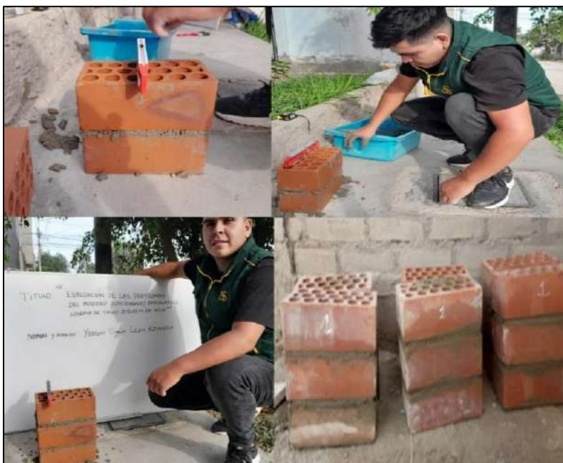
Fig. 35. Construcción de pilas para ser analizadas a las 4 semanas
