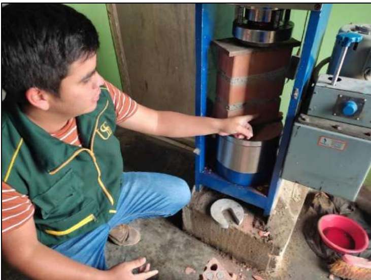
Fig. 39. Ensayo a la compresión en pilas
