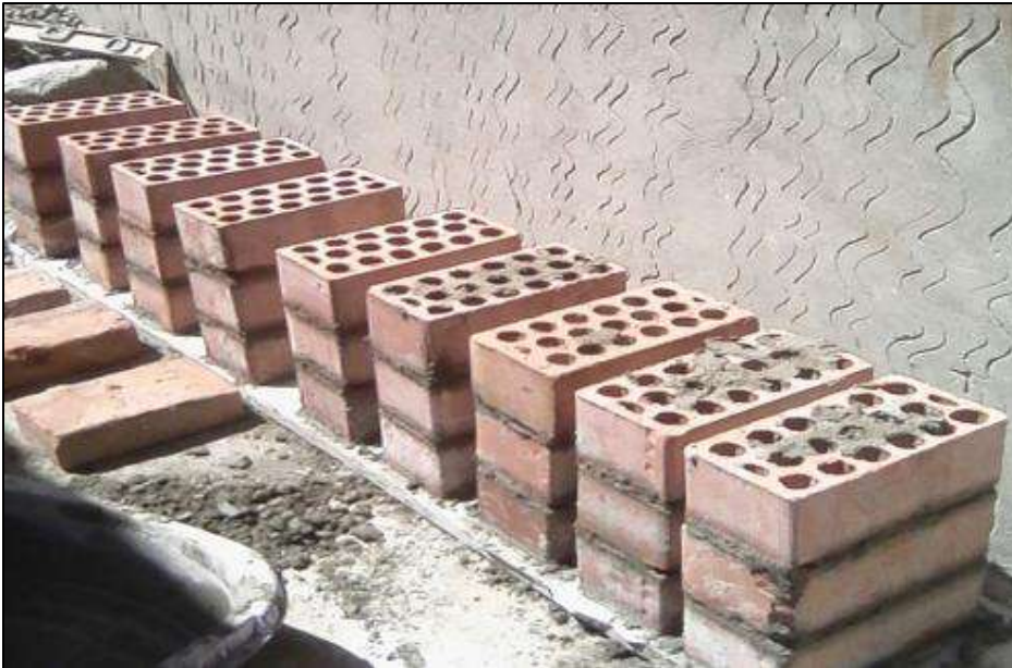
Fig. 36. Pila de albañilería ensayada a flexión a la edad de 4 semanas
