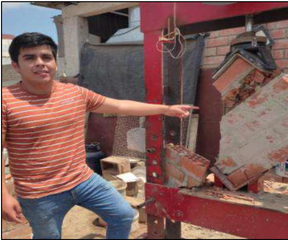
Fig. 41. Ensayo de compresión diagonal en murete de albañilería
