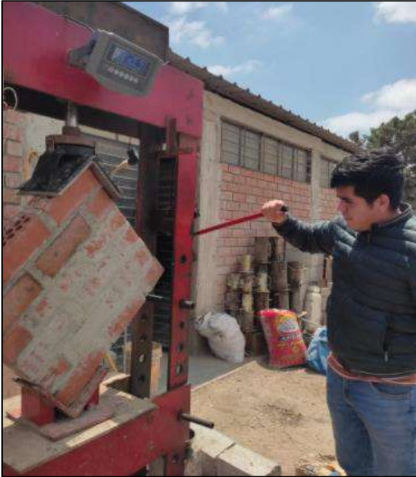
Rotura de muretes de albañilería
