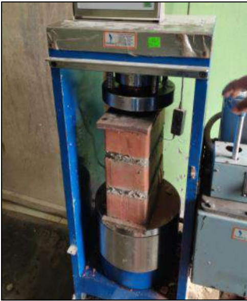
Fig. 38. Análisis a compresión axial en pilas de albañilería
