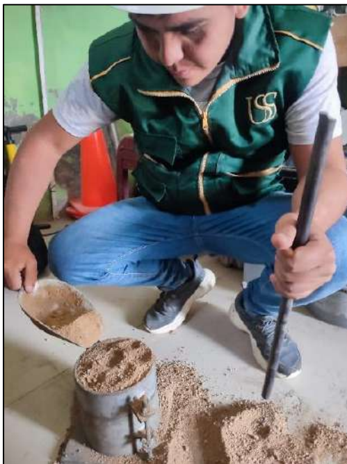
Fig. 18. Ensayo de peso unitario suelto del agregado fino
