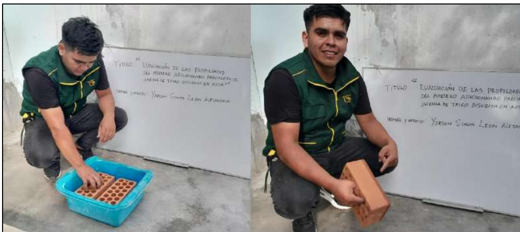
Fig. 25. Ensayo de succión
