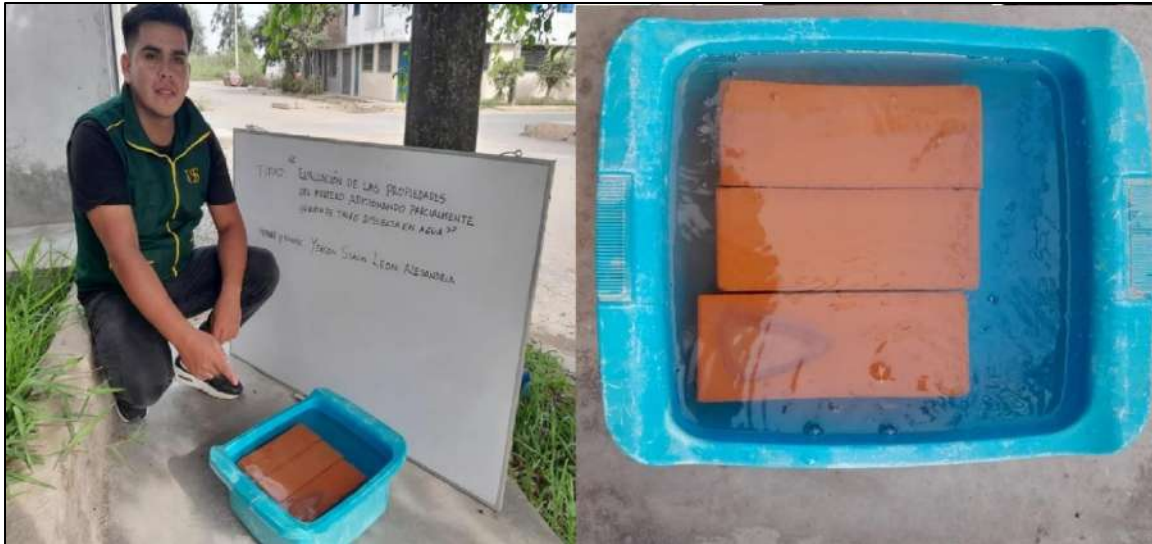
Fig. 23. Ensayo de absorción
