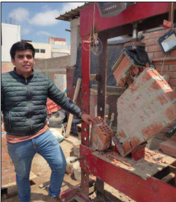
Roturas escalonadas y diagonales en muretes
