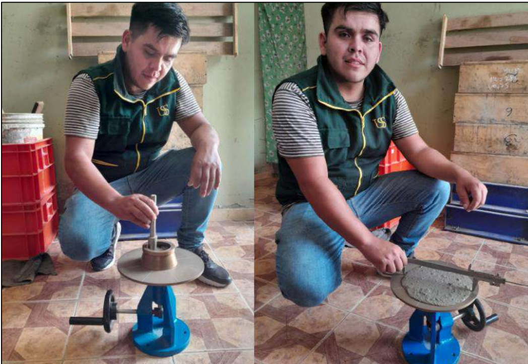
Fig. 29. Fluidez del mortero patrón
