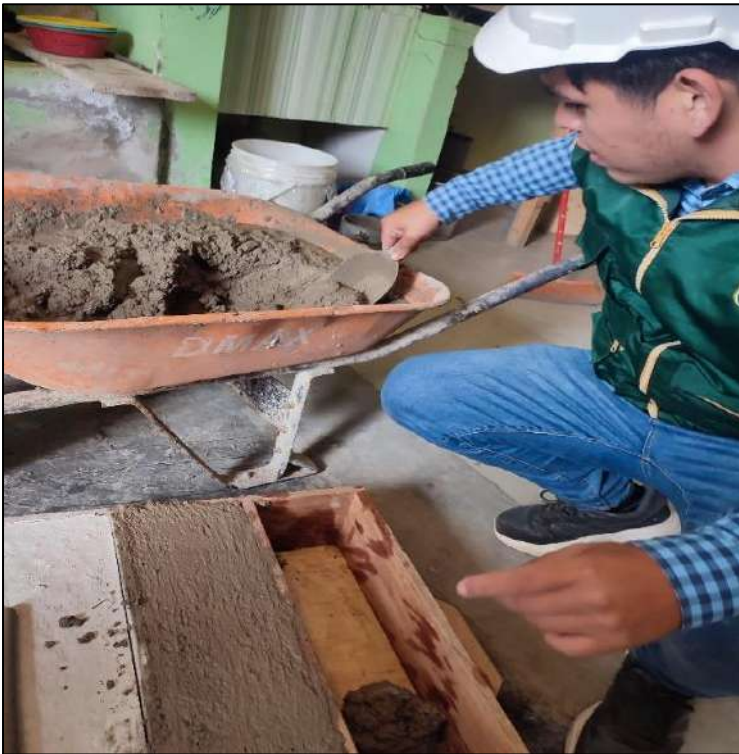
Elaboración de especímenes de mortero
