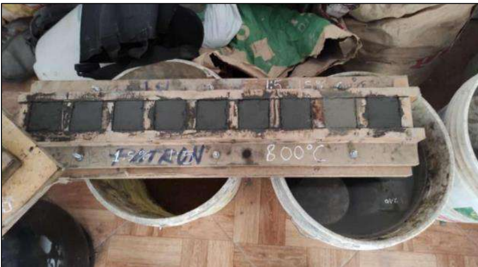
Elaboración de especímenes de mortero
