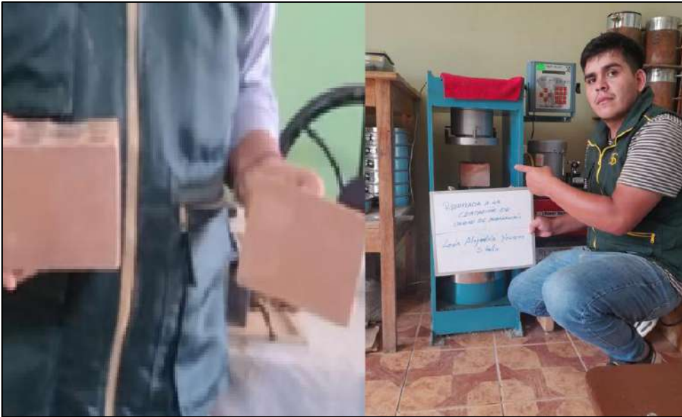
Fig. 27. Compresión de unidad de albañilería
