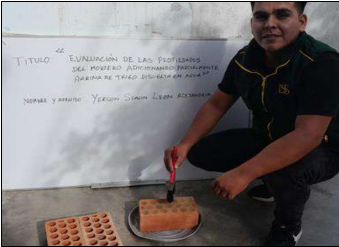
Fig. 22. Limpieza del ladrillo para ser llenado con arena sus espacios vacíos
