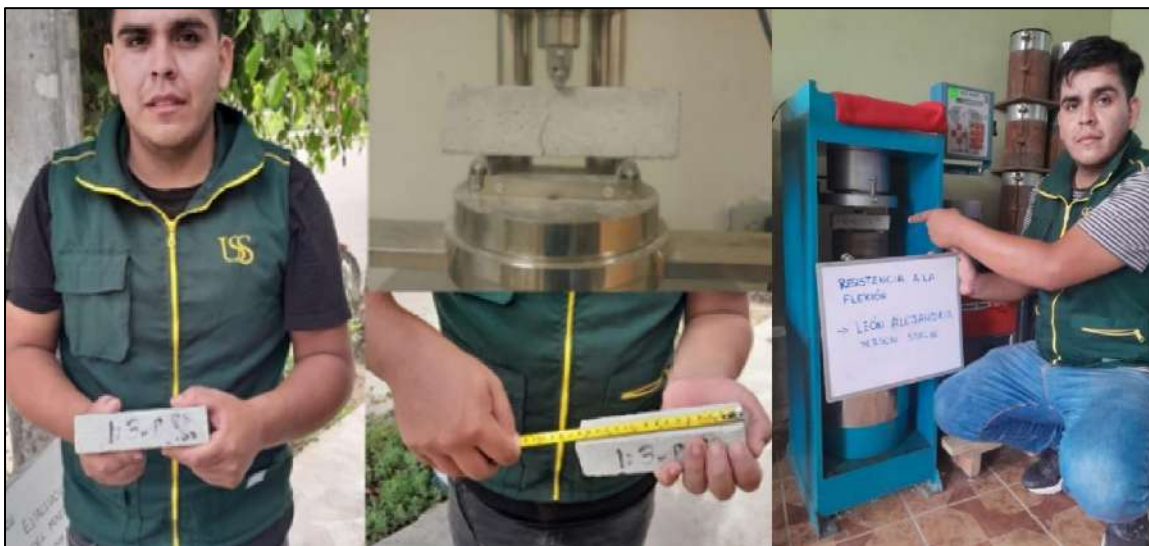
Fig. 33. Resistencia a la flexión en barras de mortero de 40 mm 2 x 160 mm
