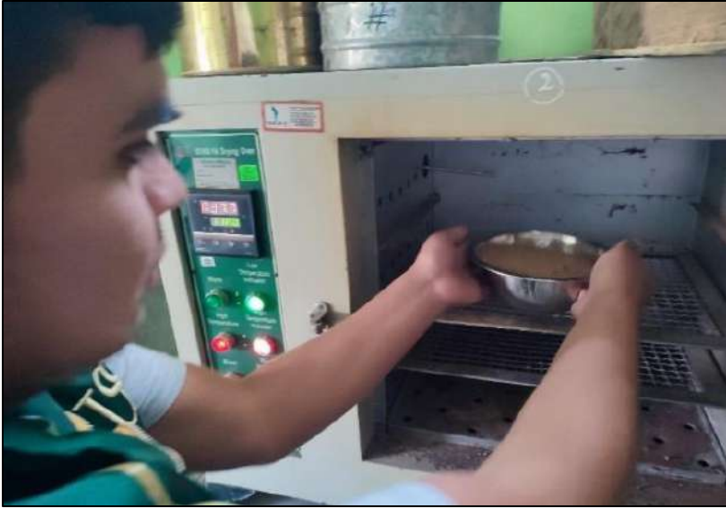
Fig. 20. Muestra puesta al horno por un día para obtener el contenido de humedad
