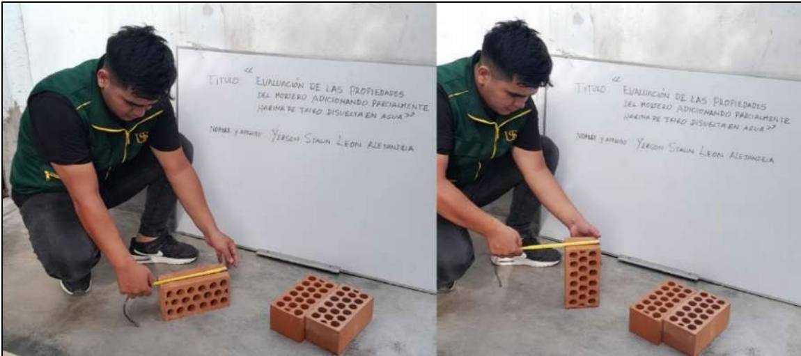
Fig. 21. Dimensiones de las superficies del ladrillo
