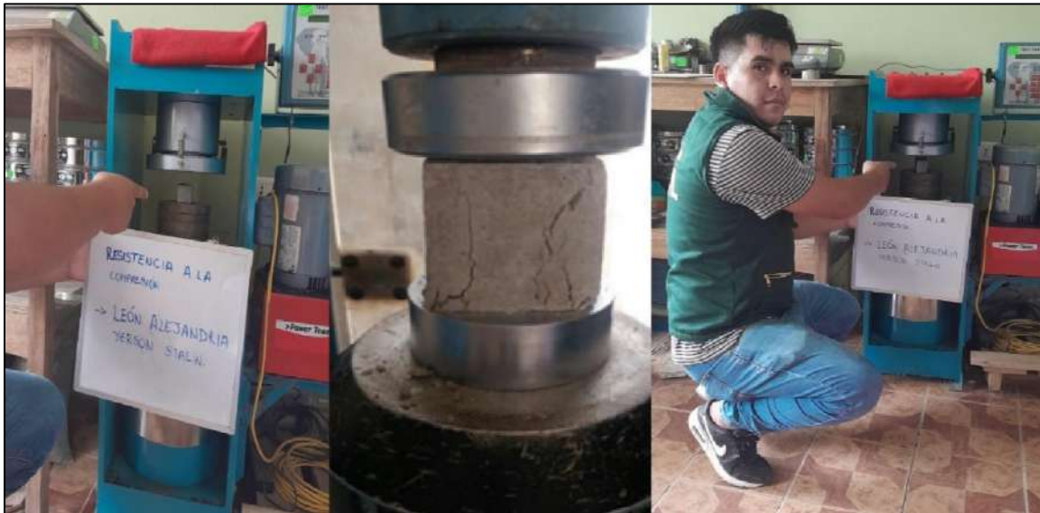
Fig. 32. Análisis a compresión de cubos de mortero de 5 cm de lado
