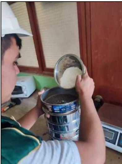
Fig. 14. Dato granulométrico de la harina de trigo
