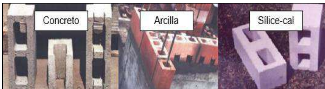
Fig. 5. Unidades de albañilería - Según su composición [47]
