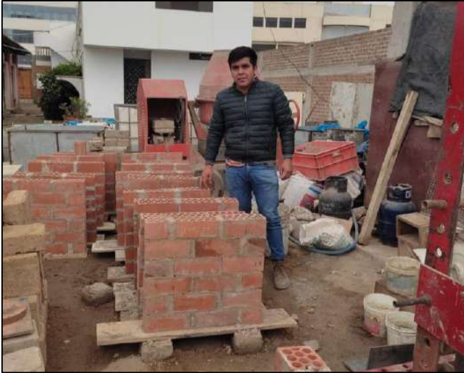
Fig. 40. Elaboración de muretes
