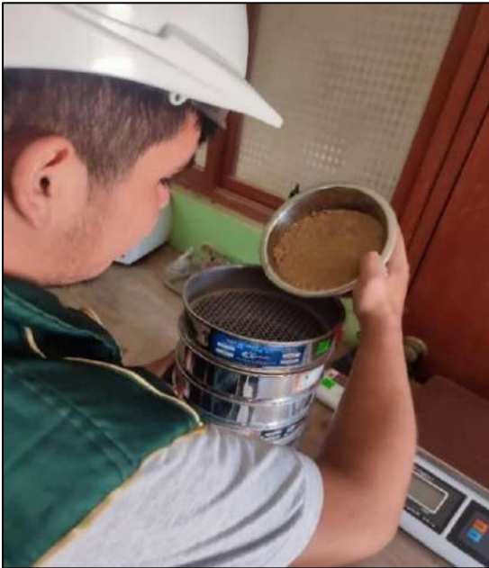
Fig. 16. Dato granulométrico del agregado fino
