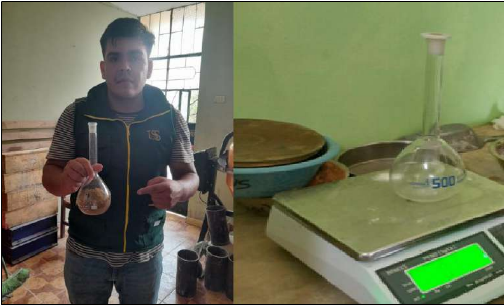
Fig. 19. Peso específico y absorción del agregado fino
