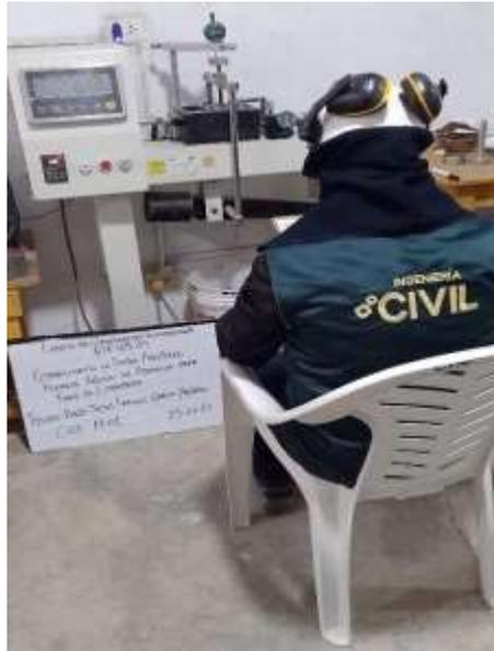
*Nota:* Fotografía tomada en laboratorio, ensayo de Consolidación Unidimensional y Corte Directo.
