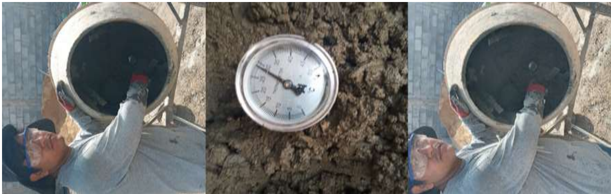
Fig. 7. Prueba de Temperatura de la mezcla del concreto
