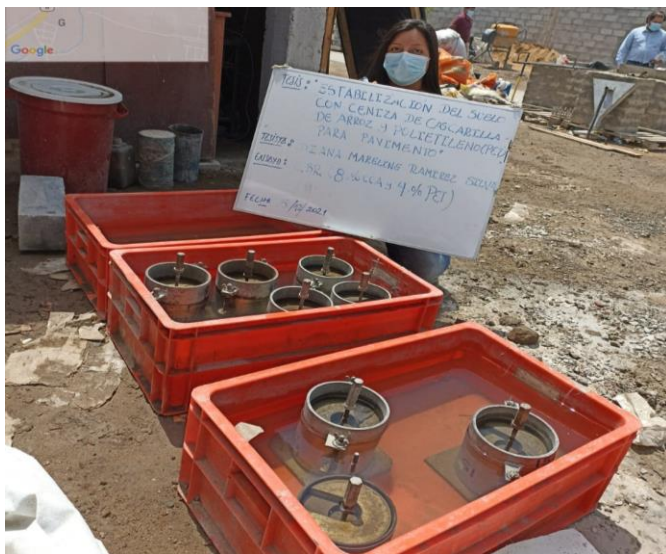
Fig. 22. Muestras sumergidas al agua por 4 días
