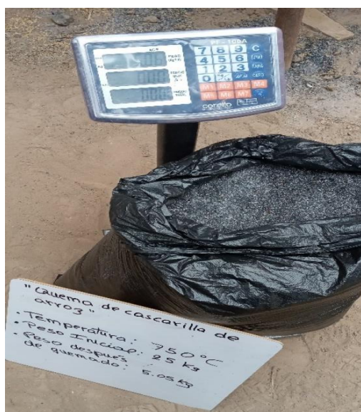
Fig. 8. Quemado la CCA a la T=750\text{ }^{\circ}\text{C}
