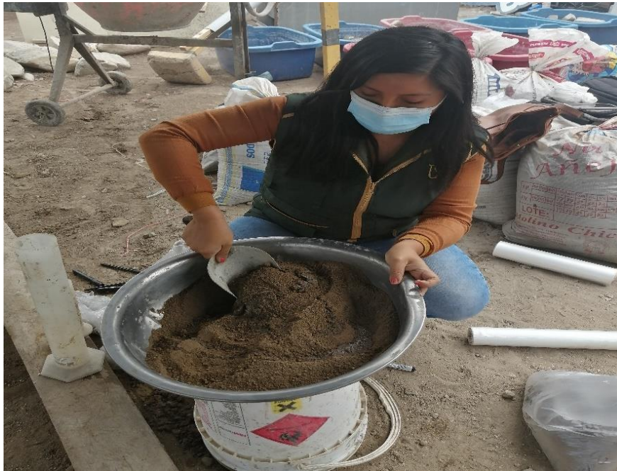
Anexo: Mezcla de los materiales para el ensayo de CBR
