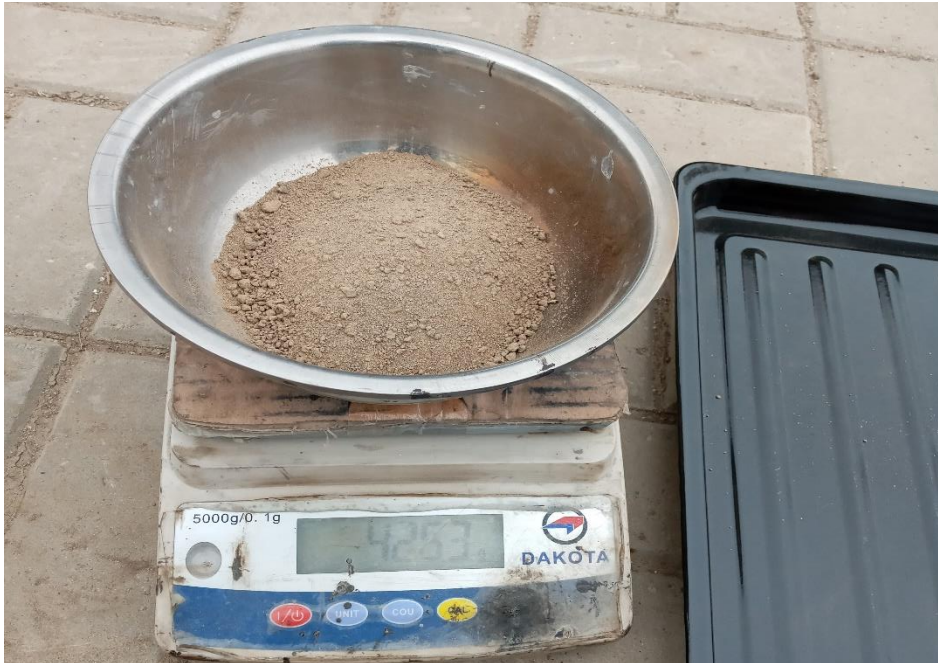
Anexo: Muestra para contenido de humedad
