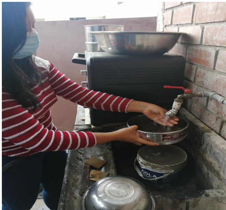
Anexo: Lavado de la muestra por la malla N°200
