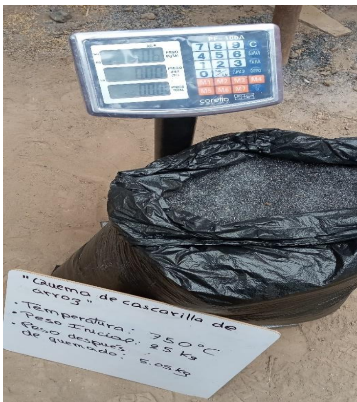
Anexo: Peso de la CCA calcinada a T=750^{\circ}\text{C}
