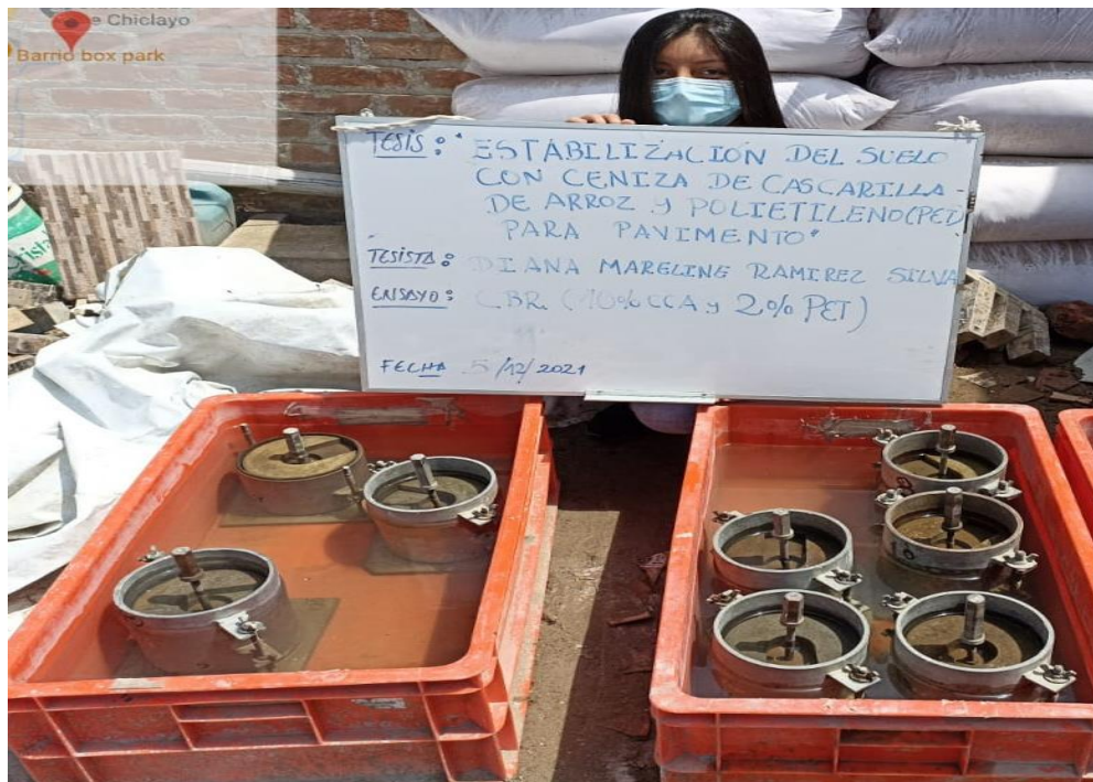
Anexo: Ensayo de CBR con la combinación de C-03:10%CCA:2%PET
