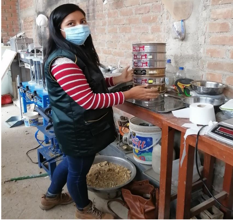
Anexo: Granulometría por tamizado de las muestras
