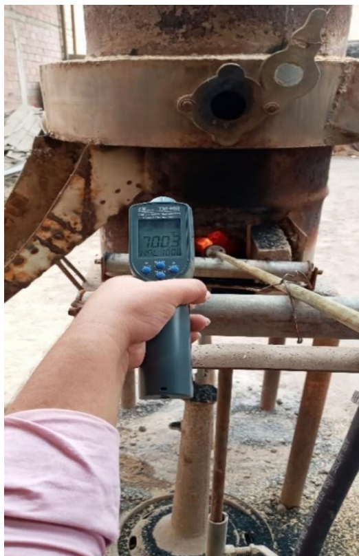
Fig. 5. Calcinación de CCA, T= 700^{\circ}\text{C}
