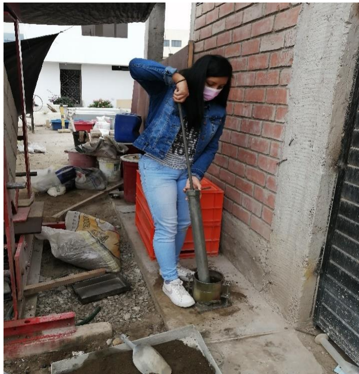
Anexo: Compactación para el ensayo de Proctor Modificado.
