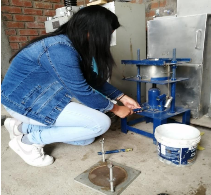
Anexo: Extracción de la muestra de Proctor Modificado
