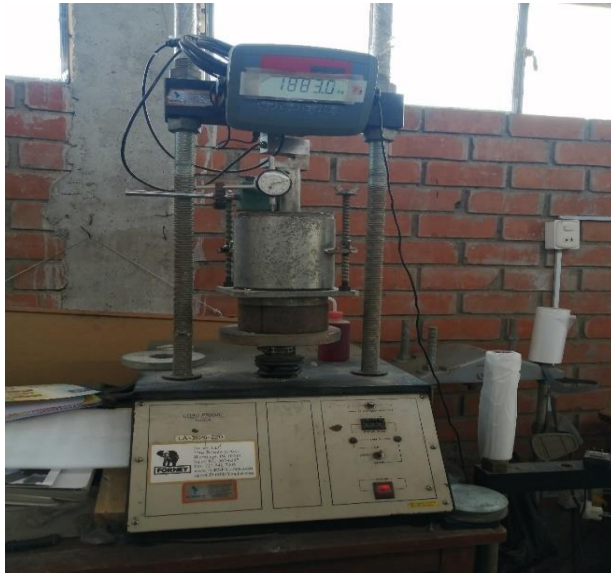
Fig. 21. Ensayo de CBR a la muestra de suelo
