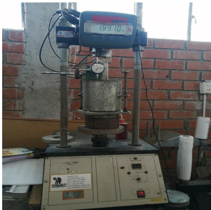
Anexo: Ensayo de CBR de las muestras.
