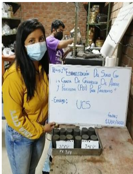
Fig. 18. Probetas listas para el Ensayo de UCS
