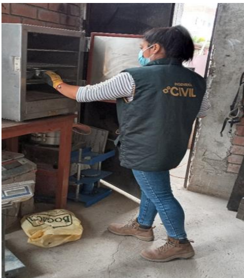
Fig. 12. Colocación de los especímenes al horno.
