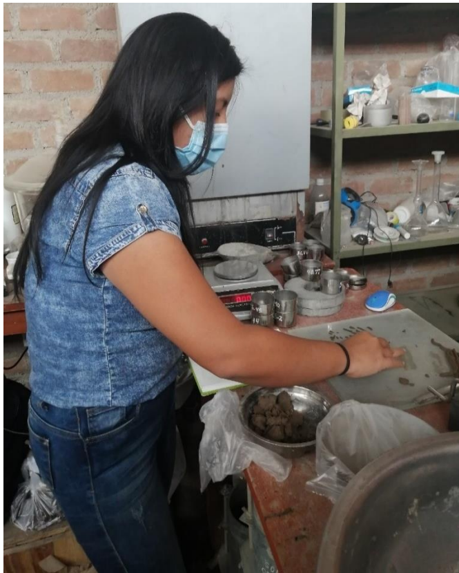
Fig. 14. Ensayo de Limite Plástico
