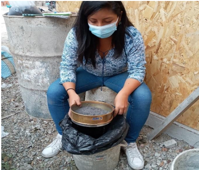
Fig. 10. Tamizado de la CCA por la malla N° 270
