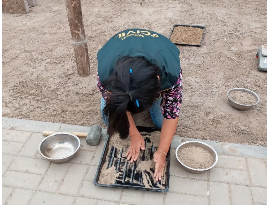
Anexo: Cuarteo para la granulometría por tamizado
