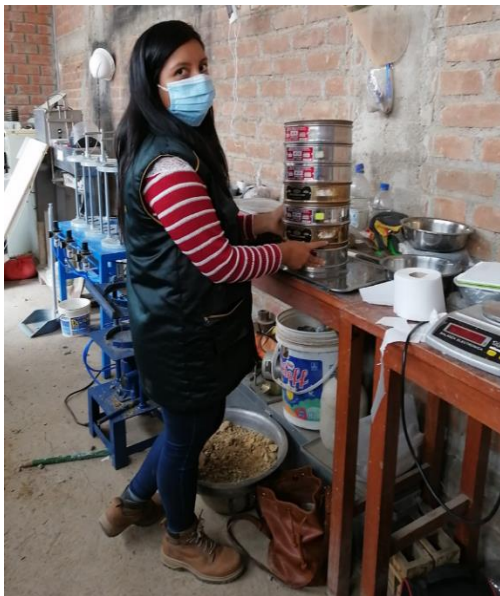
Fig. 16. Tamizado de los especímenes
