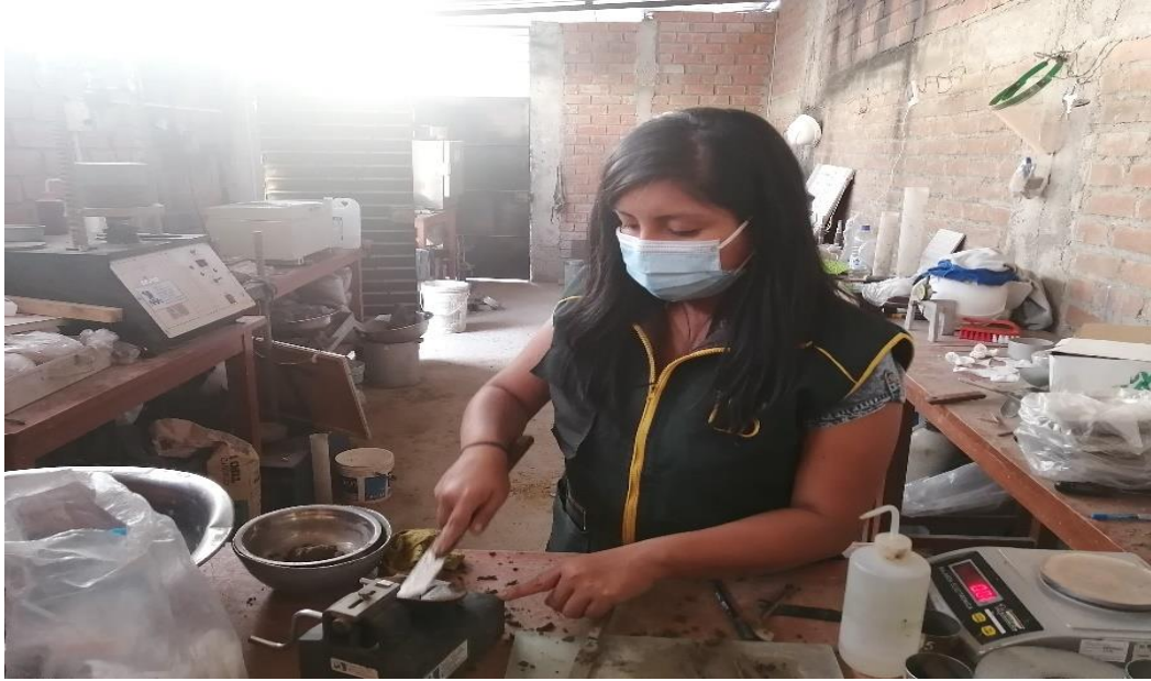
Anexo: Enrrazamiento de la casa grande para el límite liquido
