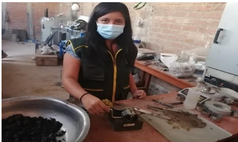
Fig. 13. Ensayo de limite líquido.
