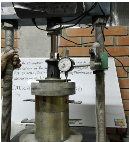
Fig. 17. Ensayo de UCS
