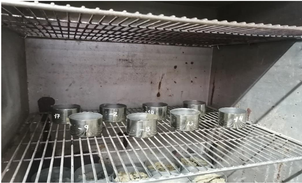
Anexo: Secado de muestras de suelo
