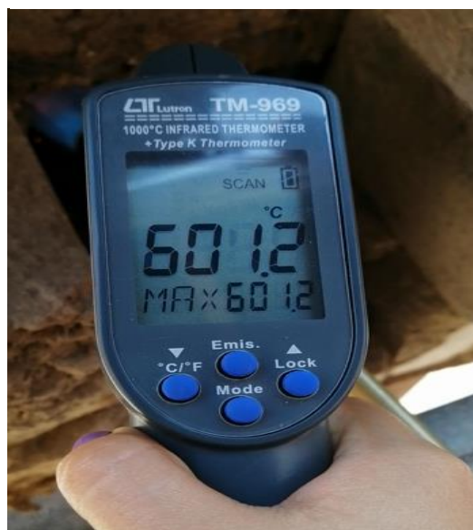
Fig. 6. Calcinación de CCA, T= 600^{\circ}\text{C}
