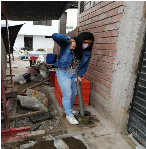
Fig. 20. Compactación de suelo con Proctor Modificado
