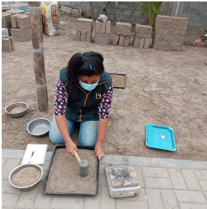
Anexo: Trituración de la muestra para la granulometría
