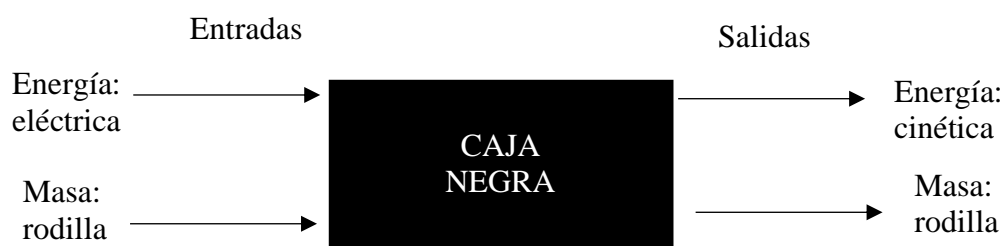
Figura 20. Caja negra del mecanismo de rehabilitación.
