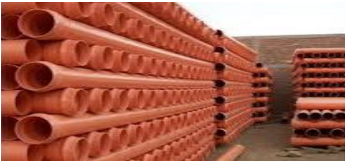
Figura 8. Almacenamiento de los tubos PVC
