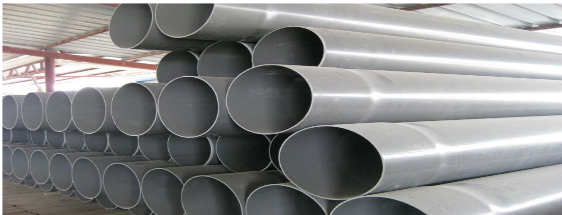
Figura 12. Tuberías para drenaje
