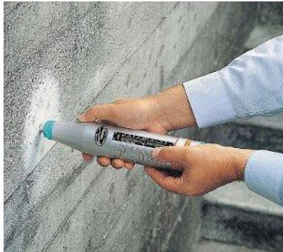
*Figura N° 1. Ensayo de esclerometría.*
