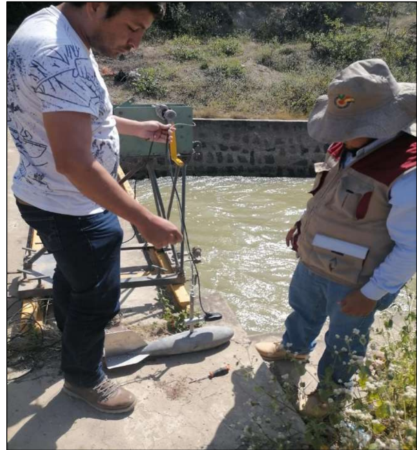
Personal Profesional y Técnico del Proyecto Especial Olmos Tinajones (PEOT), instalando el carro metálico, lastre, escandallo y sensor que permite medir la velocidad, tirante,
