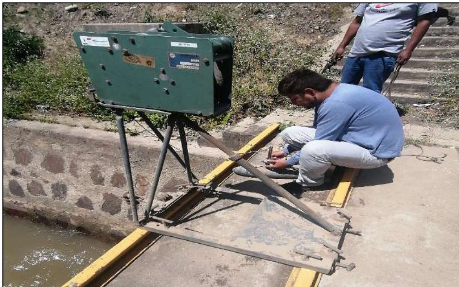
Personal Profesional y Técnico del Proyecto Especial Olmos Tinajones (PEOT), instalando el carro metálico, lastre, escandallo y sensor que permite medir la velocidad, tirante,
