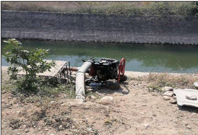
Tuberías de PVC y motobombas, instaladas por pobladores formales e informales en todo el trayecto del canal alimentador del Sistema Tinajones, las cuales extraen en diferentes volúmenes el caudal transportado por el canal Alimentador
