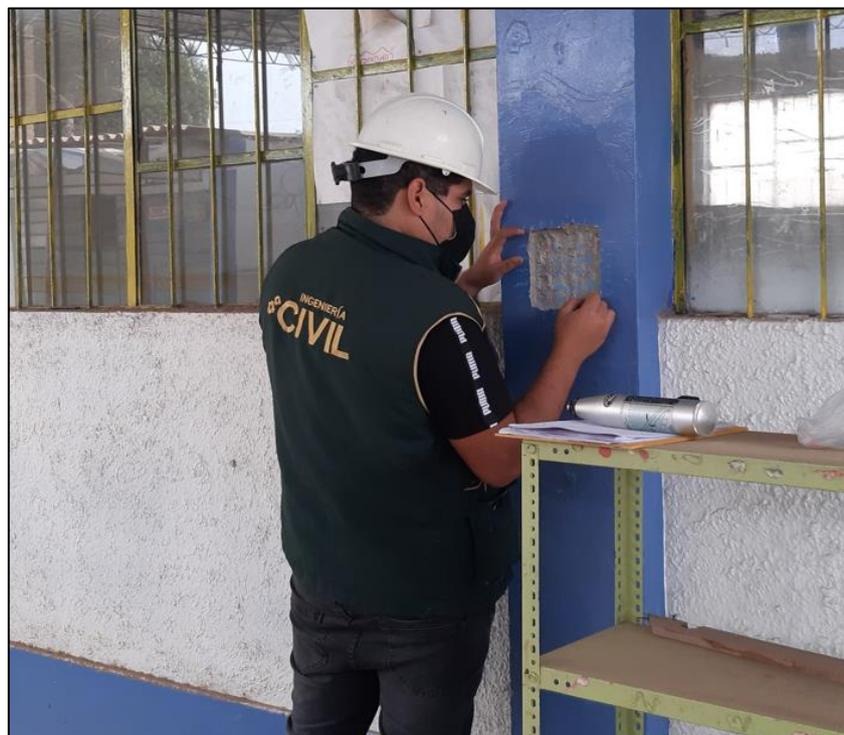
**Figura 46.** *Elaboración de diagrama de puntos de rebote.*
