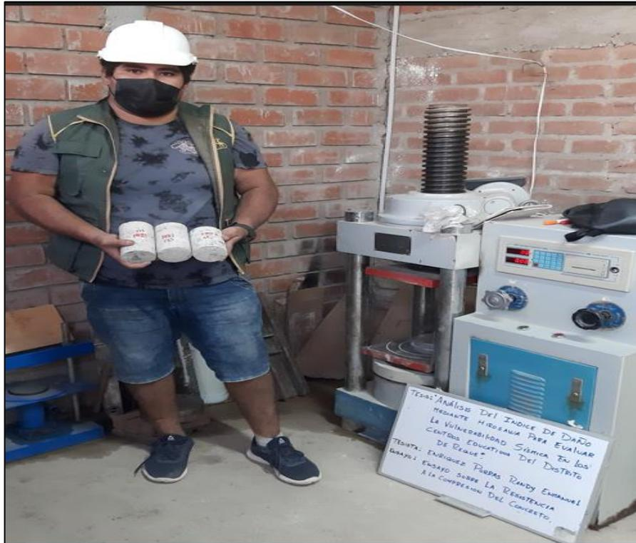
**Figura 43.** Ensayo de resistencia a la compresión del concreto.
