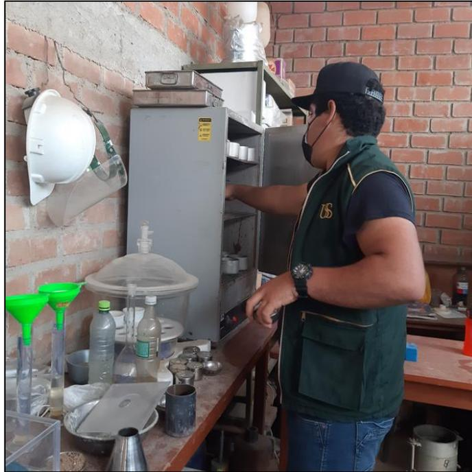
**Figura 26.** *Introduciendo las muestras de suelo al horno.*
