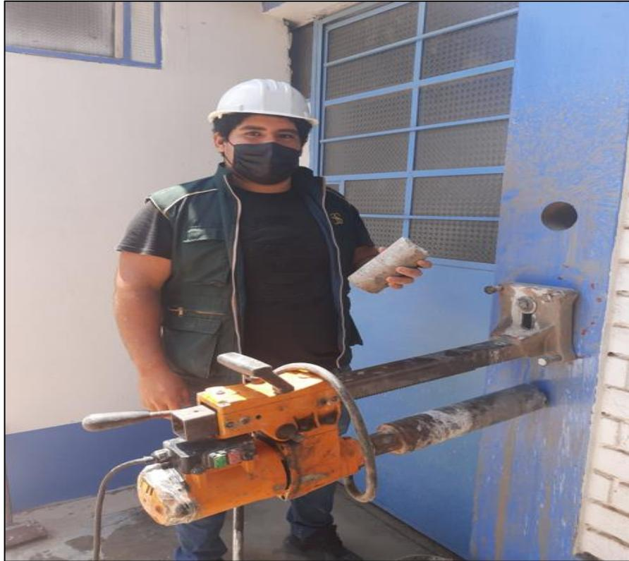
**Figura 41.** *Extracción de diamantina en una columna.*
