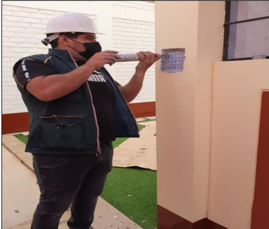
**Figura 47.** *Aplicación de ensayo con Esclerómetro en columna.*
