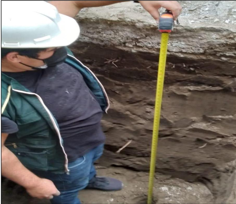
**Figura 33.** *Medición de la profundidad reglamentaria de calicata.*
