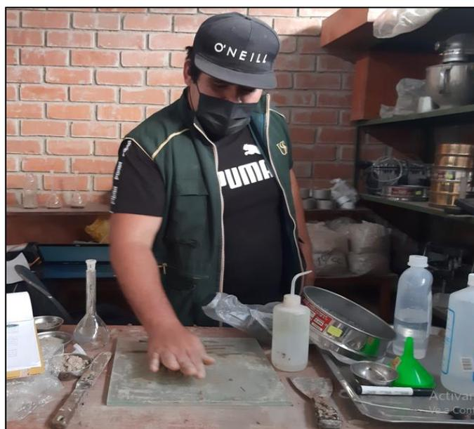
**Figura 30.** Ensayo de Límites de consistencia
