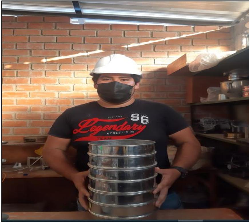
**Figura 37.** *Elaboración de ensayo granulométrico.*
