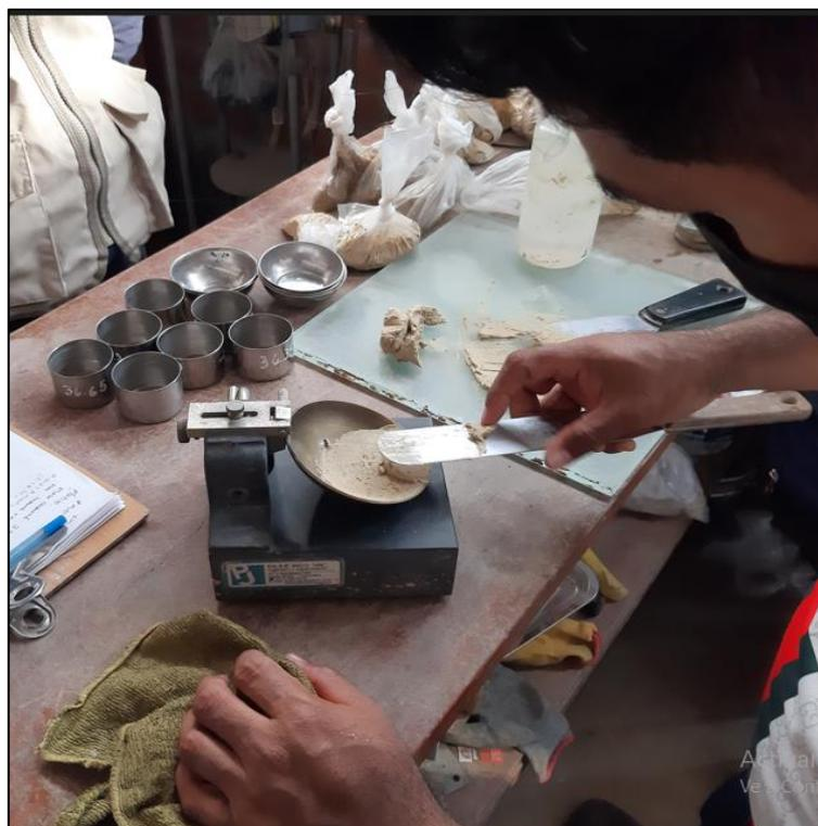
**Figura 29.** *Ensayo de Limites de consistencia*
