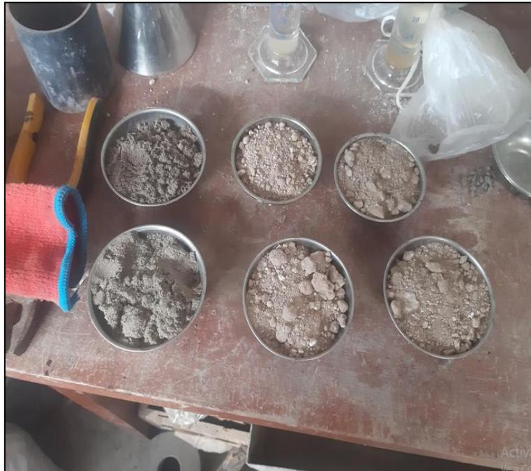
**Figura 28.** *Muestras de suelo recién retiradas del horno.*
