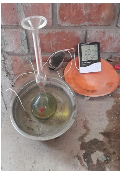
Ensayo de Densidad del Aserrín
