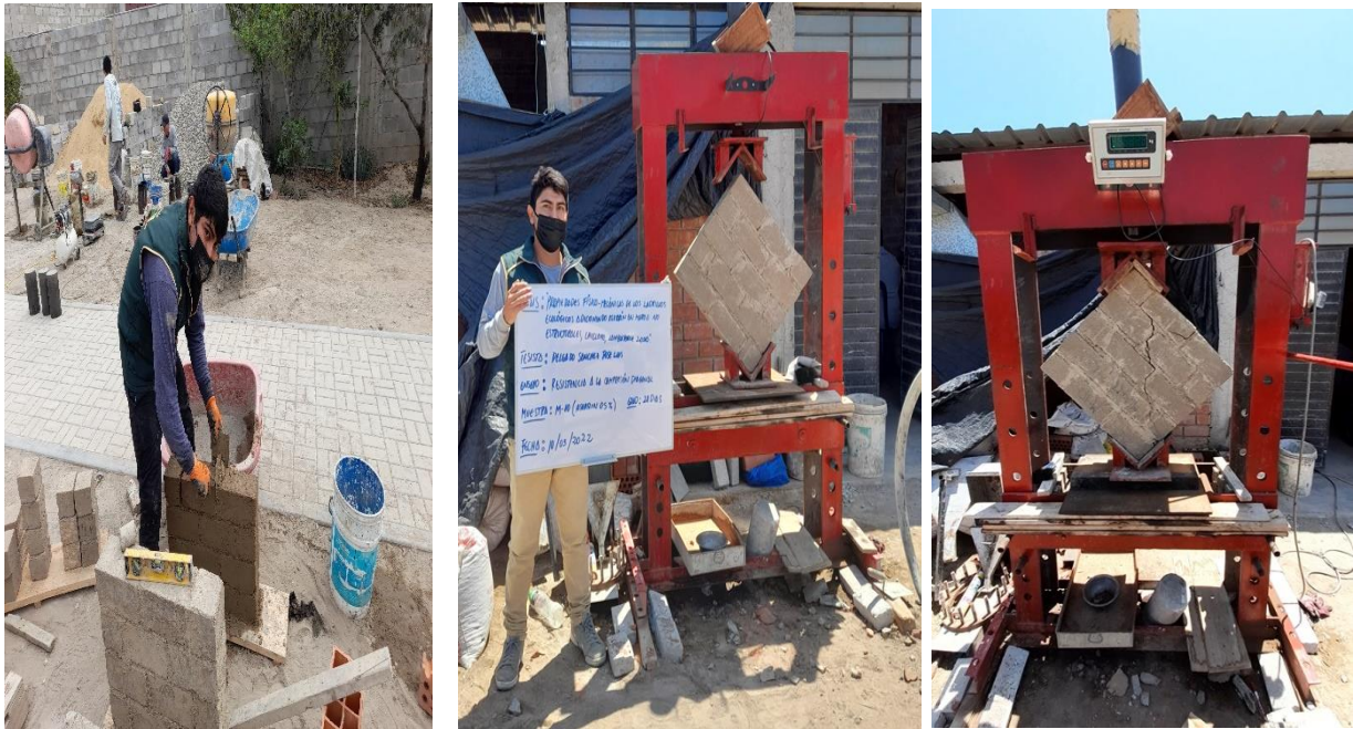
Ensayo de Compresión Diagonal en Muretes de los Ladrillos Ecológicos de Aserrín
