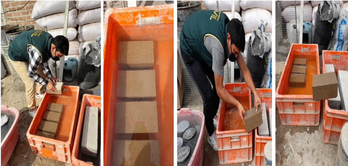
Ensayo de Absorción de los Ladrillos Ecológicos de Aserrín
