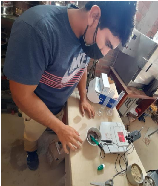
Ensayo del pH del Aserrín
