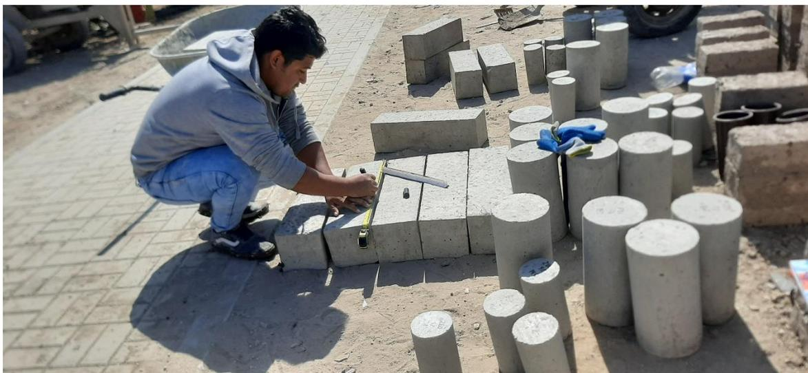
Medición de probetas prismáticas en estado endurecido
