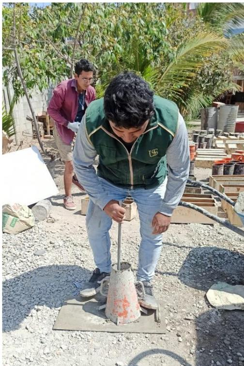
Ensayo de revenimiento en estado fresco
