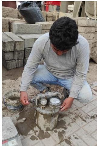
*Figura 22. Ensayo de contenido de aire para el concreto patrón y dosificado con microporoso EVA.*
