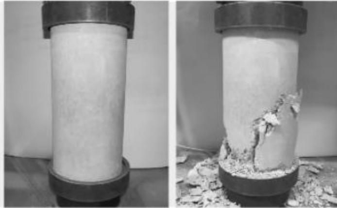
*Figura 6. Prueba de ensayo a la resistencia a la compresión axial.*
