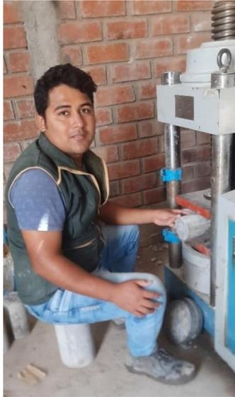
*Figura 25. Ensayo de resistencia a tracción para el concreto patrón y dosificado con microporoso EVA.*
