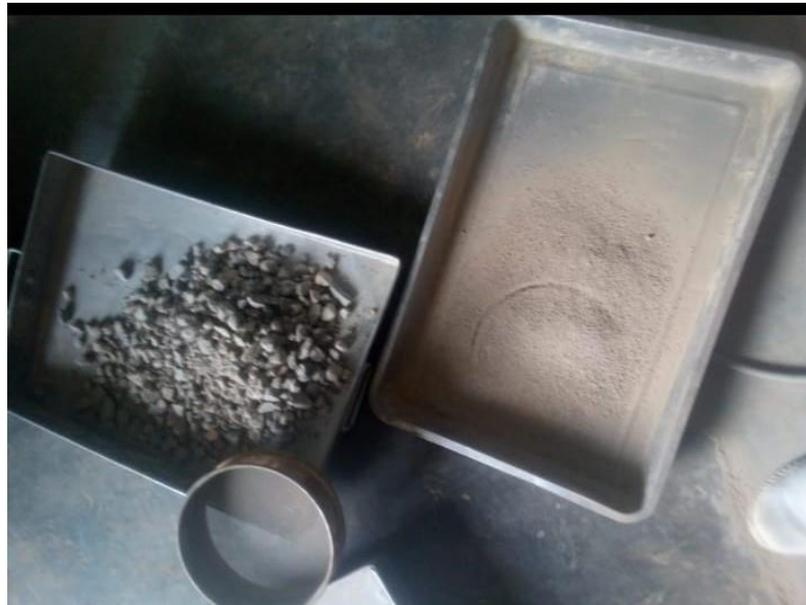
*Figura 19. Proceso de tamizaje para el agregado fino y grueso.*
