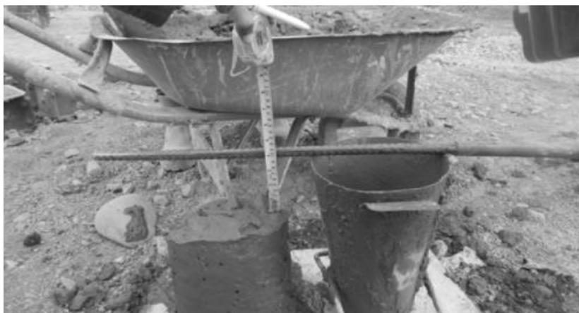
*Figura 5. Prueba de revenimiento del concreto en estado fresco.*
