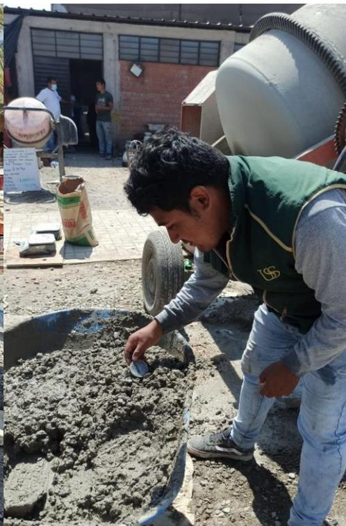
Ensayo de temperatura en estado fresco
