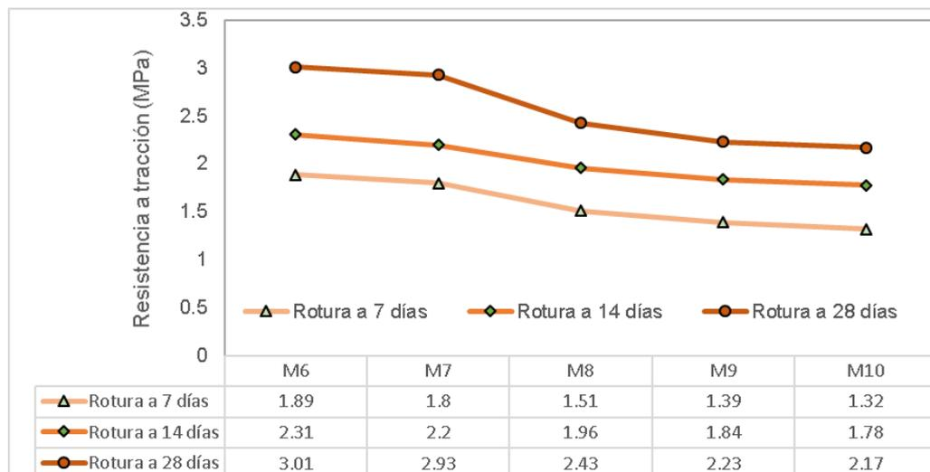
Figura 47. Resistencia a la tracción en concreto patrón 280 y concreto experimental.
