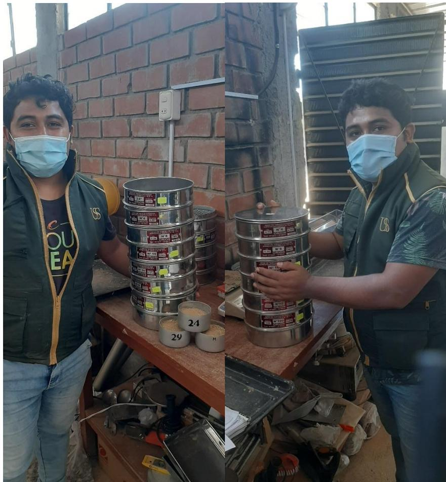
*Figura 14. Proceso de tamizaje para el agregado fino y grueso.*
