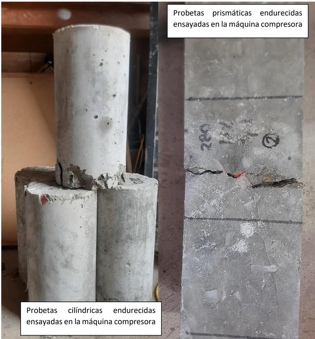
Probetas prismáticas endurecidas ensayadas en la máquina compresora
