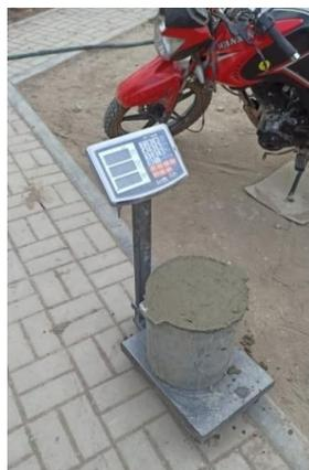
*Figura 23. Ensayo de peso unitario para el concreto patrón y dosificado con microporoso EVA.*
