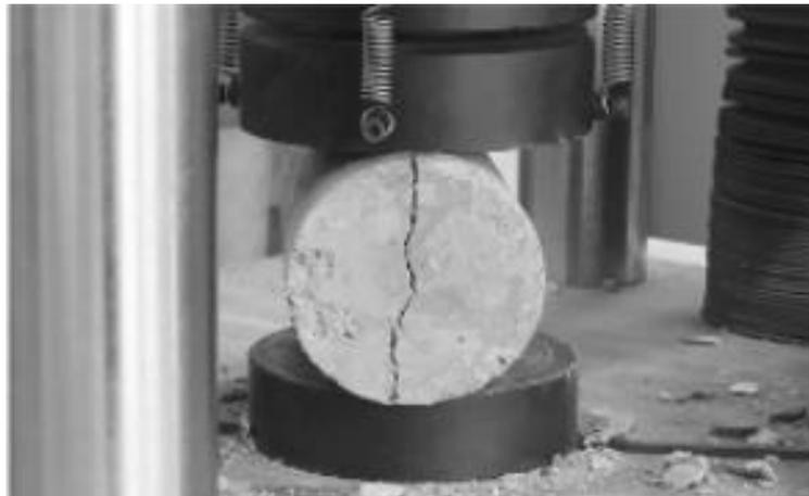
*Figura 7. Ensayo a la resistencia a la tracción del concreto.*
