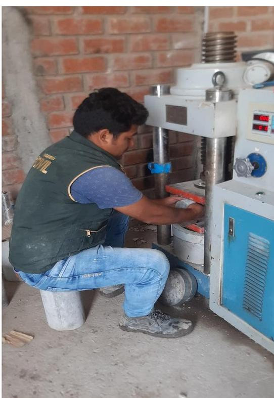
Ensayo de tracción en el concreto estado endurecido
