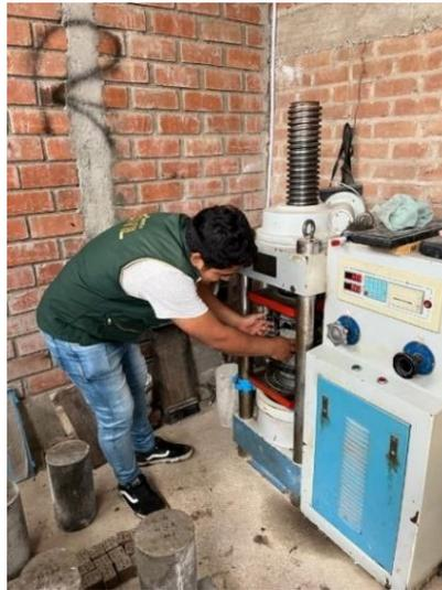
*Figura 27. Ensayo de módulo de elasticidad para el concreto patrón y dosificado con microporoso EVA.*
