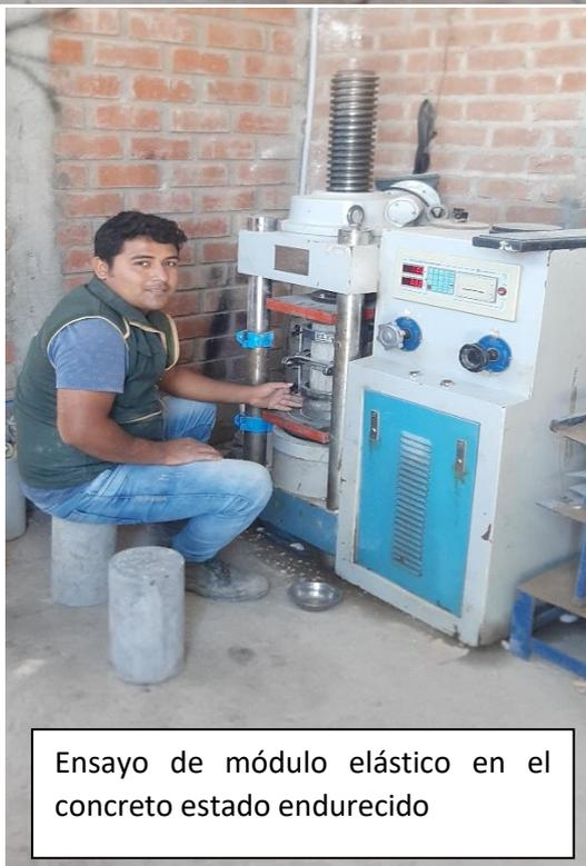
Ensayo de módulo elástico en el concreto estado endurecido
