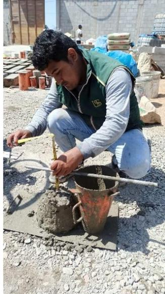
*Figura 20. Ensayo de Slump para el concreto patrón y dosificado con microporoso EVA.*
