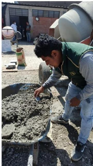
*Figura 21. Ensayo de temperatura en el estado fresco del concreto y dosificado con microporoso EVA.*
