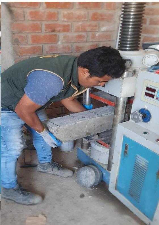
Ensayo de flexión en el concreto estado endurecido
