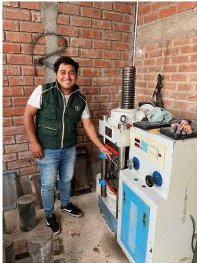
*Figura 24. Ensayo de compresión axial para el concreto patrón y dosificado con microporoso EVA.*
