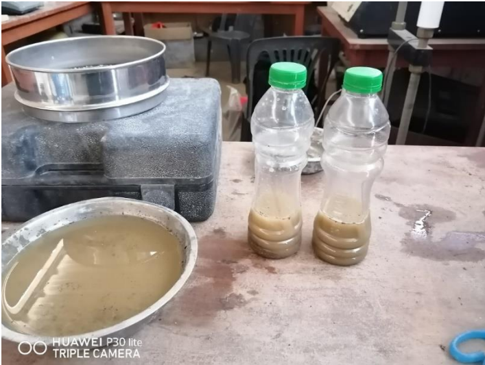
Figura 50 Ensayo de contenido de sales solubles
