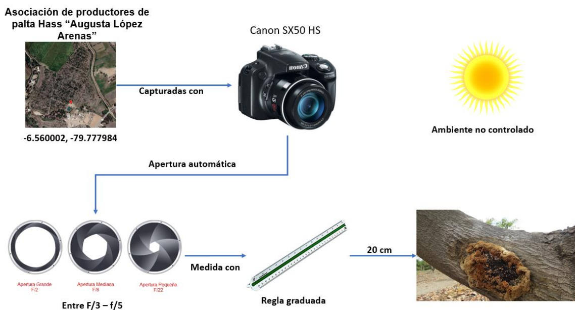
Figura 26. Protocolo de Adquisición de imágenes digitales en campo del tallo del palto.
