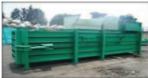
Figura 14: Compactadora de Chatarra Horizontal
