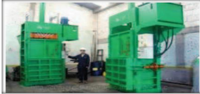
Figura 15: Compactadora de Chatarra Vertical
