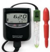
**pH metro:** Permite medir la acidez de los alimentos, para llegar a un buen punto de gelificación y garantizar la conservación del producto.
