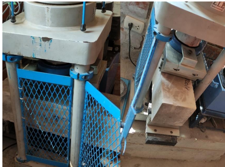
Figura 14. Ensayo de Flexión en Vigas de Concreto
