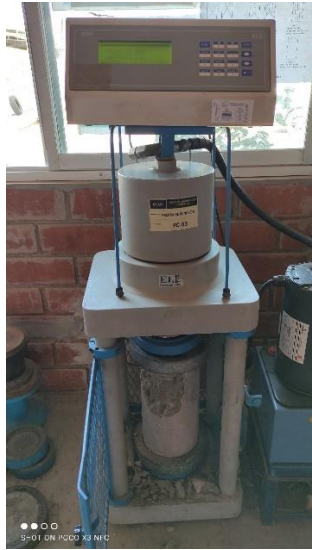
Figura 13. Ensayo de compresión en Probetas
