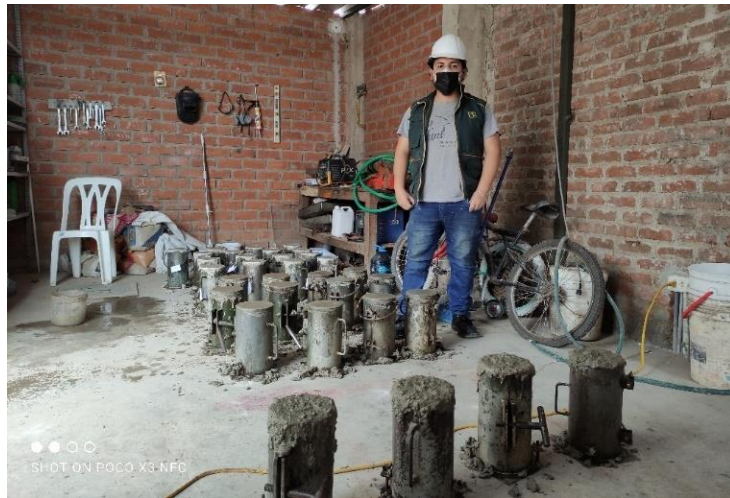
Figura 10. Elaboración de Probetas de concreto
