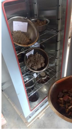
Figura 6. Agregados en el Horno para la obtención de contenido de Humedad
