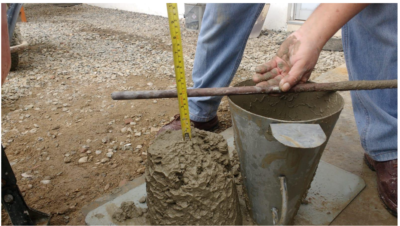
Figura 33 Ensayo de Slump
