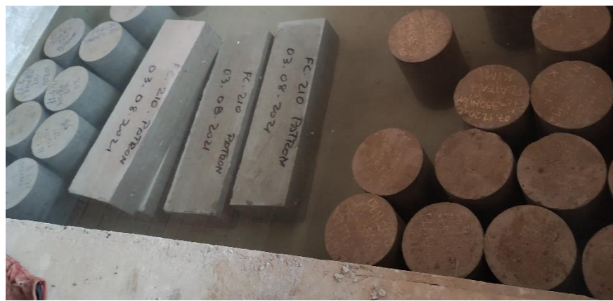
Figura 12. Curado de Probetas y Vigas en la Piscina del Laboratorio
