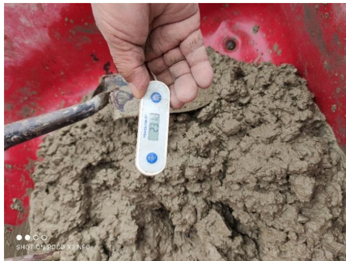
Figura 9. Obtención de temperatura con el termómetro digital
