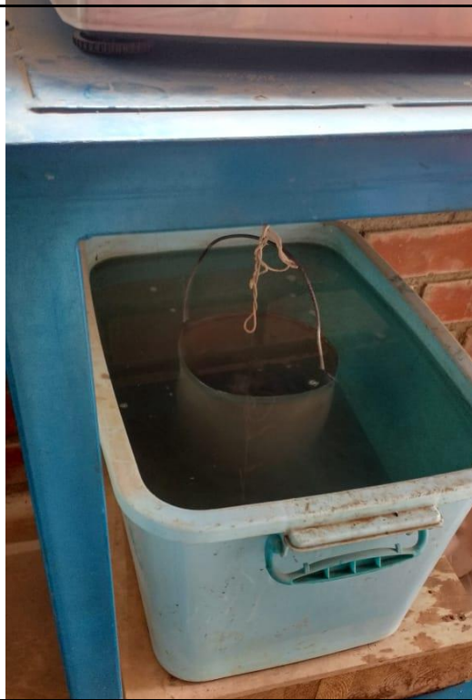
Figura 31 Peso Sumergido del agregado grueso
