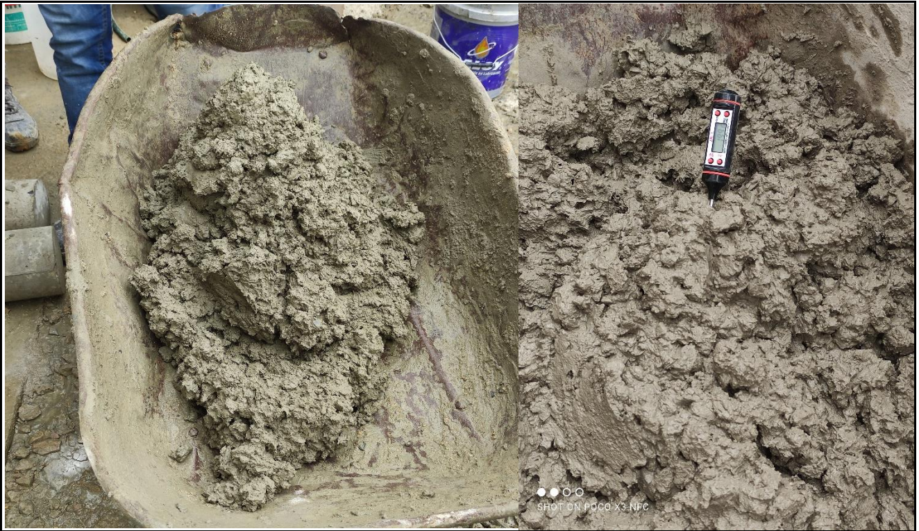
Figura 35 Obtención de temperatura del concreto
