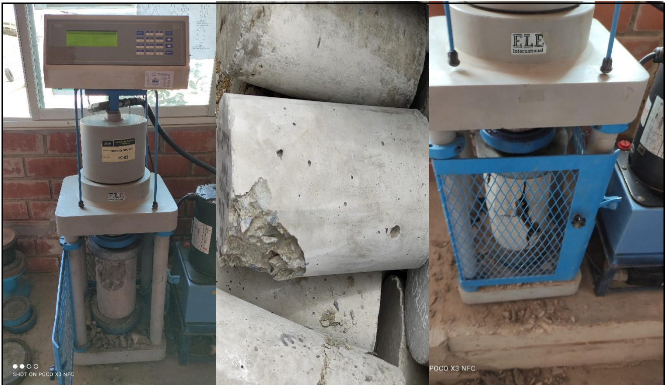
Figura 39 Ensayo de Resistencia a la compresión
