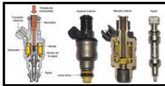
Figura 12. Estructura de un inyector
